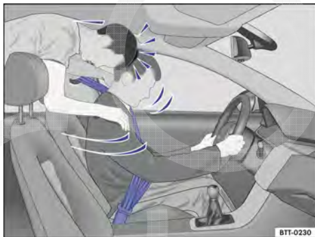
Fig. 53 O passageiro sem cinto de segurança no banco traseiro é lançado para frente sobre o condutor com cinto de segurança.
