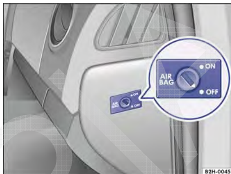
Fig. 67 Na parte frontal no lado do passageiro dianteiro: interruptor acionado pela chave para desativar e ativar o airbag frontal do passageiro dianteiro.
