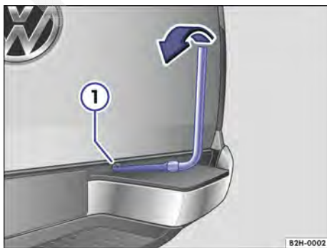
Fig. 177 Girar a roda sobressalente para baixo pelo guincho.
