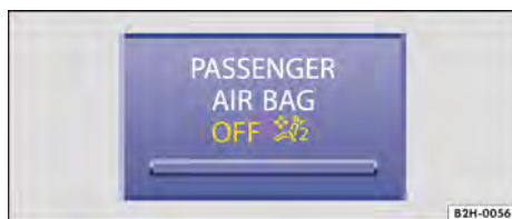
Fig. 64 Luz de controle no painel de instrumentos para o airbag frontal do passageiro dianteiro desativado.
