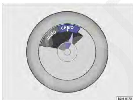
Fig. 167 Extintor de incêndio: detalhe da indicação de enchimento (manômetro).
