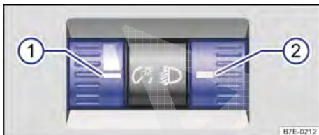
Fig. 79 Ao lado do volante: regulador da iluminação dos instrumentos e interruptores ① assim como regulagem de alcance do farol ②.
