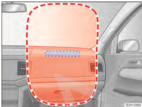
Fig. 66 Local de instalação e área de expansão do airbag frontal do passageiro dianteiro.
