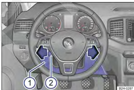
Fig. 190 Caixa de fusíveis atrás do revestimento do painel de instrumentos (veículos com volante à esquerda) ①.
