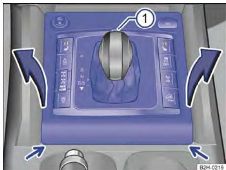
Fig. 171 Desmontar a cobertura do quadro da alavanca seletora.
