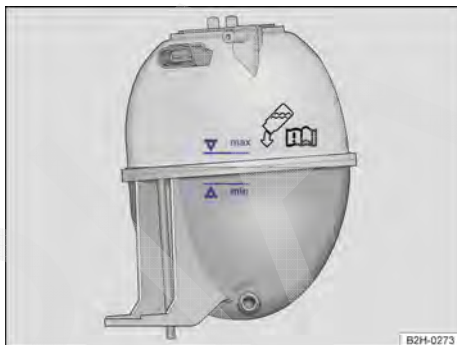
Fig. 150 No compartimento do motor: marcas no reservatório do líquido de arrefecimento do motor.
