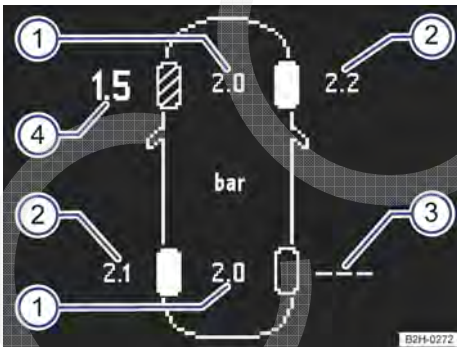
Fig. 156 Representação esquemática da exibição do display do instrumento combinado: pressões dos pneus atuais.
