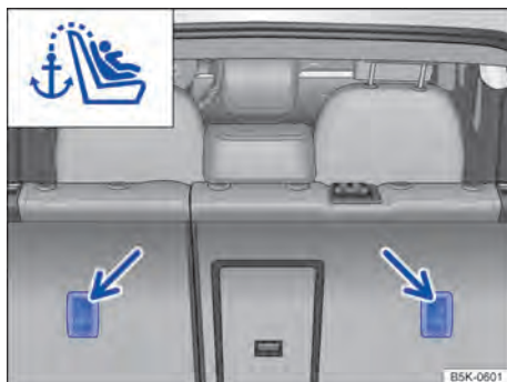
Fig. 7 Olhais de retenção para o cinto de fixação superior no lado de trás do banco traseiro.
