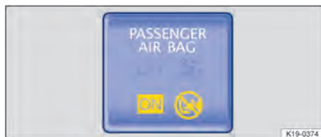
Fig. 35 No console central: luz de controle para airbag frontal do passageiro dianteiro ativado.
