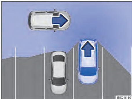
Fig. 132 Representação esquemática do assistente de saída de vaga: área monitorada ao redor do veículo.
