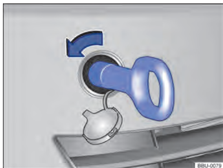
Fig. 164 No para-choque dianteiro à direita: rosquear a argola de reboque.
