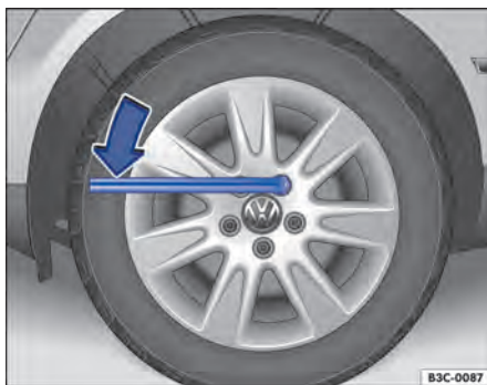
Fig. 189 Troca de roda: afrouxar os parafusos de roda.
