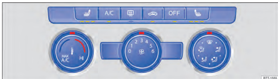
Fig. 95 Na parte superior do console central: painel de comando do ar-condicionado do ar-condicionado manual.
