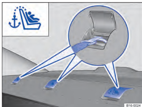
Fig. 49 Na superfície atrás do banco traseiro: olhalis de retenção para o cinto de fixação superior.
