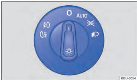
Fig. 85 Ao lado do volante: interruptor de luzes (uma variante).
