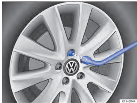
Fig. 200 Troca de roda: desaparafusar os parafusos de roda com a chave de roda.
