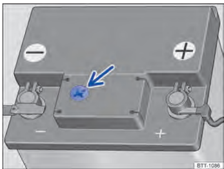
Fig. 179 Visor no lado superior da bateria do veículo 12 V (representação esquemática).
