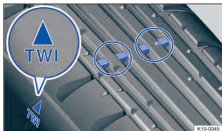
Fig. 183 Perfil do pneu: indicador de desgaste.
