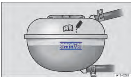
Fig. 175 No compartimento do motor: marcações no reservatório de expansão do líquido de arrefecimento (representação esquemática).
