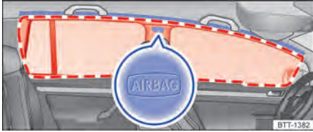
Fig. 41 No lado esquerdo do veículo: local de instalação e área de expansão do airbag para cabeça.
