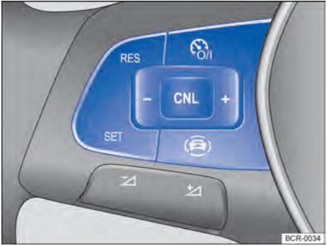
Fig. 115 Lado esquerdo do volante multifunções: botões para comandar o GRA.
