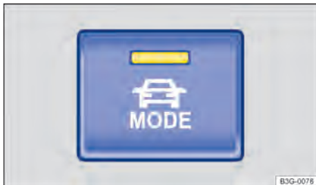
Fig. 112 No console central: botão MODE na seleção do perfil de condução.
