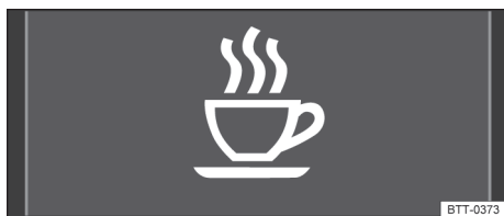
Fig. 17 No display do instrumento combinado: símbolo do sistema de reconhecimento de cansaço.
