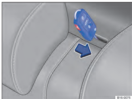
Fig. 67 Atrás do encosto do banco traseiro: destravar emergencialmente o encosto do banco traseiro.
