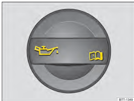
Fig. 174 No compartimento do motor: tampa da abertura para enchimento de óleo do motor (representação esquemática).
