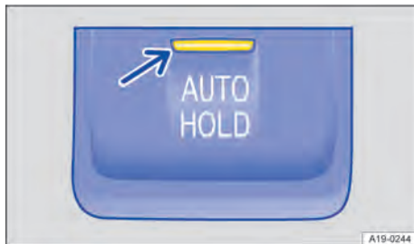
Fig. 128 No console central: botão do Auto Hold (representação esquemática).
