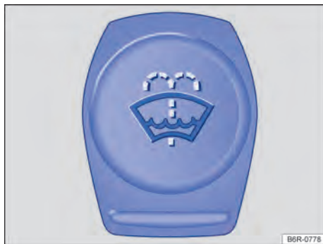
Fig. 172 No compartimento do motor: tampa do reservatório de água dos lavadores do para-brisa.
