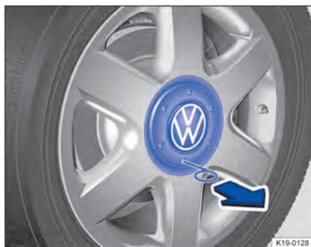
Fig. 185 Retirar a calota central.
