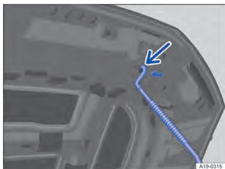
Fig. 170 Na tampa dianteira: alojamento para a haste de sustentação da tampa.
