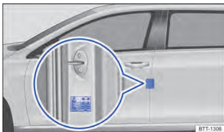
Fig. 182 Na coluna do condutor: etiqueta com as pressões dos pneus (alternativa ao lado interno da portinhola do tanque).
