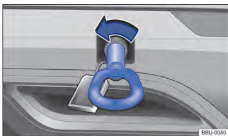
Fig. 166 No para-choque traseiro à direita: rosquear a argola de reboque.
