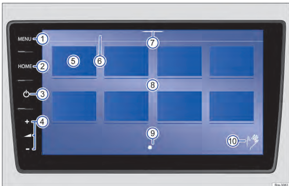
Fig. 141 Vista geral: unidade de exibição e operação na variante de 9,2 polegadas (9,2").
