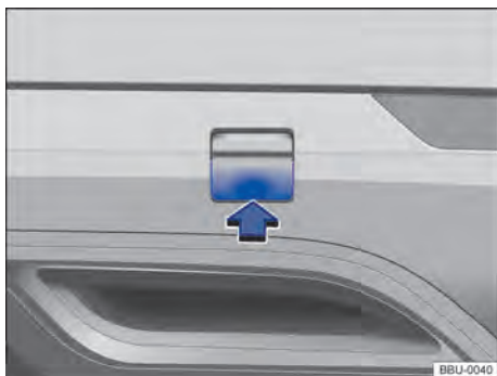
Fig. 165 No para-choque traseiro à direita: capa de cobertura para o alojamento da argola de reboque.
