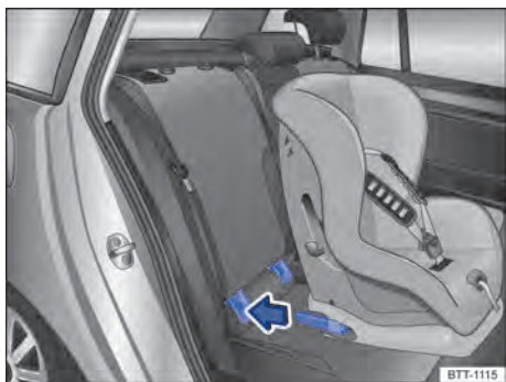
Fig. 48 Representação esquemática: instalar a cadeira de criança com braços de apoio.
