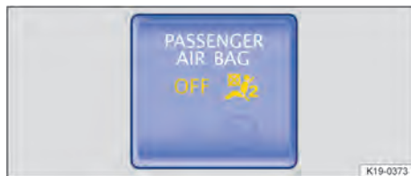
Fig. 34 No console central: luz de controle para o airbag frontal do passageiro dianteiro desligado.
