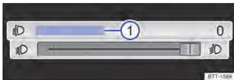
Fig. 88 No sistema Infotainment: regulador touch para regulagem do alcance do farol.
