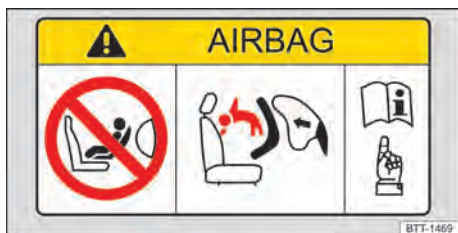
Fig. 43 Representação esquemática: etiqueta do air-bag no para-sol.
