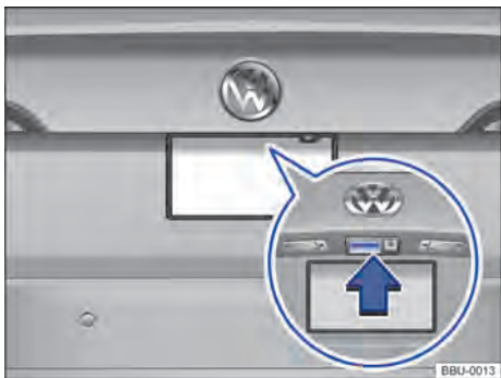
Fig. 66 Na tampa traseira: botão para abrir a tampa traseira.
