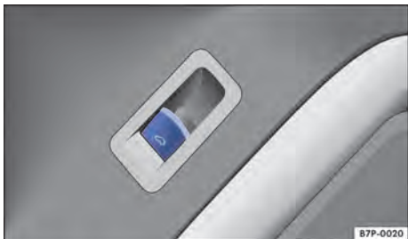
Fig. 65 Na porta do condutor: botão de destravamento da tampa traseira.
