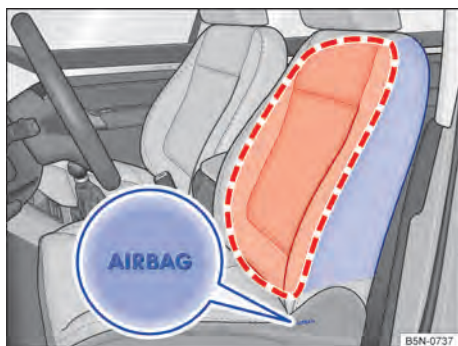
Fig. 40 Lateralmente no banco dianteiro: local de instalação e área de expansão dos airbags laterais.
