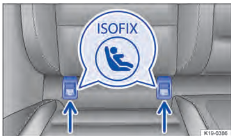
Fig. 46 Identificação dos pontos de ancoragem do ISO-FIX para cadeiras de criança.
