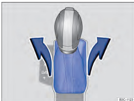
Fig. 110 Desinstalar a cobertura do quadro da alavanca seletora.
