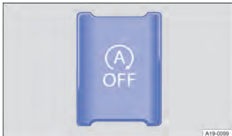
Fig. 105 Na parte inferior do console central: botão do sistema Start-Stop.
