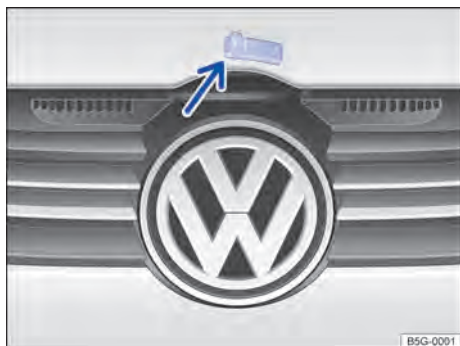
Fig. 168 Acima da grade do radiador: alavanca de acionamento para a tampa dianteira.
