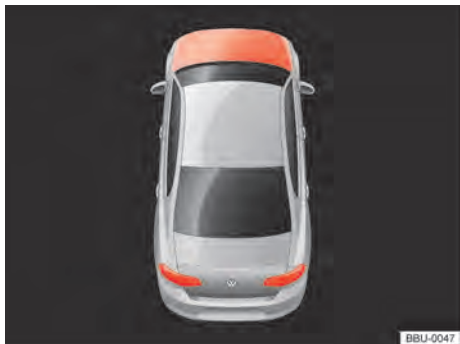
Fig. 171 No display do instrumento combinado: tampa dianteira aberta ou não fechada corretamente (representação esquemática).
