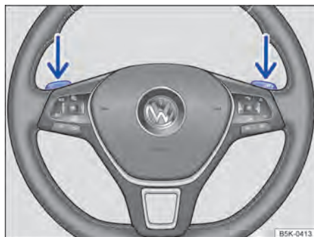
Fig. 109 Volante com seletores basculantes do Tiptronic.
