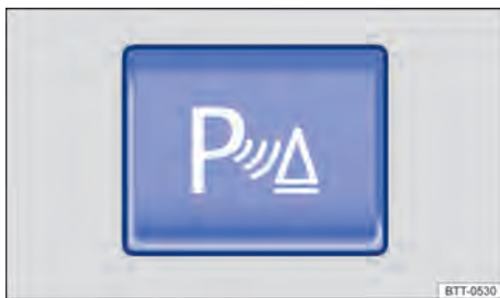
Fig. 130 No console central: botão para ligar ou desligar o auxílio de estacionamento (representação esquemática).
