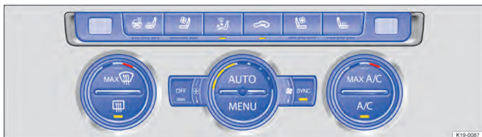
Fig. 96 Na parte superior do console central: painel de comando do ar-condicionado do Climatronic.
