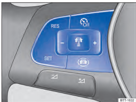
Fig. 123 Lado esquerdo do volante multifunções: botões para comandar o ACC.
