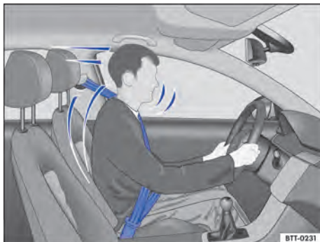
Fig. 28 Condutor protegido pelo cinto de segurança colocado corretamente numa manobra de frenagem súbita.
