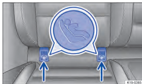
Fig. 45 Identificação dos pontos de ancoragem do ISOFIX para cadeiras de criança.
