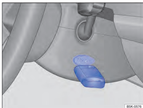
Fig. 104 À direita na coluna de direção: função de partida de emergência em veículos com sistema de travamento e de partida Keyless Access sem chave.
