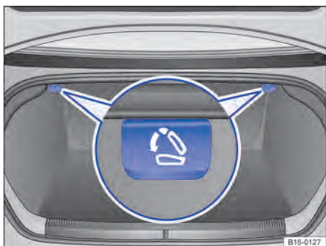
Fig. 75 No compartimento de bagagem: alavanca de destravamento.
