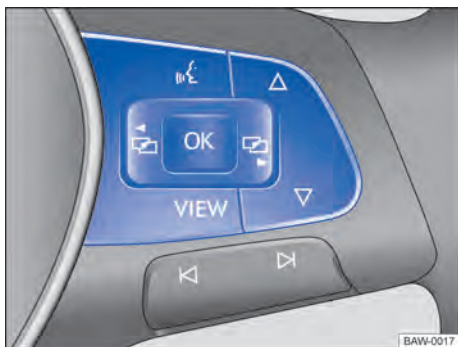
Fig. 18 Lado direito do volante multifunções: botões para comando dos menus e exibições de informação do instrumento combinado.
