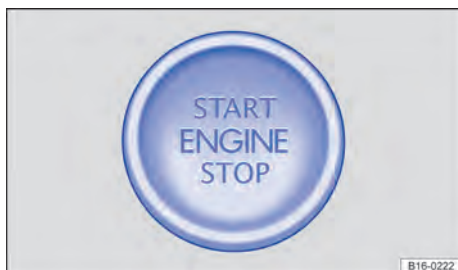
Fig. 103 Na parte inferior do console central: botão de partida para dar partida no motor.
