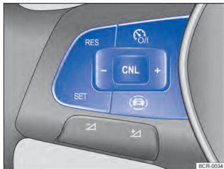
Fig. 117 Lado esquerdo do volante multifunções: botões para comandar o limitador de velocidade.
