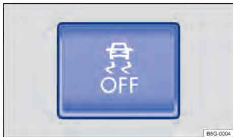
Fig. 134 No console central: botão para desligar e ligar manualmente o ASR, e o ESC Sport (dependendo da versão).
