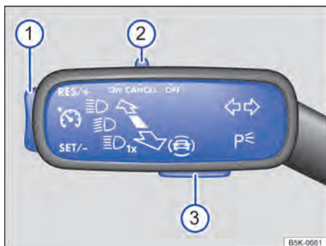
Fig. 116 À esquerda na coluna de direção: interruptores e botões para comandar o limitador de velocidade.
