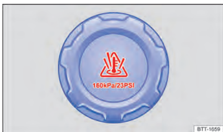
Fig. 176 No compartimento do motor: tampa do reservatório de expansão do líquido de arrefecimento (representação esquemática).
