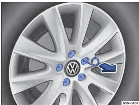
Fig. 188 Remover as capas de cobertura dos parafusos de roda.
