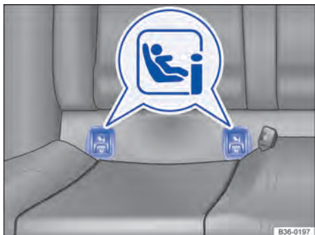
Fig. 47 Identificação dos pontos de ancoragem do i-Size para cadeiras de criança.
