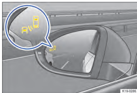
Fig. 126 No espelho retrovisor externo: exibição do sensor de ponto cego.
