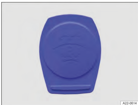
Fig. 174 No compartimento do motor: tampa do reservatório de água dos lavadores dos vidros (representação esquemática).
