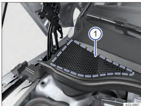
Fig. 205 Entre o compartimento do motor e o para-brisa: caixa de água (representação esquemática).
