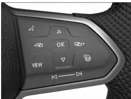
Fig. 14 Lado direito do volante multifunções: operar o instrumento combinado digital Basic (variante 2).
