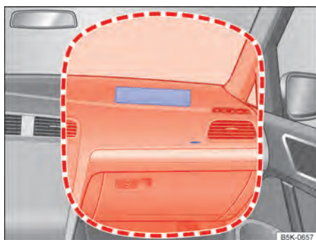
Fig. 32 No lado do passageiro dianteiro: local de instalação e área de expansão do airbag frontal do passageiro dianteiro.
