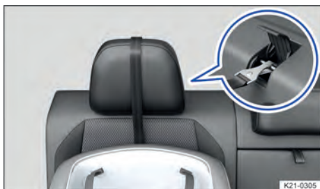
Fig. 44 No encosto do banco traseiro: posição do cinto de segurança no caso de apoios para cabeça não ajustáveis com cinto individual Top Tether.
