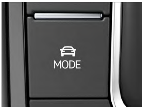
Fig. 107 No console central: botão MODE na seleção do perfil de condução.
