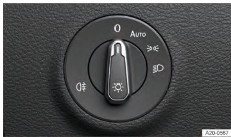
Fig. 82 Ao lado do volante: interruptor de luzes (uma variante).
