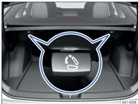
Fig. 70 No compartimento de bagagem: alavanca de destravamento.
