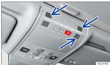
Fig. 60 No console do teto: sensores do monitoramento do interior do veículo (setas).
