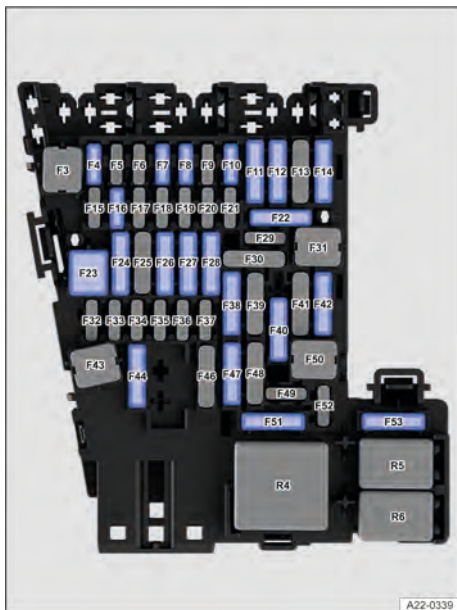
Fig. 157 No painel de instrumentos: disposição dos fusíveis.
