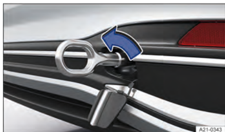
Fig. 167 No para-choque traseiro à direita: rosquear a argola de reboque.
