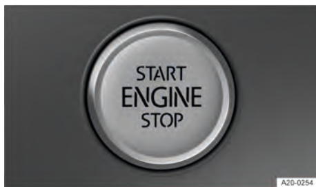
Fig. 98 Na parte inferior do console central: botão de partida.
