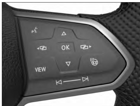
Fig. 11 Lado direito do volante multifunções: operar o instrumento combinado digital Pro (variante 2).
