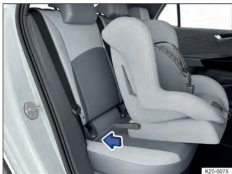
Fig. 42 Instalar a cadeira de criança com braços de apoio (representação esquemática).
