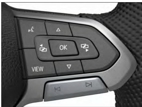
Fig. 13 Lado direito do volante multifunções: operar o instrumento combinado digital Basic (variante 1).
