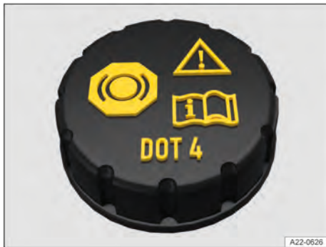
Fig. 181 No compartimento do motor: tampa do reservatório do fluido de freio.
