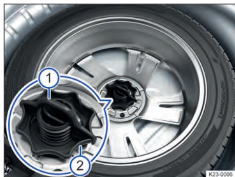
Fig. 190 Sob o assoalho do compartimento de bagagem: manípulo de fixação da roda sobressalente.
