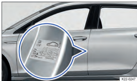
Fig. 184 Na coluna do condutor: etiqueta com as pressões dos pneus (alternativa ao lado interno da portinhola do tanque).
