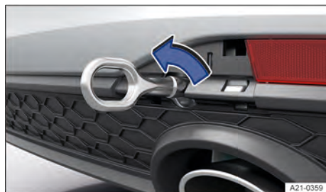
Fig. 169 No para-choque traseiro à direita: rosquear a argola de reboque.
