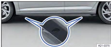
Fig. 196 Na longarina lateral: marcações dos pontos de apoio do macaco (variante 2).
