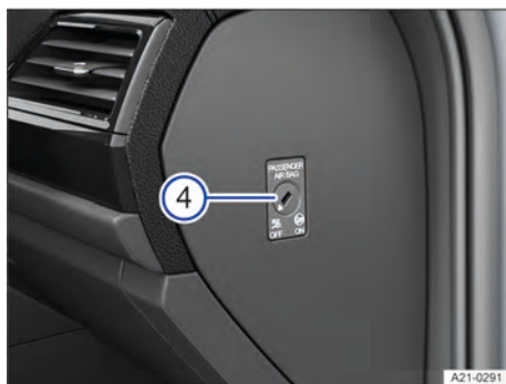
Fig. 8 Com a porta do passageiro aberta (veículo com direção à esquerda): interruptor de chave no painel de instrumentos (em veículos com direção à direita, a disposição dos elementos é espelhada).
