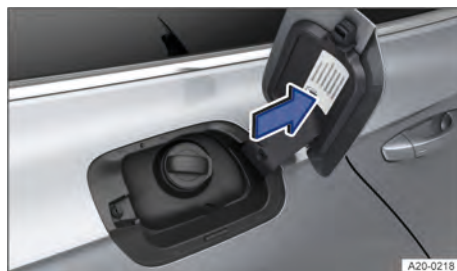
Fig. 144 No lado interno da portinhola do tanque: placa de indicação de combustível (representação esquemática).
