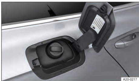
Fig. 148 Atrás da portinhola do tanque: tampa do tanque (representação esquemática).
