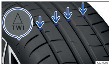
Fig. 188 Nos sulcos do perfil: indicador de desgaste.
