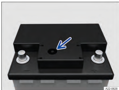
Fig. 182 No lado superior da bateria do veículo 12 V: visor de inspeção da bateria (representação esquemática).
