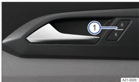
Fig. 56 Na porta do condutor: botão do travamento central (representação esquemática).
