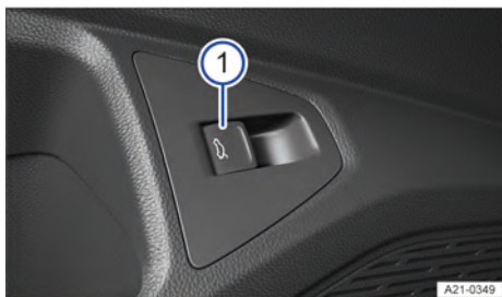
Fig. 61 Na porta do condutor: botão de destravamento da tampa traseira.
