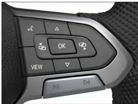
Fig. 10 Lado direito do volante multifunções: operar o instrumento combinado digital Pro (variante 1).
