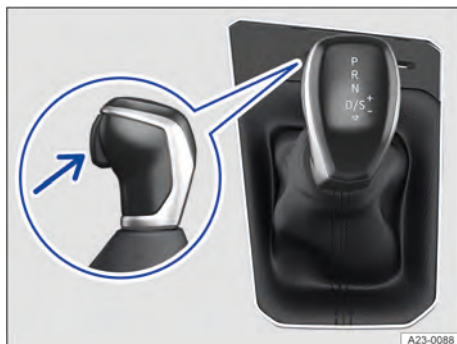
Fig. 102 No console central: alavanca seletora da transmissão automática (representação esquemática).
