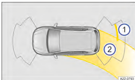
Fig. 128 Sistema Infotainment: exibição do auxílio de estacionamento (representação esquemática)
