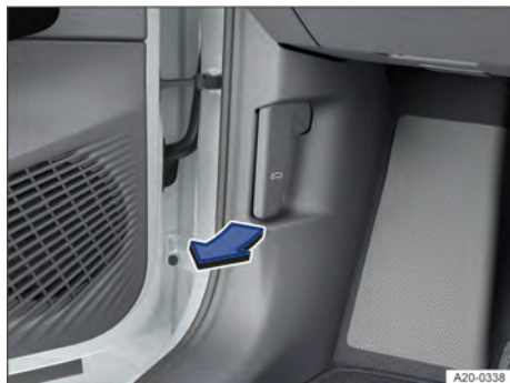
Fig. 170 Na área para os pés no lado do condutor: alavanca de destravamento da tampa dianteira (representação esquemática).
