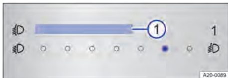
Fig. 86 No sistema Infotainment: regulador touch para regulagem do alcance do farol.
