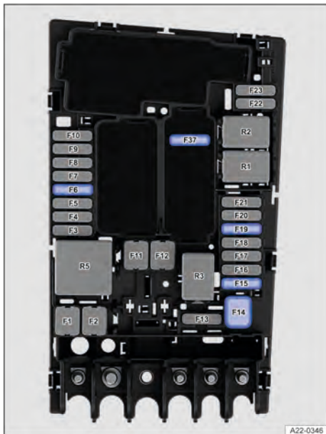
Fig. 155 No compartimento do motor: locais de instalação dos fusíveis.
