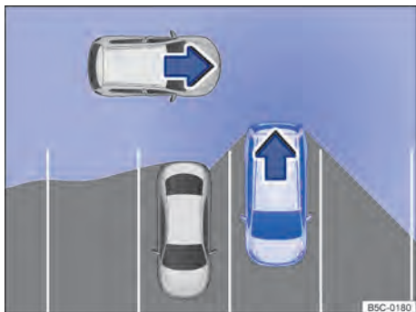
Fig. 131 Área monitorada ao redor do veículo que irá sair da vaga de estacionamento (representação esquemática).
