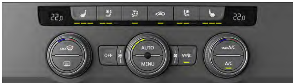
Fig. 93 Na parte superior do console central: painel de comando do ar-condicionado do Climatronic.
