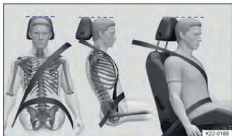
Fig. 28 Posição correta do cadarço do cinto de segurança e ajuste correto do apoio para cabeça (representação esquemática).
