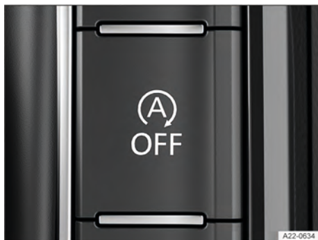
Fig. 100 Na parte inferior do console central ou, dependendo da versão, no sistema Infotainment: botão do sistema Start-Stop.
