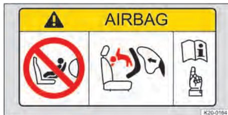
Fig. 40 No para-sol: etiqueta do airbag (representação esquemática).
