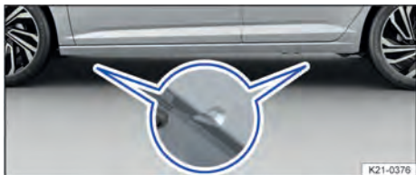
Fig. 195 Na longarina lateral: marcações dos pontos de apoio do macaco (variante 1).
