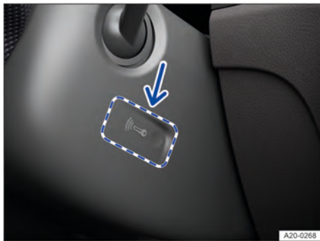
Fig. 99 À direita na coluna de direção: função de partida de emergência em veículos com sistema de travamento e de partida Keyless Access sem chave.
