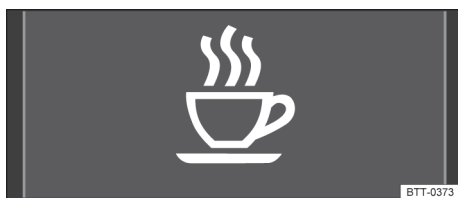
Fig. 23 No display do instrumento combinado: símbolo do sistema de reconhecimento de cansaço.
