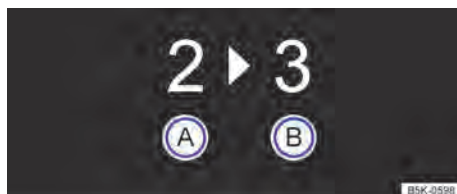
Fig. 109 No display do instrumento combinado: recomendação de marcha.
