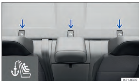
Fig. 43 No porta-objetos atrás do banco traseiro: pontos de ancoragem Top Tether do cinto de segurança Top Tether.
