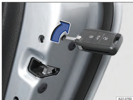
Fig. 58 Na parte dianteira da porta traseira direita: travamento de emergência do veículo com a chave do veículo (representação esquemática).
