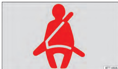
Fig. 25 No display do instrumento combinado: luz de advertência da solicitação para colocar o cinto de segurança.
