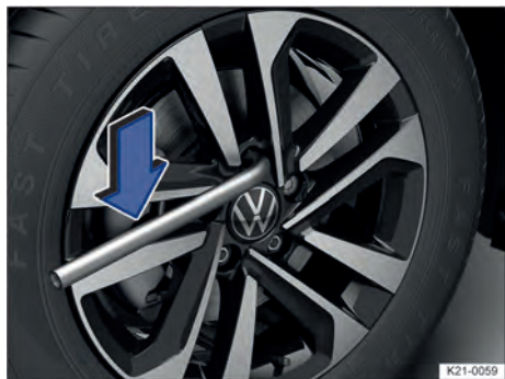
Fig. 201 Remover os parafusos de roda com a chave da roda.
