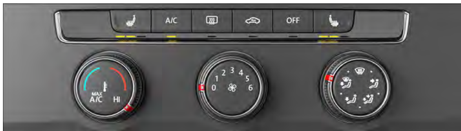
Fig. 94 Na parte superior do console central: painel de comando do ar-condicionado do ar-condicionado manual.
