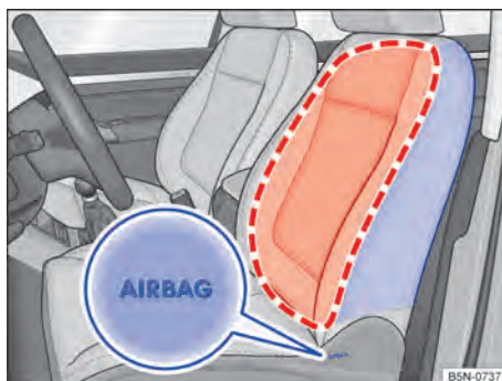
Fig. 36 Lateralmente em ambos os bancos dianteiros: local de instalação e área de expansão do airbag lateral.
