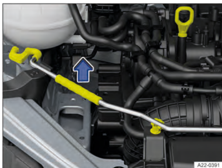
Fig. 172 No compartimento do motor: haste de sustentação da tampa no suporte.
