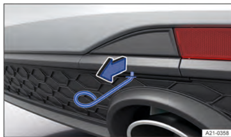
Fig. 168 No para-choque traseiro à direita: remover cobertura.
