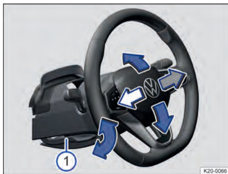
Fig. 65 Embaixo do volante no revestimento da coluna de direção: alavanca de ajuste mecânico da posição do volante (representação esquemática).
