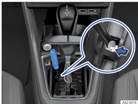
Fig. 105 No console central: destravar emergencialmente o bloqueio da alavanca seletora (variante 1).
