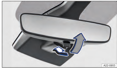
Fig. 90 No para-brisa: espelho retrovisor interno com antiofuscante manual.
