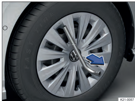
Fig. 192 Retirar a calota integral.
