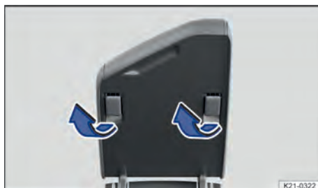
Fig. 77 Parte inferior do descanso-braço central dianteiro: apoio de plástico do descanso-braço central.
