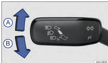
Fig. 81 À esquerda na coluna de direção: alavanca dos indicadores de direção e do farol alto.
