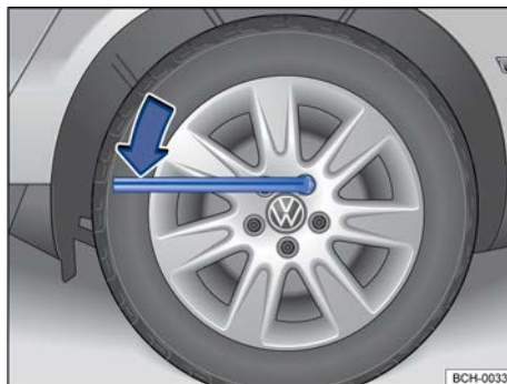
Fig. 194 Troca de roda: soltar os parafusos da roda.
