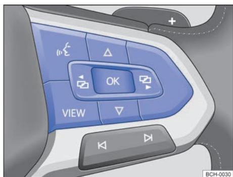
Fig. 17 Lado direito do volante multifunções (variante 2): botões para comando dos menus e exibições de informação do instrumento combinado.
