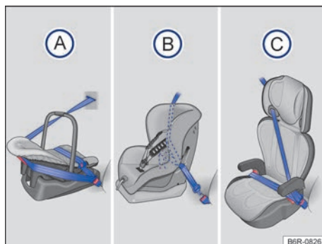
Fig. 39 As ilustrações A , B e C mostram a fixação do sistema de retenção para crianças apenas com o cinto de segurança do veículo.
