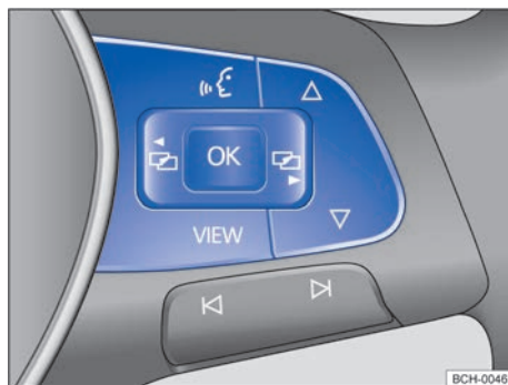
Fig. 16 Lado direito do volante multifunções (variante 1): botões para comando dos menus e exibições de informação do instrumento combinado.
