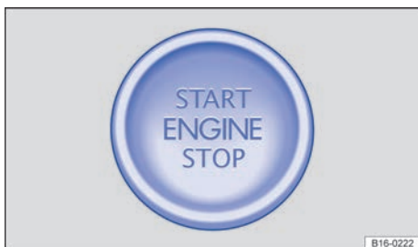
Fig. 86 Na parte inferior do console central: botão de partida para ligar o motor.
