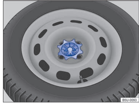
Fig. 192 No compartimento de bagagem: manípulo para fixação da roda de emergência.
