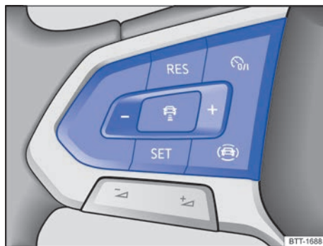
Fig. 100 Lado esquerdo do volante multifunções: botões para comandar o ACC.
