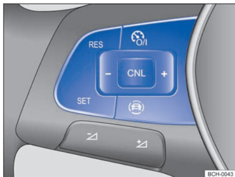
Fig. 95 Lado esquerdo do volante multifunções (variante 1): botões para comandar o limitador de velocidade.
