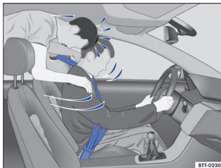
◀ Fig. 25 O passageiro sem cinto de segurança no banco traseiro é lançado para frente sobre o condutor com cinto de segurança.
