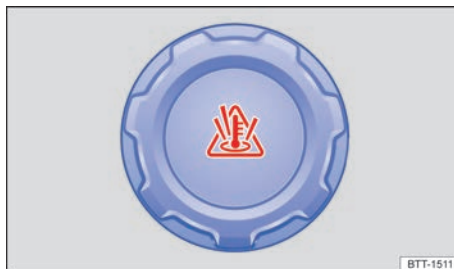
Fig. 184 No compartimento do motor: tampa do reservatório de expansão do líquido de arrefecimento do motor.
