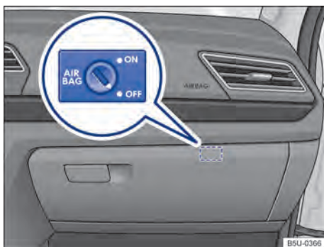
Fig. 36 No porta-luvas: interruptor desacionado pela chave para desligar e ligar o airbag frontal do passageiro.
