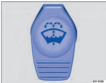
Fig. 201 No compartimento do motor: tampa do reservatório de água dos lavadores do para-brisa.
