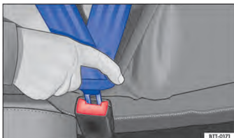
Fig. 28 Introduzir a lingueta do cinto de segurança no fecho do cinto de segurança.
