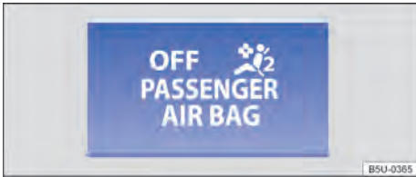
Fig. 33 Luz de controle no painel de instrumentos para o airbag frontal do passageiro desligado.
