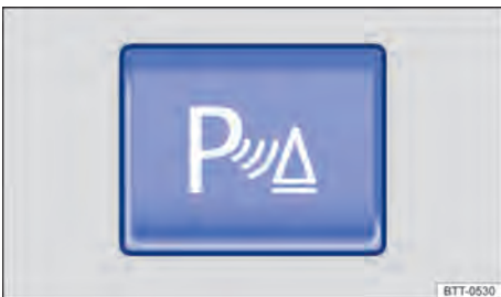
Fig. 94 Na parte superior do console central: botão para ligar e desligar o controle de distância de estacionamento (Park Pilot).
