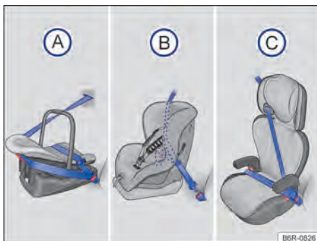
Fig. 37 As ilustrações (A), (B) e (C) mostram a fixação do sistema de retenção para crianças apenas com o cinto de segurança do veículo.
