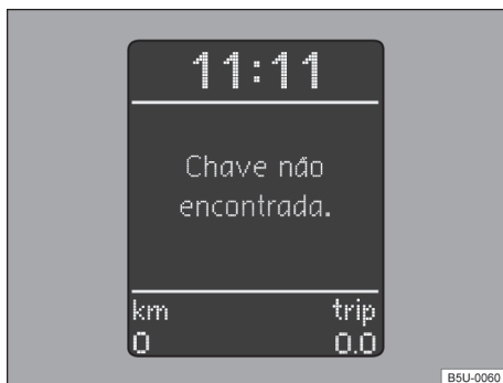
Fig. 87 No instrumento combinado: display com indicação do imobilizador ativado - veículos com Sistema de Informações Volkswagen.
