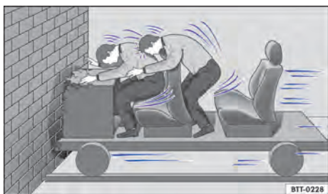
Fig. 24 Um veículo com os ocupantes do veículo sem cintos de segurança colide com o muro.
