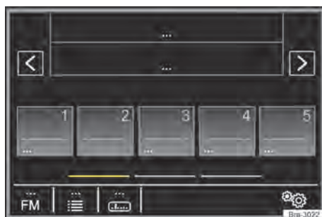
Fig. 135 Operação do rádio: busca automática em andamento (SCAN).
