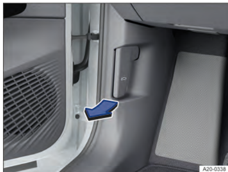
Fig. 169 Na área para os pés no lado do condutor: alavanca de destravamento da tampa dianteira (representação esquemática).
