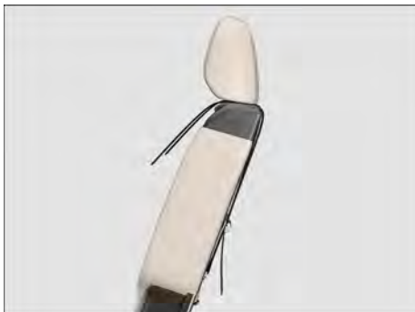
Fig. 41 No lado de trás dos assentos externos do banco traseiro: cinto de segurança Top Tether enganchado.
