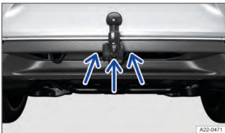
Fig. 141 No dispositivo de reboque: olhal para fixação do cabo de segurança ou de ruptura (representação esquemática).
