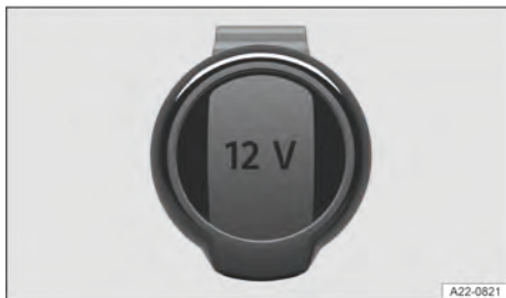
Fig. 131 No porta-objetos dianteiro ou no compartimento de bagagem do lado esquerdo: tomada 12 V articulada (representação esquemática).
