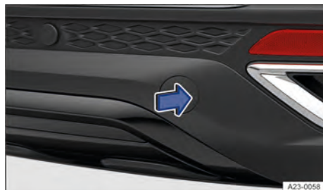
Fig. 167 No para-choque traseiro à direita: remover cobertura.
