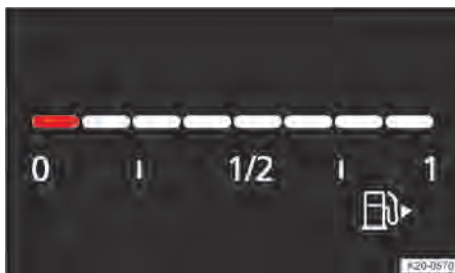
Fig. 16 No instrumento combinado digital Basic: indicador do nível de combustível (representação esquemática).
