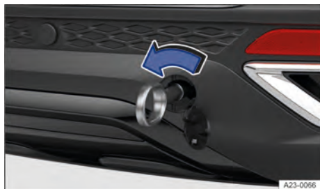
Fig. 168 No para-choque traseiro à direita: rosquear a argola de reboque.
