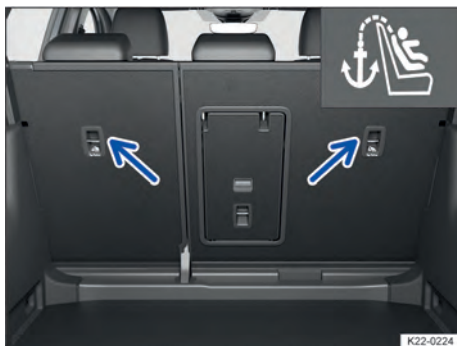
Fig. 40 No lado de trás do banco traseiro: pontos de ancoragem Top Tether do cinto de segurança Top Tether.
