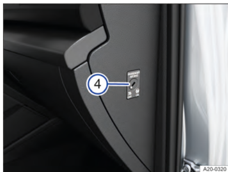
Fig. 8 Com a porta do passageiro dianteiro aberta: interruptor acionado pela chave no painel de instrumentos.
