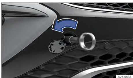
Fig. 166 No para-choque dianteiro à direita: rosquear a argola de reboque.
