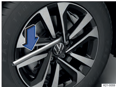
Fig. 194 Soltar os parafusos de roda.
