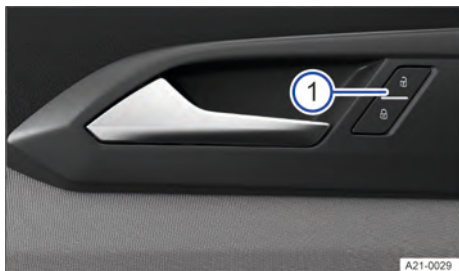
Fig. 50 Na porta do condutor: botão do travamento central (representação esquemática).
