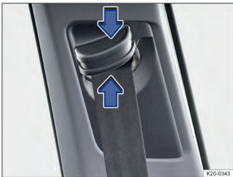
Fig. 27 Ao lado dos bancos dianteiros: regulagem de altura do cinto de segurança.
