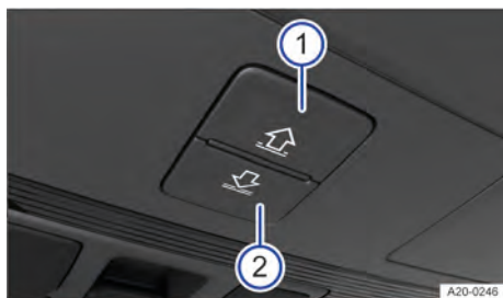
Fig. 86 No revestimento do teto: botões de comando da cortina de proteção solar.
