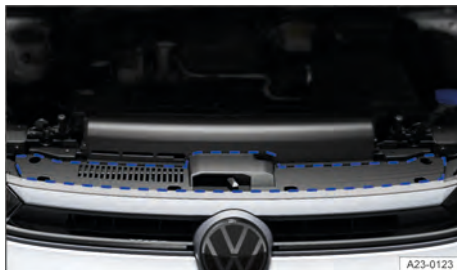
Fig. 174 Na área marcada: lugar da etiqueta adesiva da norma de óleo do motor e viscosidade do óleo do motor (representação esquemática).
