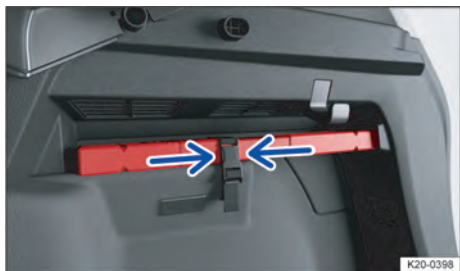
Fig. 42 No compartimento de bagagem do lado direito: suporte do triângulo de segurança.
