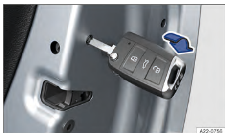
Fig. 52 Na parte dianteira de uma porta: travamento de emergência do veículo com a haste da chave ou a chave de emergência (variante 1).
