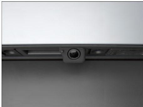
Fig. 203 Na traseira do veículo: câmera de marcha à ré no botão da alça (representação esquemática).
