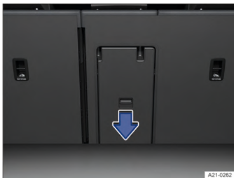
Fig. 140 No compartimento de bagagem: lado de trás do dispositivo para transporte de objetos longos (representação esquemática).
