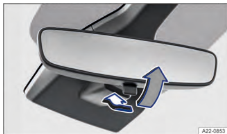
Fig. 83 No para-brisa: espelho retrovisor interno com antiofuscente manual.
