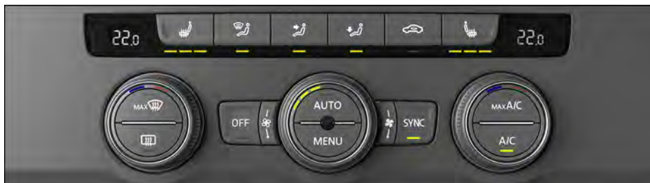
Fig. 88 Na parte superior do console central: painel de comando do ar-condicionado do Climatronic (variante 2).
