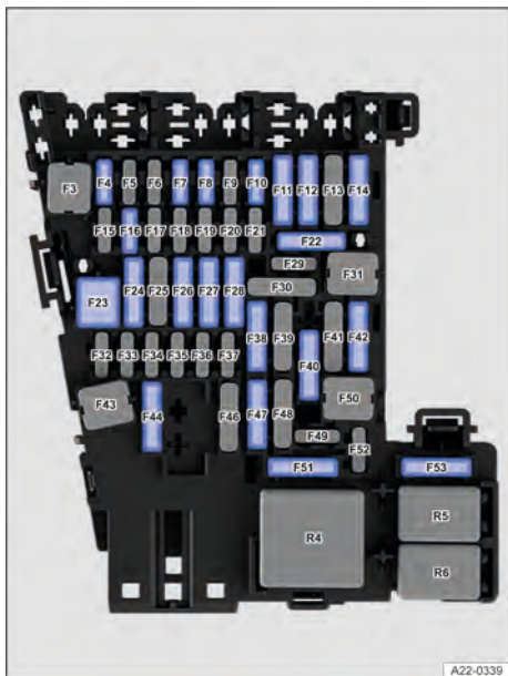
Fig. 160 No painel de instrumentos: disposição dos fusíveis.
