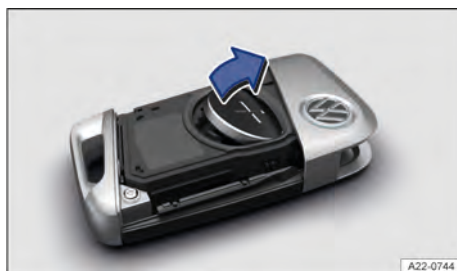
Fig. 47 Chave do veículo: trocar a pilha-botão.
