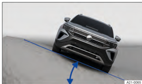
Fig. 100 Representação esquemática: ângulo de inclinação lateral.
