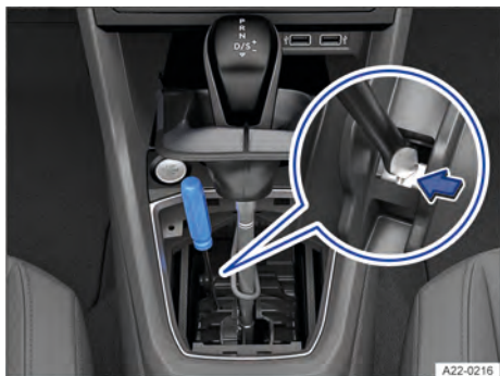
Fig. 96 No console central: destravar emergencialmente o bloqueio da alavanca seletora (variante 1).
