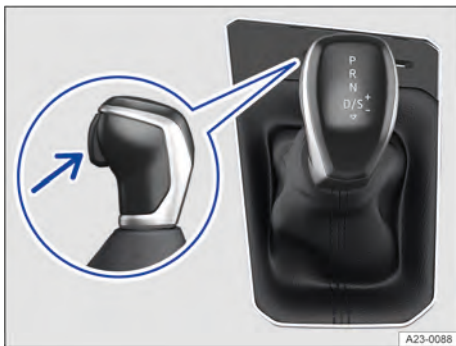
Fig. 93 No console central: alavanca seletora da transmissão automática (representação esquemática).
