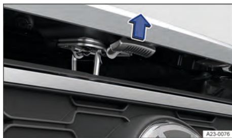
Fig. 170 Acima da grade do radiador: alavanca de comando da tampa dianteira (representação esquemática).
