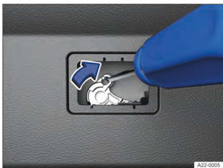
Fig. 58 No compartimento de bagagem: destravamento de emergência para a tampa traseira.
