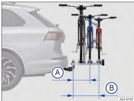
Fig. 144 Representação esquemática da largura máxima de um suporte de bicicletas para duas ou três bicicletas.
