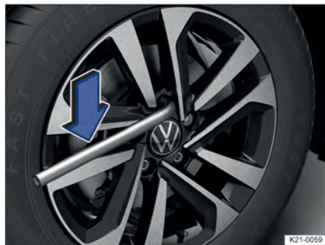
Fig. 198 Remover os parafusos de roda com a chave da roda.
