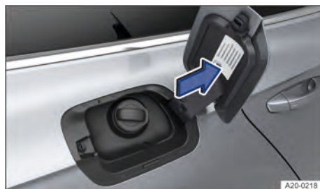
Fig. 145 No lado interno da portinhola do tanque: placa de indicação de combustível (representação esquemática).
