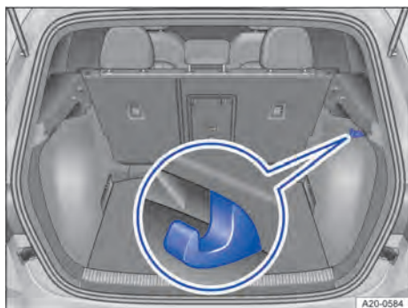
Fig. 138 No compartimento de bagagem à esquerda e à direita: ganchos para sacolas.
