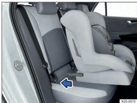
Fig. 39 Instalar a cadeira de criança com braços de apoio (representação esquemática).
