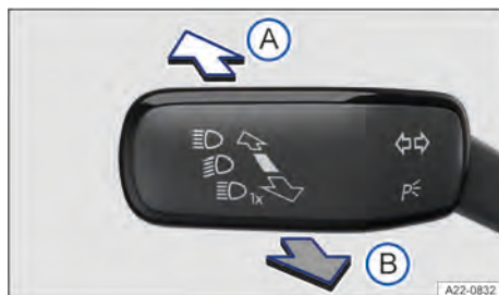
Fig. 76 À esquerda na coluna de direção: alavanca dos indicadores de direção e do farol alto.
