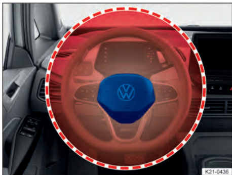
Fig. 28 No lado do condutor: local de instalação e área de expansão do airbag frontal do condutor.
