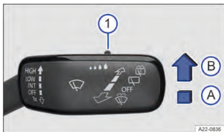
Fig. 81 À direita da coluna de direção: alavanca dos limpadores dos vidros.
