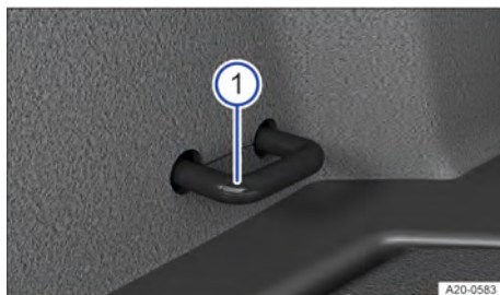
Fig. 137 No compartimento de bagagem: olhal de amarração (representação esquemática).
