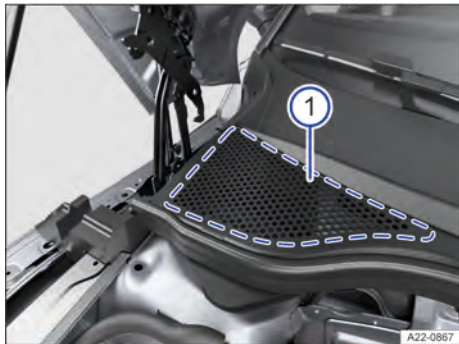
Fig. 202 Entre o compartimento dianteiro e o para-brisa: caixa coletora de água (representação esquemática).
