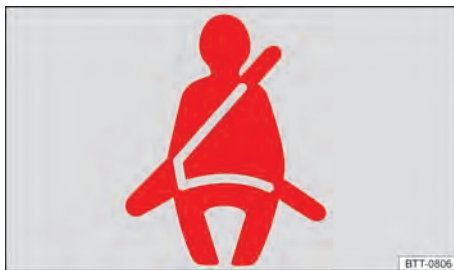
Fig. 22 No display do instrumento combinado: luz de advertência da solicitação para colocar o cinto de segurança.
