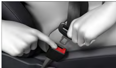
Fig. 37 Solta a lingueta do cinto de segurança do fecho do cinto de segurança (representação esquemática).
