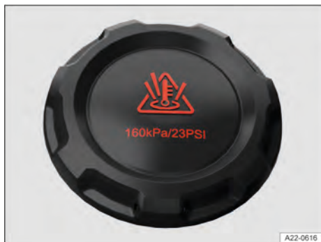
Fig. 259 No compartimento do motor: tampa do reservatório de expansão do líquido de arrefecimento (representação esquemática).
