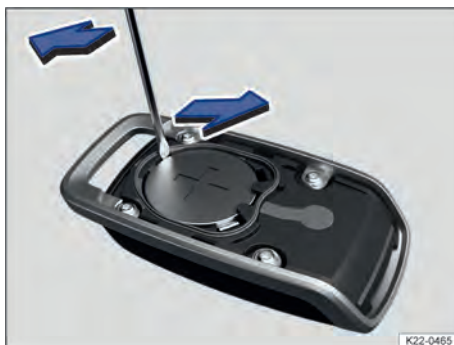
Fig. 135 Substituir a pilha-botão do controle remoto.
