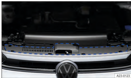
Fig. 255 Na área marcada: lugar da etiqueta adesiva da norma de óleo do motor e viscosidade do óleo do motor (representação esquemática).
