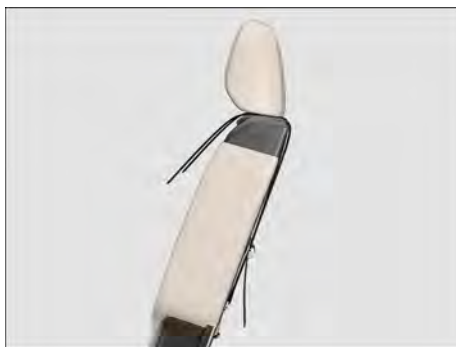
Fig. 57 No lado de trás do banco traseiro: cinto de segurança Top Tether enganchado.
