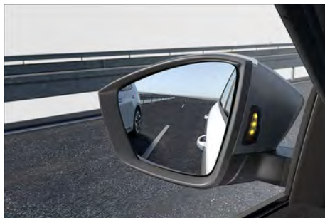
Fig. 173 Nas carcaças dos espelhos retrovisores externos: indicador do Side Assist.
