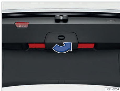
Fig. 58 Na tampa traseira: suporte para o triângulo de segurança.
