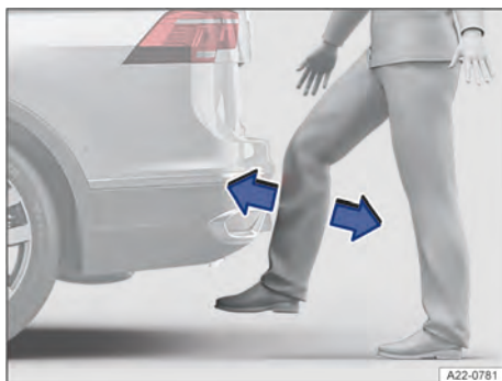
Fig. 80 Representação esquemática da tampa traseira com abertura controlada por sensor (Easy Open).
