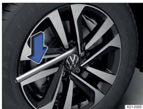
Fig. 279 Remover os parafusos de roda com a chave da roda.
