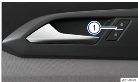
Fig. 70 Na porta do condutor: botão do travamento central (representação esquemática).
