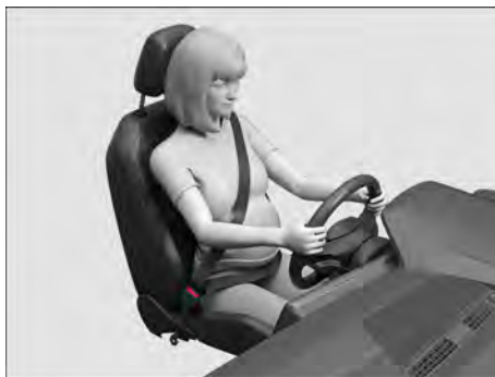
Fig. 39 Posição correta do cadarço do cinto de segurança para mulheres grávidas (representação esquemática).
