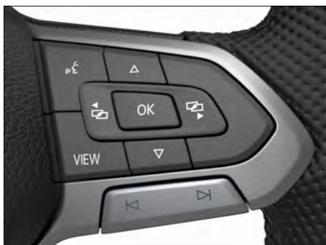
Fig. 11 Lado direito do volante multifunções: operar o instrumento combinado digital Pro (variante 1).
