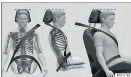
Fig. 38 Posição correta do cadarço do cinto de segurança e ajuste correto do apoio para cabeça (representação esquemática).
