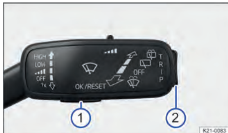
Fig. 13 Na coluna de direção direita: botões da alavanca dos limpadores dos vidros.
