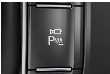
Fig. 181 No console central: botão para ligar e desligar a câmera do ambiente "Area View".
