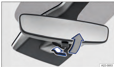
Fig. 125 No para-brisa: espelho retrovisor interno com antiofuscante manual.
