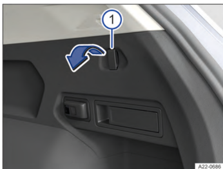
Fig. 213 No compartimento de bagagem: ganchos para sacolas.
