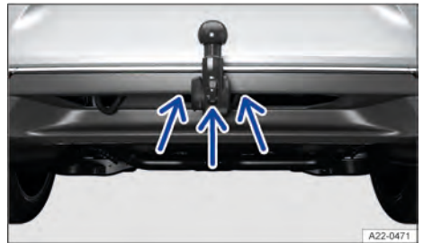
Fig. 216 No dispositivo de reboque: olhal para fixação do cabo de segurança ou de ruptura (representação esquemática).
