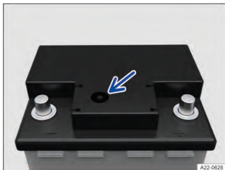
Fig. 262 No lado superior da bateria do veículo 12 V: visor de inspeção da bateria (representação esquemática).
