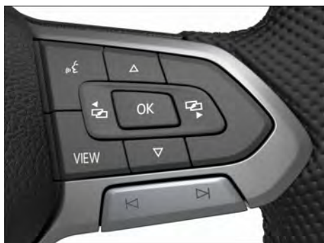
Fig. 19 Lado direito do volante multifunções: operar o instrumento combinado analógico (variante 1).
