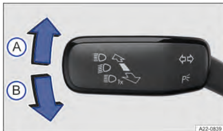
Fig. 113 À esquerda na coluna de direção: alavanca dos indicadores de direção e do farol alto.
