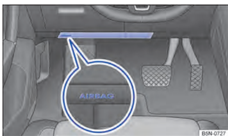
Fig. 50 No lado do condutor: local de instalação do airbag para joelhos (conforme a versão).
