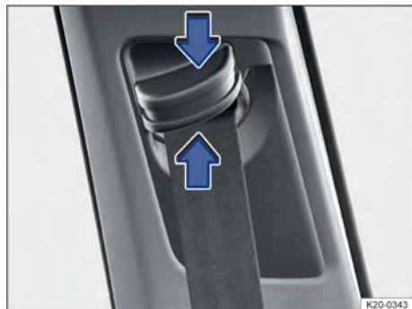
Fig. 40 Ao lado dos bancos dianteiros: regulagem de altura do cinto de segurança.
