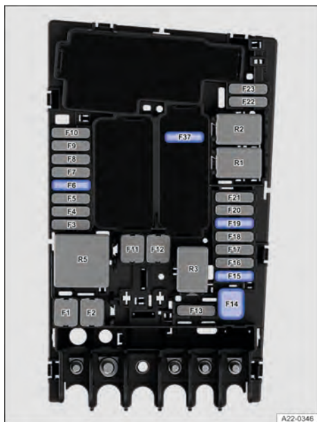
Fig. 238 No compartimento do motor: locais de instalação dos fusíveis.
