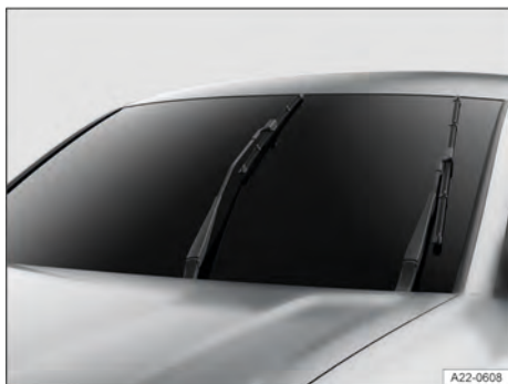
Fig. 233 Limpadores dos vidros na posição de serviço (representação esquemática).
