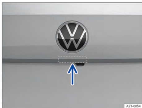
Fig. 76 Na tampa traseira: botão para abrir a tampa traseira (representação esquemática).
