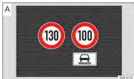
Fig. 31 No display do instrumento combinado: exibições do sistema de reconhecimento da sinalização de trânsito (representação esquemática).
