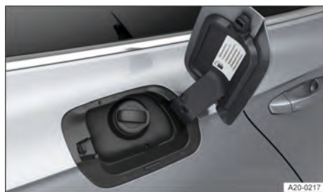
Fig. 227 Atrás da portinhola do tanque: tampa do tanque (representação esquemática).
