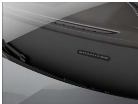
Fig. 326 No para-brisa: número de identificação do veículo.
