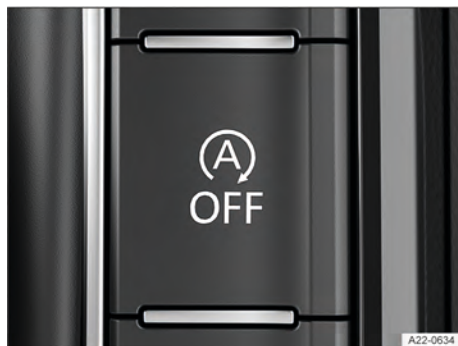
Fig. 141 Na parte inferior do console central ou, dependendo da versão, no sistema Infotainment: botão do sistema Start-Stop.
