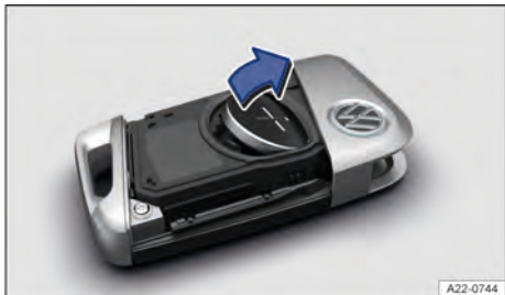
Fig. 65 Chave do veículo: trocar a pilha-botão.
