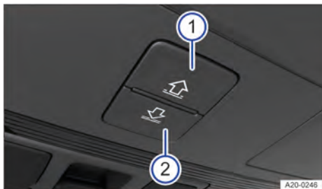
Fig. 128 No revestimento do teto: botões de comando da cortina de proteção solar.
