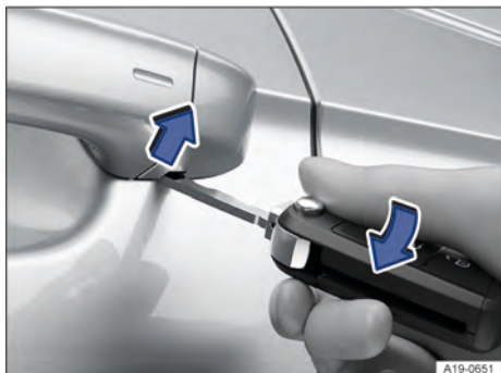
Fig. 72 Maçaneta da porta do condutor: alavancar a capa de cobertura para fora.
