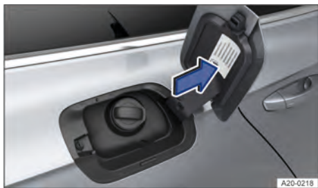
Fig. 221 No lado interno da portinhola do tanque: placa de indicação de combustível (representação esquemática).
