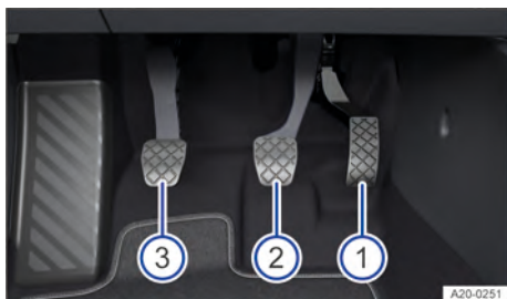
Fig. 136 Na área para os pés: pedais em veículos com transmissão manual.
