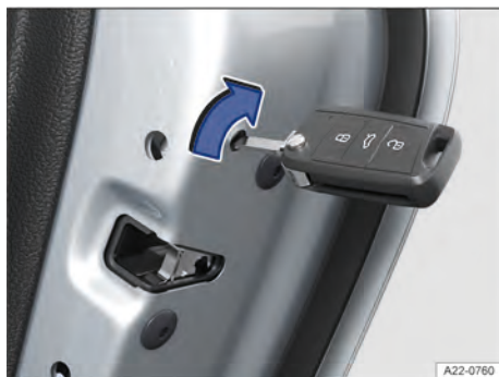
Fig. 73 Na parte dianteira da porta traseira direita: travamento de emergência do veículo com a chave do veículo (representação esquemática).
