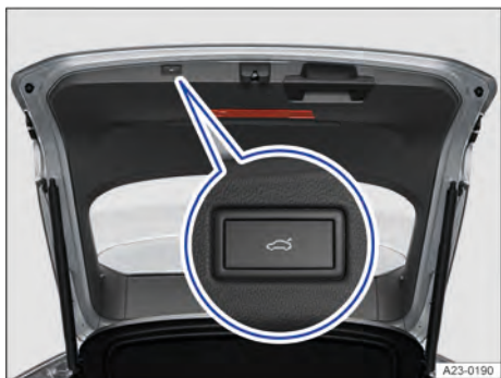
Fig. 79 Na tampa traseira aberta: botão para fechar eletricamente a tampa traseira.
