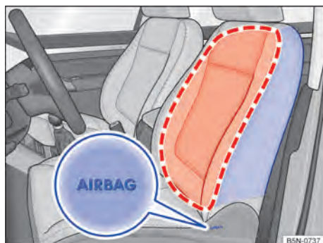
Fig. 46 Lateralmente em ambos os bancos dianteiros: local de instalação e área de expansão do airbag lateral.
