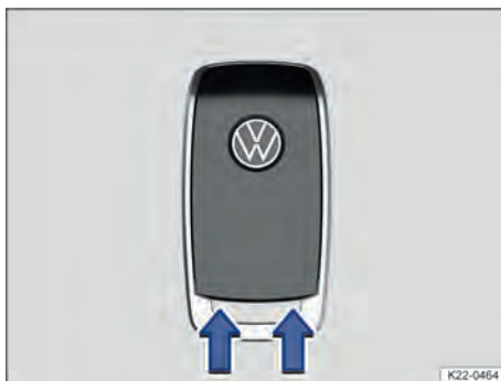
Fig. 134 Controle remoto: tampa do compartimento da bateria.
