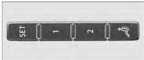
Fig. 110 Parte externa do banco do condutor: botões de memória.
