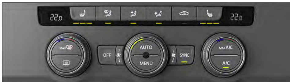
Fig. 131 Na parte superior do console central: painel de comando do ar-condicionado do Climatronic (variante 2).
