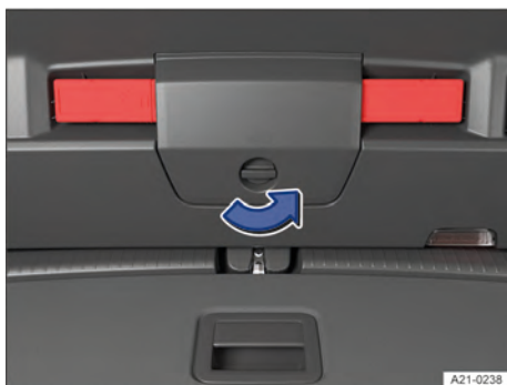
Fig. 82 Na tampa traseira: abrir o suporte do triângulo de segurança.
