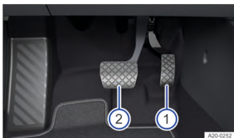
Fig. 137 Na área para os pés: pedais em veículos com transmissão automática.
