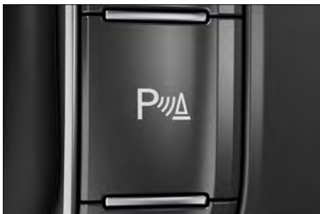
Fig. 177 No console central: botão do auxílio de estacionamento.
