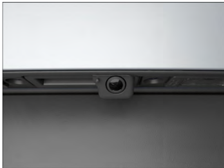
Fig. 288 Na traseira do veículo: câmera de marcha a ré no botão da alça (representação esquemática).
