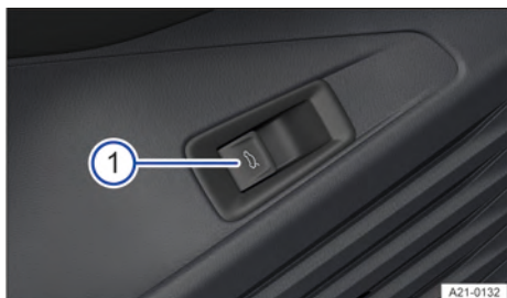
Fig. 78 Na porta do condutor: botão de comando da tampa traseira.
