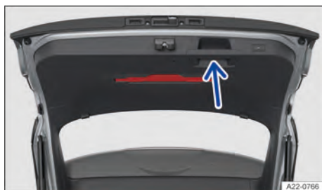
Fig. 77 Na tampa traseira aberta: alça para fechar a tampa traseira (representação esquemática).
