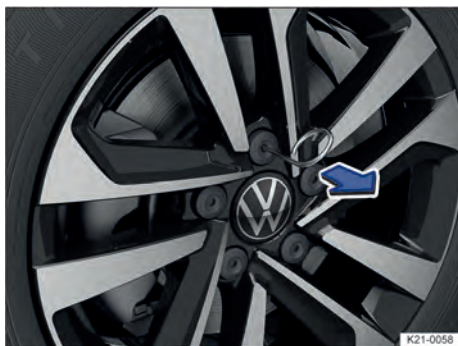
Fig. 274 Remover as capas de cobertura dos parafusos de roda.
