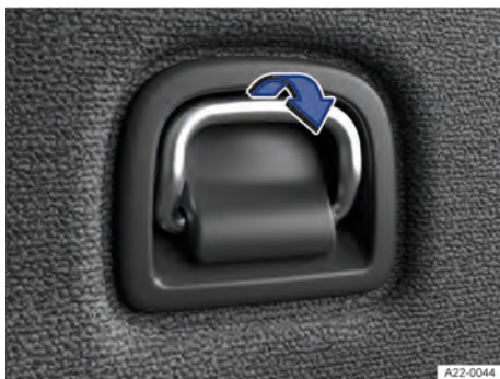
Fig. 211 No compartimento de bagagem: olhal de amarração rebatível (representação esquemática).
