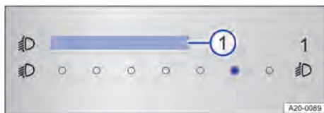
Fig. 120 No sistema Infotainment: regulador touch para regulagem do alcance do farol.
