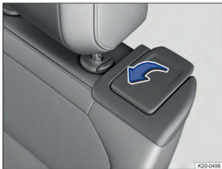
Fig. 109 Segunda fileira de bancos: comandos do auxílio na entrada.
