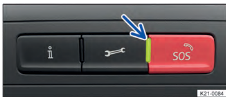
Fig. 59 No console do teto: comando de serviços de voz e luz de controle.
