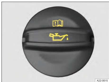
Fig. 257 No compartimento do motor: tampa da abertura para enchimento de óleo do motor (representação esquemática).
