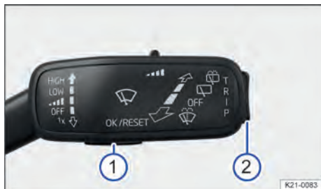
Fig. 21 Na coluna de direção direita: botões da alavanca dos limpadores dos vidros.
