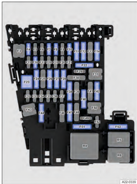
Fig. 241 No painel de instrumentos: disposição dos fusíveis.
