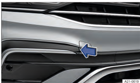
Fig. 246 No para-choque dianteiro à direita: retirar cobertura.
