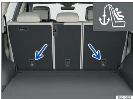
Fig. 56 No lado de trás do banco traseiro: pontos de ancoragem Top Tether do cinto de segurança Top Tether.
