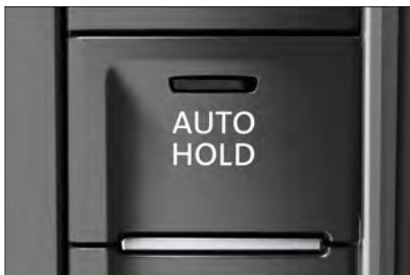
Fig. 175 No console central: botão do Auto Hold.
