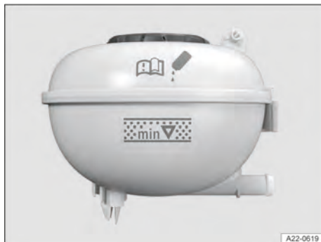
Fig. 260 No compartimento do motor: marcações no reservatório de expansão do líquido de arrefecimento (representação esquemática).
