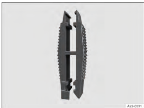
Fig. 243 Alicete de plástico para retirar ou instalar um fusível (representação esquemática).
