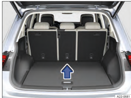
Fig. 204 No compartimento de bagagem: levantar o assoalho do compartimento de bagagem.
