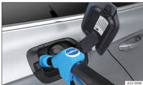
Fig. 230 Atrás da portinhola do tanque: reabastecer o AdBlue® com o bico da bomba (representação esquemática).
