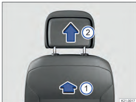
Fig. 103 Desinstalar o apoio para cabeça dianteiro (representação esquemática).
