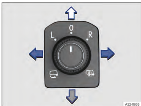
Fig. 126 Na porta do condutor: botão rotativo dos espelhos retrovisores externos.
