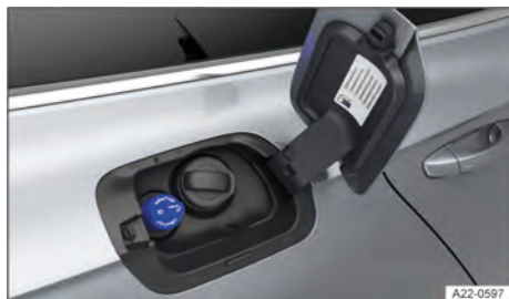
Fig. 228 Atrás da portinhola do tanque: tampa do tanque para AdBlue (representação esquemática).
