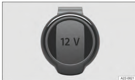
Fig. 195 No porta-objetos do console central dianteiro, no console central traseiro ou no compartimento de bagagem do lado esquerdo: tomada 12 V rebatível (representação esquemática).
