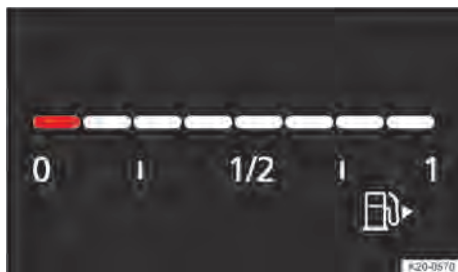
Fig. 23 No instrumento combinado digital Basic: indicador do nível de combustível (representação esquemática).
