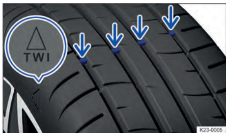
Fig. 268 Nos sulcos do perfil: indicador de desgaste.
