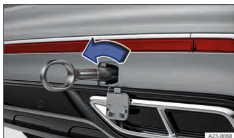
Fig. 251 No para-choque traseiro à direita: rosquear a argola de reboque da variante 2.
