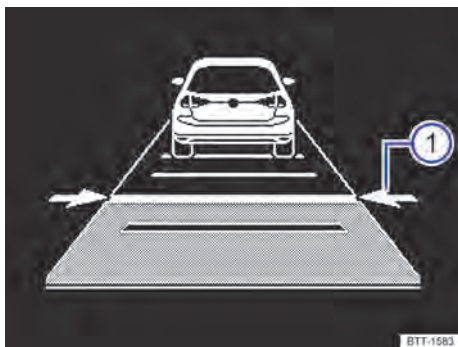
Fig. 168 No display do instrumento combinado: distância ajustada no caso de regulação (representação esquemática).
