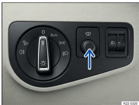
Fig. 29 Ao lado do volante: regulador do head-up display (seta).
