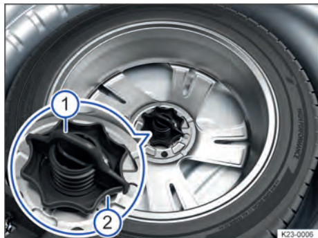
Fig. 272 Sob o assoalho do compartimento de bagagem: manípulo de fixação da roda sobressalente.
