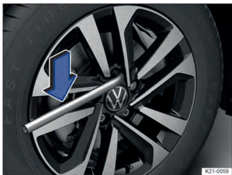
Fig. 275 Soltar os parafusos de roda.
