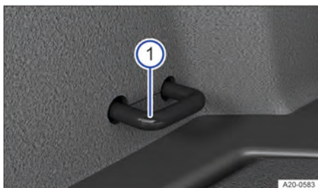
Fig. 210 No compartimento de bagagem: olhal de amarração (representação esquemática).
