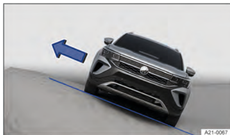
Fig. 154 Representação esquemática: desembarcar do lado do veículo voltado para cima da encosta.
