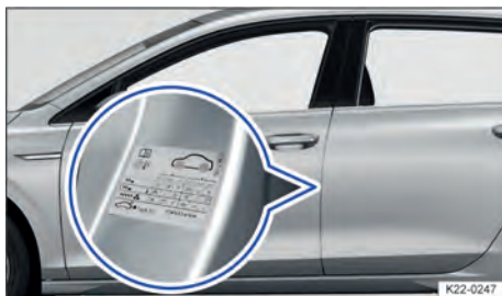
Fig. 264 Na coluna do condutor: etiqueta com as pressões dos pneus (alternativa ao lado interno da portinhola do tanque).
