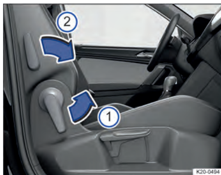
Fig. 92 Banco do passageiro dianteiro: rebater o encosto para frente.
