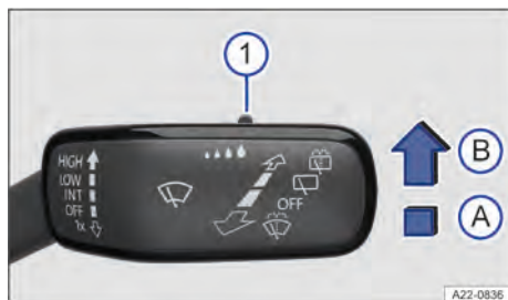
Fig. 123 À direita da coluna de direção: alavanca dos limpadores dos vidros.
