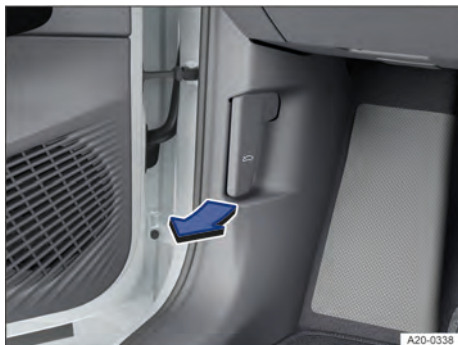
Fig. 252 Na área para os pés no lado do condutor: alavanca de destravamento da tampa dianteira (representação esquemática).
