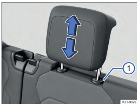
Fig. 100 Ajustar o apoio para cabeça na segunda fileira de bancos (representação esquemática).
