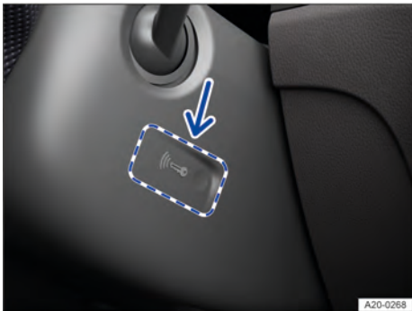
Fig. 140 À direita na coluna de direção: função de partida de emergência em veículos com sistema de travamento e de partida Keyless Access sem chave.
