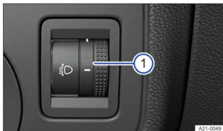
Fig. 119 Ao lado do volante: regulador do alcance do farol.
