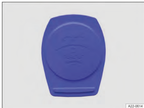
Fig. 254 No compartimento do motor: tampa do reservatório de água dos lavadores dos vidros (representação esquemática).
