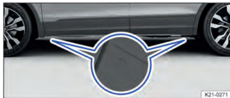
Fig. 276 Na longarina lateral: marcas dos pontos de apoio e do macaco.
