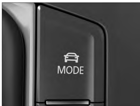
Fig. 148 No console central: botão MODE na seleção do perfil de condução.
