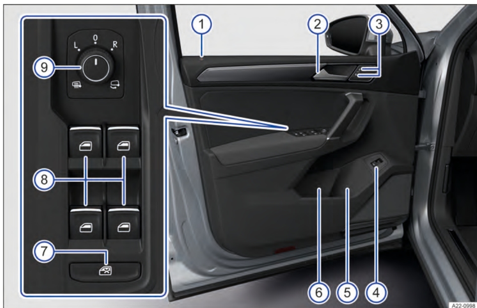
Fig. 3 Porta do condutor (veículos com direção à esquerda): comandos (em veículos com direção à direita, a disposição dos elementos é espelhada).
