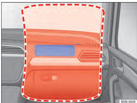
Fig. 42 No lado do passageiro dianteiro: local de instalação e área de expansão do airbag frontal do passageiro dianteiro.
