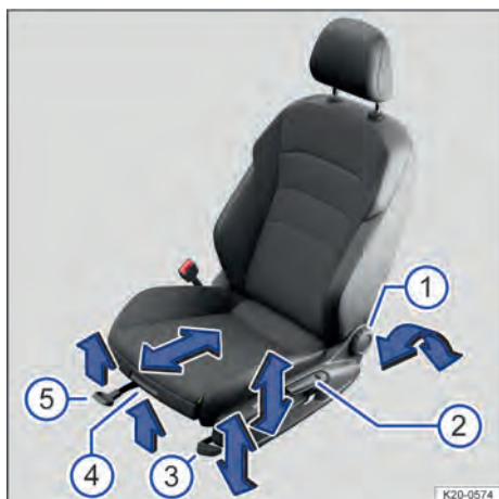
Fig. 88 No banco do condutor: comandos (variante 2).
