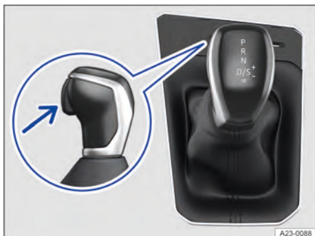
Fig. 143 No console central: alavanca seletora da transmissão automática (representação esquemática).
