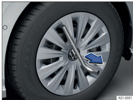
Fig. 273 Retirar a calota integral.
