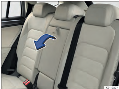
Fig. 108 No encosto do banco central: descansa-braço central traseiro rebatível.
