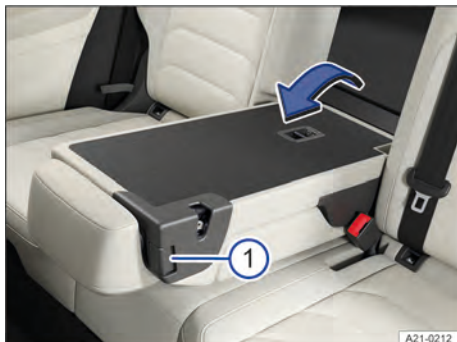
Fig. 214 No encosto do banco traseiro: abrir o dispositivo para transporte de objetos longos.
