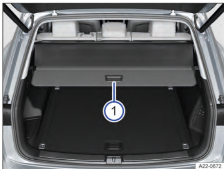
Fig. 202 No compartimento de bagagem: abrir a cobertura do compartimento de bagagem (representação esquemática).
