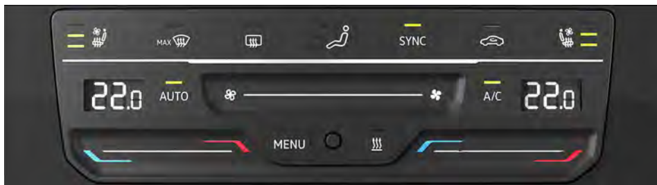
Fig. 130 Na parte superior do console central: painel de comando do ar-condicionado do Climatronic (variante 1).
