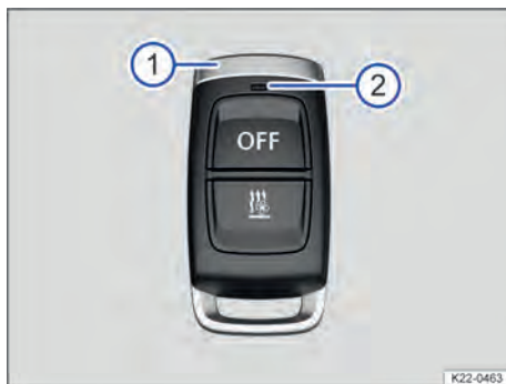
Fig. 133 Controle remoto do aquecimento estacionário.
