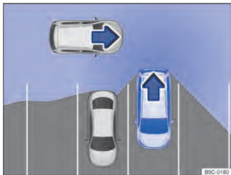
Fig. 189 Área monitorada ao redor do veículo que irá sair da vaga de estacionamento (representação esquemática).
