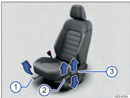
Fig. 89 No banco do condutor: comandos (variante 3).
