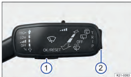
Fig. 17 Na coluna de direção direita: botões da alavanca dos limpadores dos vidros.
