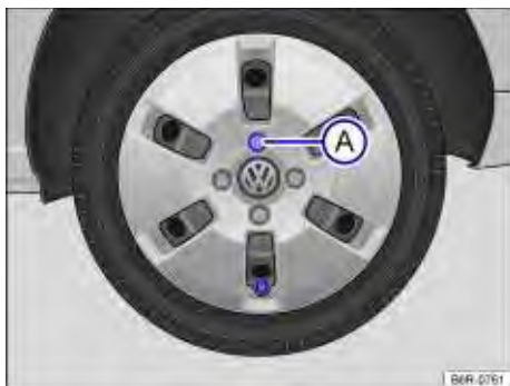
Fig. 138 Retirar a calota integral.
