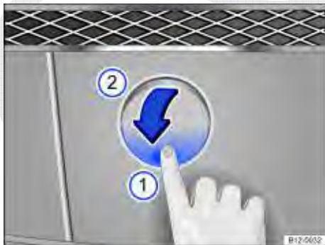
Fig. 156 No para-choque dianteiro à direita: soltar e remover a cobertura.
