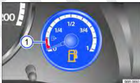
Fig. 101 No instrumento combinado: indicador do nível de combustível (variante 2).
