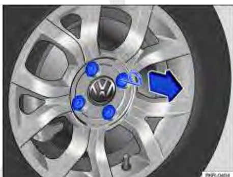
Fig. 139 Retirar as capas de cobertura dos parafusos da roda.
