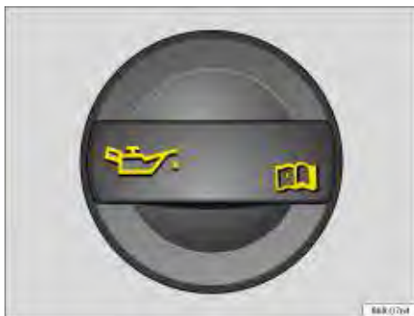
Fig. 106 No compartimento do motor: tampa da abertura para enchimento de óleo do motor.
