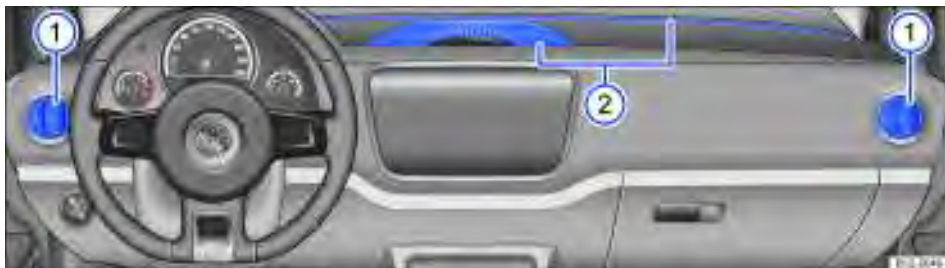
Fig. 98 No painel de instrumentos: difusores de ar.
