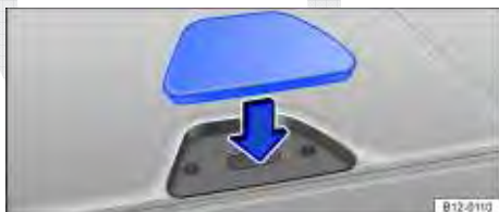
Fig. 121 No console central: fechar a abertura do suporte do aparelho de navegação.
