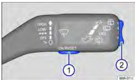
Fig. 11 Alavanca dos limpadores dos vidros: botão ① para confirmação dos itens e chave ② para trocar o indicador do display.
