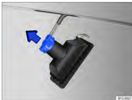
Fig. 154 Lanterna da placa de licença: remover o soquete da lâmpada.
