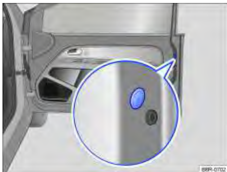
Fig. 132 Na parte dianteira da porta do passageiro dianteiro: travamento de emergência, coberto por uma vedação de borracha.
