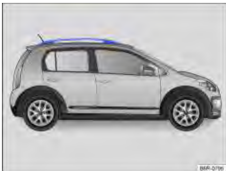
Fig. 71 Suportes longitudinais do bagageiro do teto (ambos os lados).
