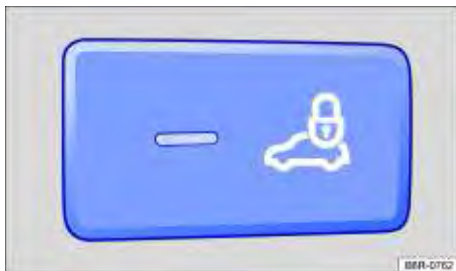
Fig. 20 Luz de controle no painel de instrumentos para indicação do travamento central acionado e/ou indicação do monitoramento do interior do veículo desligado.
