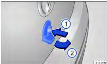
Fig. 27 Abrir a tampa traseira por fora.
