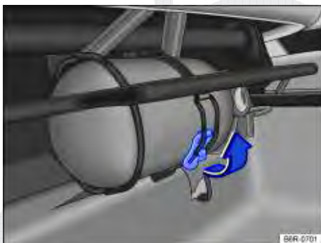
Fig. 128 No banco do passageiro dianteiro: extintor de incêndio.
