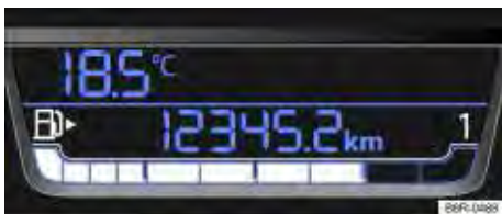
Fig. 100 No display do instrumento combinado: indicador do nível de combustível (variante 1).
