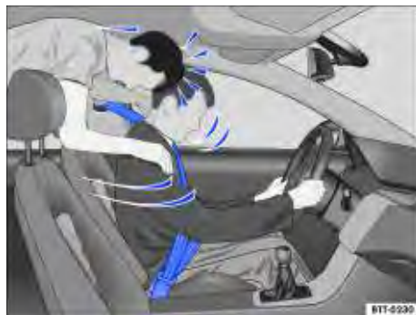
Fig. 40 O passageiro sem cinto de segurança no banco traseiro é lançado para frente sobre o condutor com cinto de segurança.
