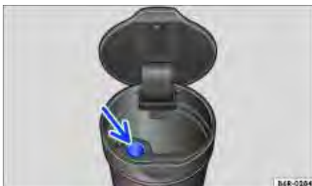
Fig. 114 Cinzeiro com apagador de cigarro removido e aberto.
