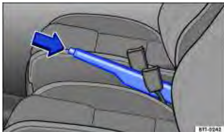
Fig. 90 Entre os bancos dianteiros: alavanca do freio de estacionamento.
