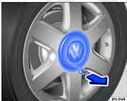
Fig. 137 Retirar a calota central da roda de liga leve.
