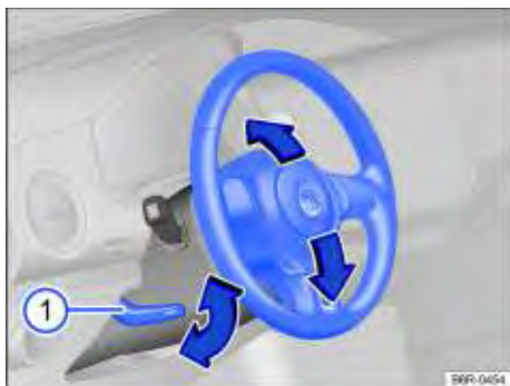
Fig. 35 Ajustar a posição do volante mecanicamente.
