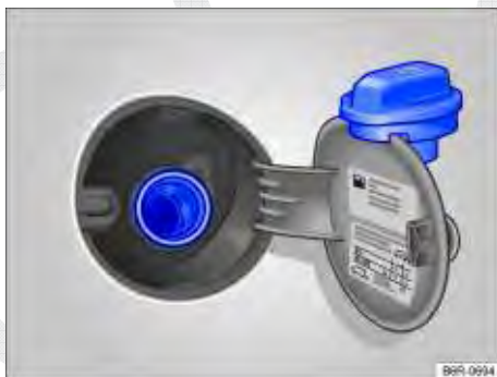
Fig. 102 Portinhola do tanque de combustível aberta com a tampa do tanque de combustível pendurada.
