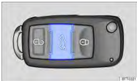
Fig. 26 Na chave do veículo: botão de destravamento da tampa traseira.
