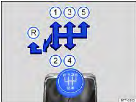
Fig. 86 Esquema de troca de marchas da transmissão manual de 5 marchas.
