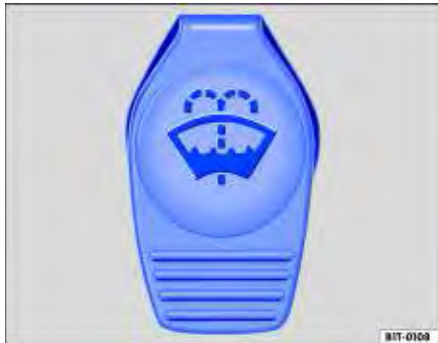
Fig. 60 No compartimento do motor: tampa do reservatório de água dos lavadores dos vidros.
