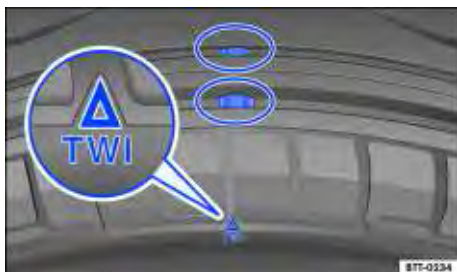
Fig. 117 Perfil do pneu: indicadores de desgaste.
