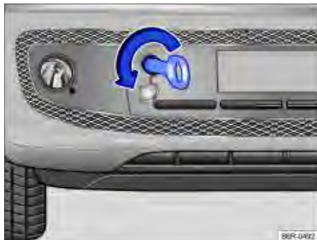
Fig. 157 No para-choque dianteiro à direita: rosquear a argola de reboque. ▶
