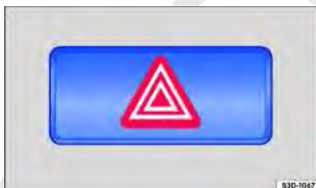
Fig. 126 Na parte superior do console central: interruptor para ligar e desligar as luzes de advertência.
