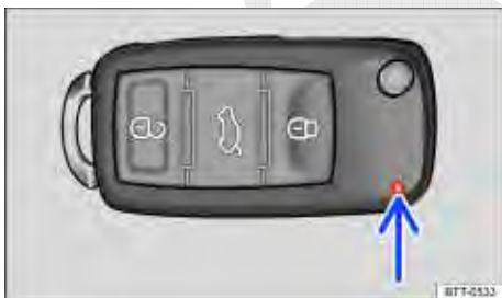
Fig. 17 Luz de controle da chave do veículo com comando remoto.
