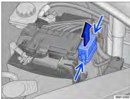
Fig. 143 No compartimento do motor: retirar cobertura da caixa de fusíveis.
