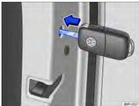
Fig. 133 Travamento de emergência do veículo com a chave do veículo.
