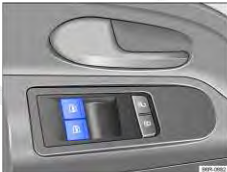
Fig. 29 Na porta do condutor: teclas dos vidros elétricos dianteiros.
