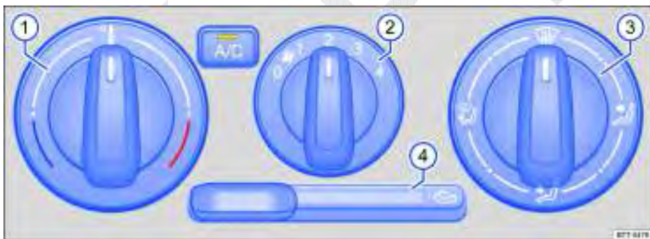
Fig. 97 No console central: comandos do ar-condicionado.
