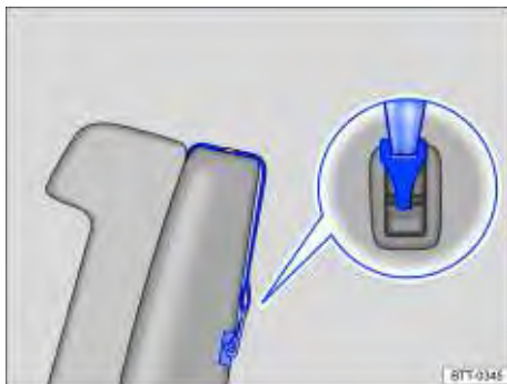
Fig. 52 Exemplo de um cinto de fixação superior preso.
