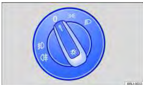
Fig. 56 No painel: interruptor das luzes.
