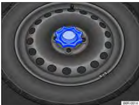
Fig. 118 No compartimento de bagagem: manípulo para fixação da roda de emergência.
