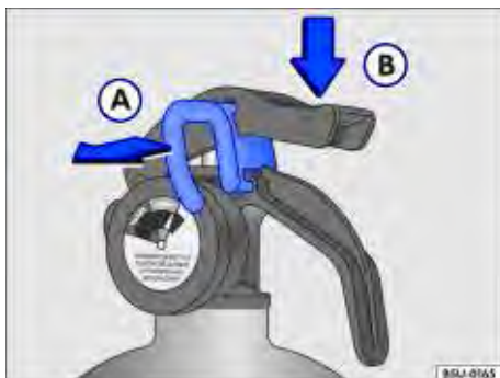
Fig. 129 Sequência de utilização do extintor de incêndio.
