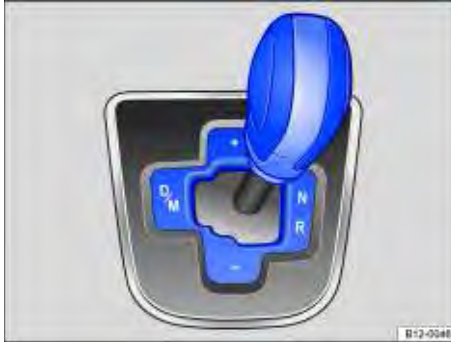
Fig. 87 Alavanca seletora da transmissão automatizada.
