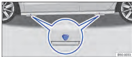
Fig. 221 Pontos de apoio do macaco.
