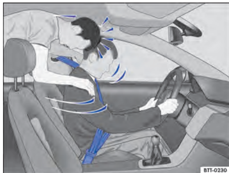
Fig. 30 O passageiro sem cinto de segurança no banco traseiro é lançado para frente sobre o condutor com cinto de segurança.
