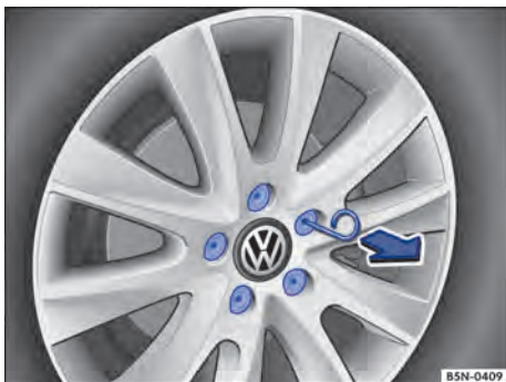
Fig. 219 Remover as capas de cobertura dos parafusos de roda.
