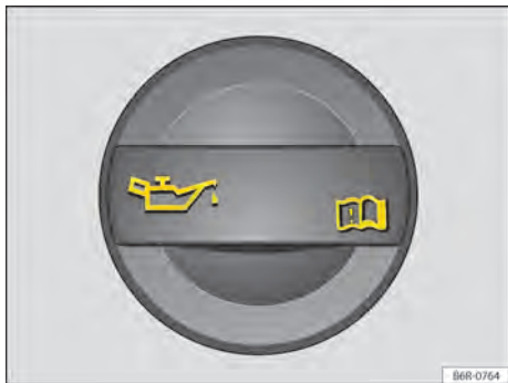
Fig. 206 No compartimento do motor: tampa da abertura para enchimento de óleo do motor.
