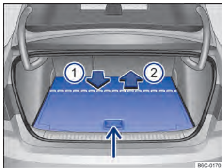
Fig. 170 No compartimento de bagagem: ajustar a altura do assoalho variável do compartimento de bagagem.
