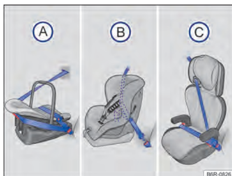
Fig. 43 As ilustrações A, B e C mostram a fixação do sistema de retenção para crianças apenas com o cinto de segurança do veículo.
