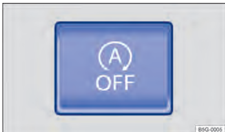
Fig. 94 Na parte inferior do console central: botão do sistema Start-Stop.
