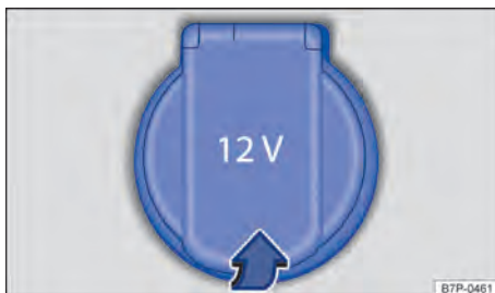
Fig. 113 No console central dianteiro: tomada 12 V.
