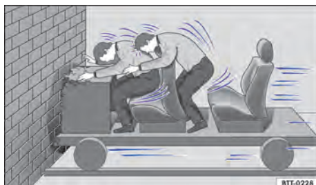
Fig. 28 Um veículo com os ocupantes do veículo sem cintos de segurança colide com o muro.
