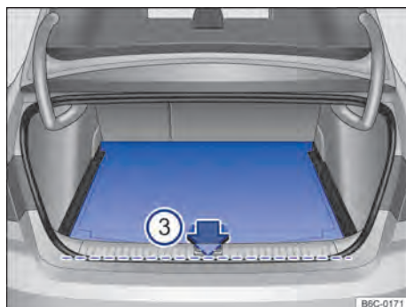
Fig. 171 No compartimento de bagagem: assoalho variável do compartimento de bagagem .
