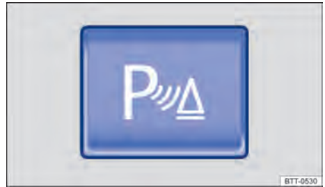
Fig. 103 No console central: botão para ligar e desligar o auxílio de estacionamento (dependendo da versão do veículo).
