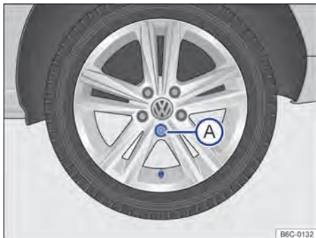
Fig. 218 Retirar a calota integral.
