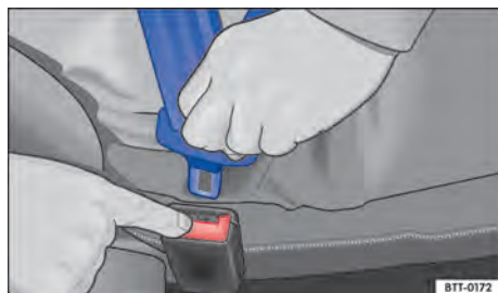
Fig. 33 Soltar a lingueta do cinto de segurança do fecho do cinto de segurança.
