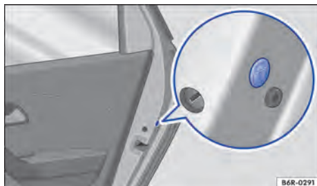
Fig. 59 Na porta traseira: travamento de emergência, coberto por uma vedação de borracha.
