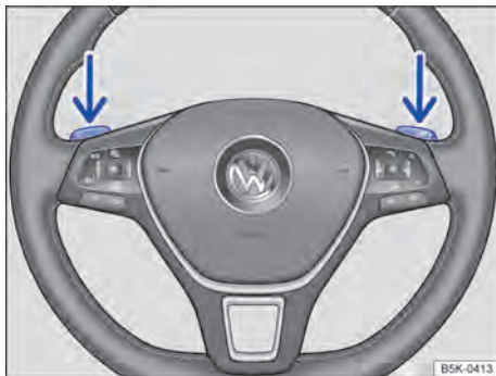
Fig. 98 Volante com seletores basculantes do Tiptronic.
