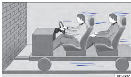
Fig. 27 Um veículo com os ocupantes do veículo sem cintos de segurança está em rota de colisão com um muro.
