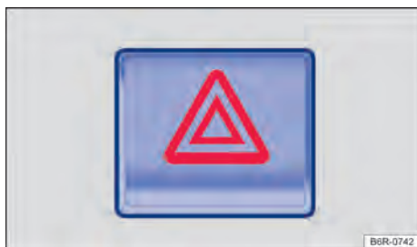
Fig. 49 Na parte superior do console central: interruptor das luzes de advertência.
