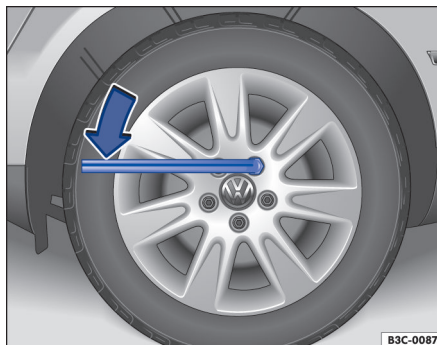
Fig. 194 Troca de roda: soltar os parafusos de roda.
