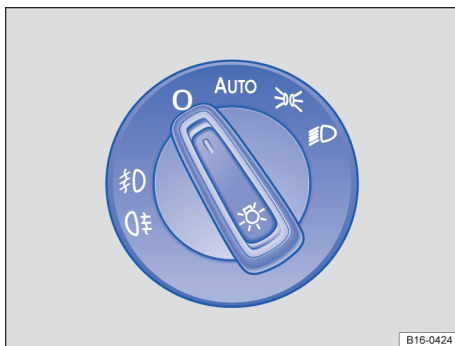
Fig. 73 Ao lado do volante: interruptor de luzes (uma variante).
