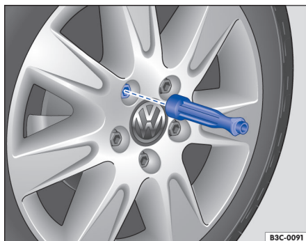
Fig. 201 Troca de roda: desaparafusar os parafusos de roda com o punho da chave de fenda.
