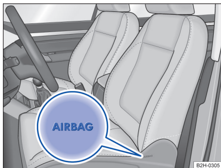
Fig. 37 Na lateral no banco dianteiro: local de instalação do airbag para cabeça e laterais combinado.
