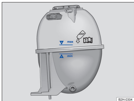
Fig. 175 No compartimento do motor: marcações no reservatório de expansão do líquido de arrefecimento (representação esquemática).
