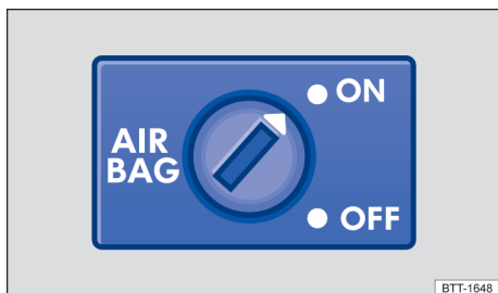
Fig. 36 Na parte frontal no lado do passageiro dianteiro: interruptor acionado pela chave para desativar e ativar o airbag frontal do passageiro dianteiro.
