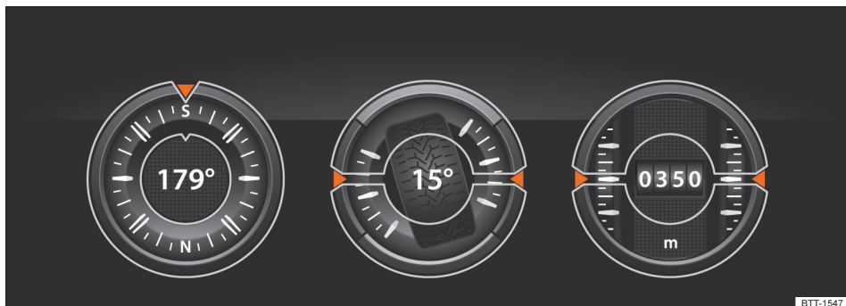
Fig. 106 Indicação no sistema Infotainment: indicação off-road.
