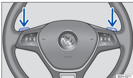
Fig. 101 Volante com seletores basculantes do Tiptronic.
