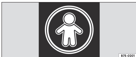
Fig. 92 No display do teto: símbolo de trava de segurança para crianças ativada.
