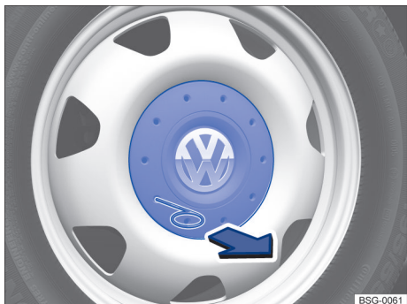
Fig. 192 Retirar a calota central.
