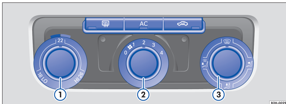
Fig. 87 No painel de instrumentos: elementos de comando do Climatic.
