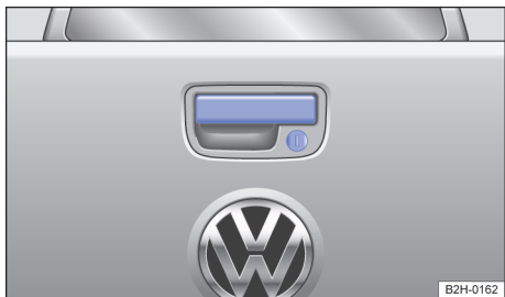
Fig. 51 Alça para abrir a tampa do compartimento de carga.
