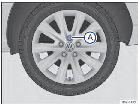
Fig. 144 Retirar a calota integral.
