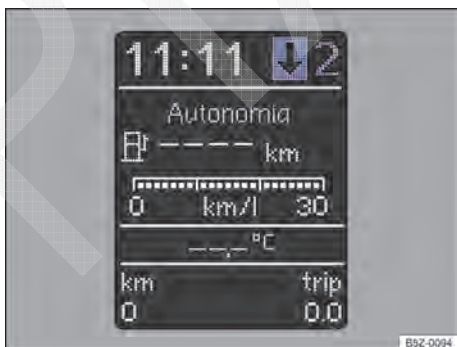
Fig. 98 No instrumento combinado: indicador de troca de marcha (variante 1).
