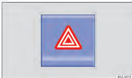
Fig. 155 Na parte superior do console central: interruptor para ligar e desligar as luzes de advertência.
