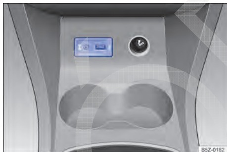
Fig. 83 No console central dianteiro: interface USB e entrada AUX-IN
