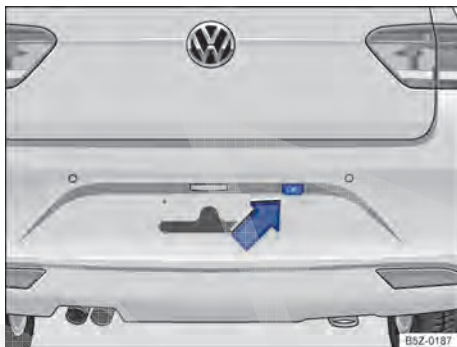
Fig. 117 No para-choque traseiro: local de instalação do assistente de condução em marcha a ré.
