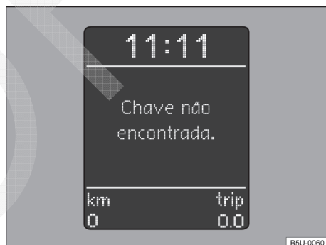
Fig. 93 No instrumento combinado: display com indicação do imobilizador ativado - veículos com Sistema de Informações Volkswagen.
