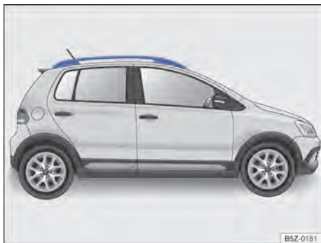
Fig. 78 Suportes longitudinais do bagageiro do teto (ambos os lados)
