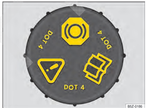
Fig. 110 No compartimento do motor: tampa do reservatório de fluido de freio (variante 2).
