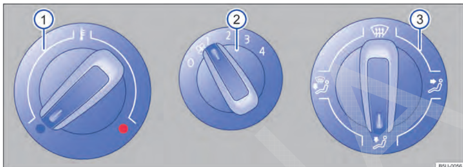
Fig. 122 No console central: comandos do sistema de ventilação e aquecimento.
