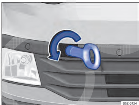
Fig. 189 No para-choque dianteiro à direita: rosquear a argola de reboque.
