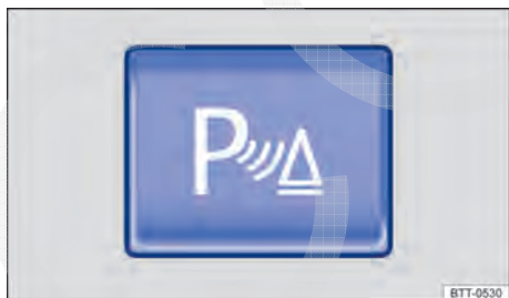
Fig. 112 Na parte superior do console central: botão para ligar e desligar o controle de distância de estacionamento (Park Pilot).
