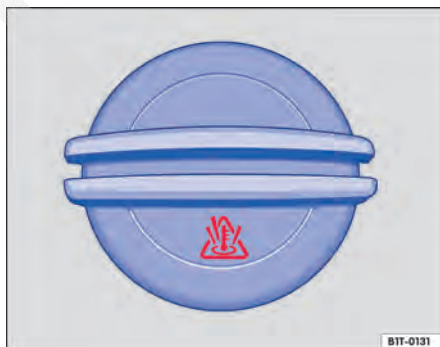
Fig. 134 No compartimento do motor: tampa do reservatório de expansão do líquido de arrefecimento do motor.
