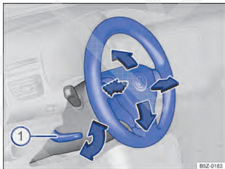
Fig. 39 Ajustar a posição do volante mecanicamente.
