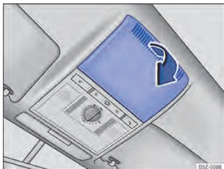
Fig. 162 No revestimento do teto: remover a cobertura.
