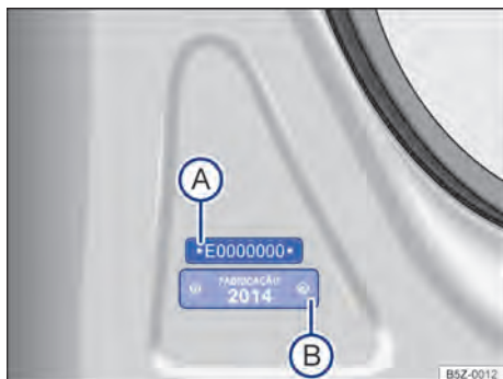
Fig. 192 Na coluna da porta dianteira direita: etiqueta com o número de identificação do veículo parcial (A) e etiqueta de identificação do ano de fabricação (B).
