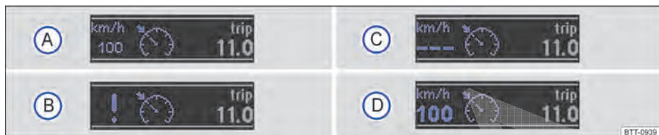
Fig. 120 No display do instrumento combinado: indicadores de status do GRA.
