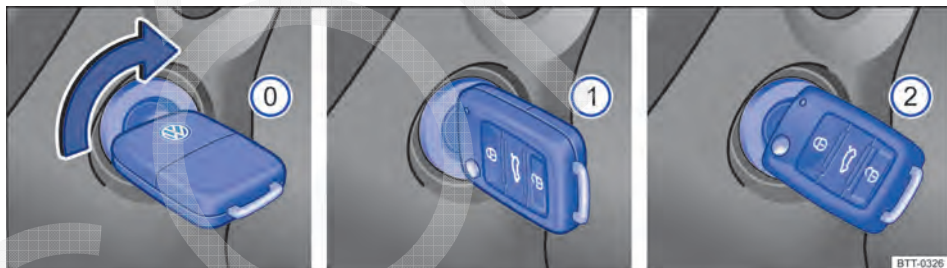
Fig. 92 Ao lado do volante, à direita: posições da chave do veículo no cilindro da ignição.
