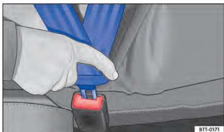
Fig. 46 Introduzir a lingueta do cinto de segurança no fecho do cinto de segurança.
