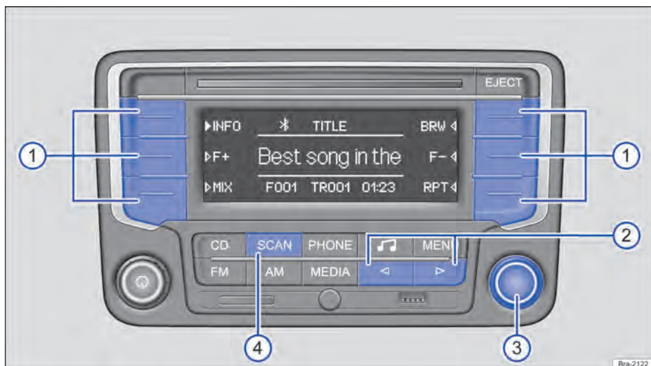
Fig. 136 Exemplo de exibição na operação de mídia: selecionar os modos de reprodução.
