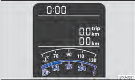
Fig. 12 No display do instrumento combinado: indicador do nível de combustível (variante 1).
