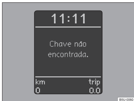
Fig. 80 No instrumento combinado: display com indicação do imobilizador ativado - veículos com Sistema de Informações Volkswagen.
