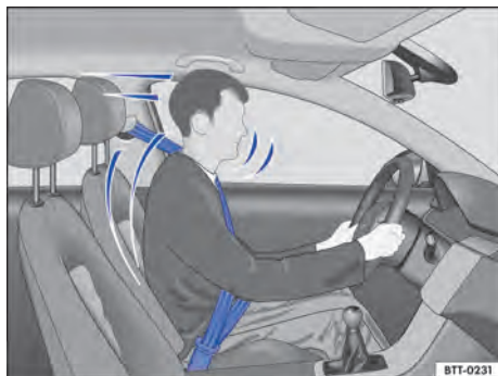
Fig. 26 Condutor protegido pelo cinto de segurança colocado corretamente em uma manobra de frenagem súbita.
