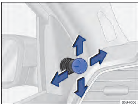
Fig. 67 Nas portas dianteiras: interruptor de ajuste dos espelhos retrovisores externos mecânicos.
