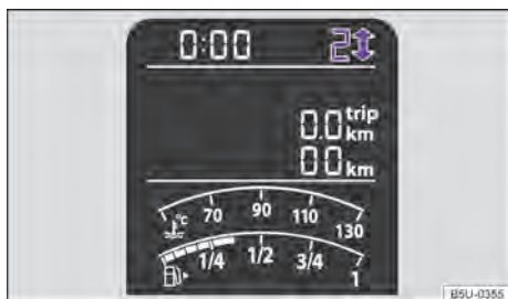
Fig. 76 No instrumento combinado: indicador de troca de marcha (variante 1).
