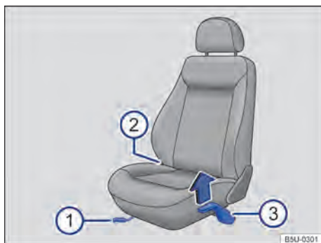
Fig. 54 Comandos do banco dianteiro esquerdo.
