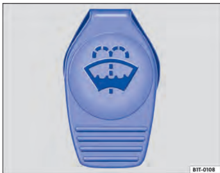
Fig. 169 No compartimento do motor: tampa do reservatório de água dos lavadores dos vidros.
