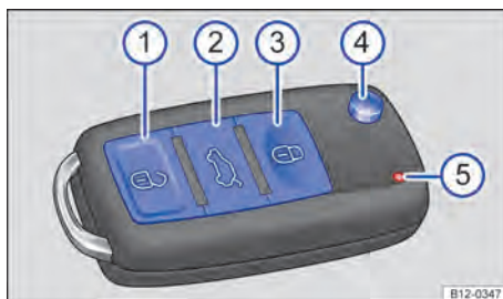
Fig. 43 Chave do veículo com comando remoto.
