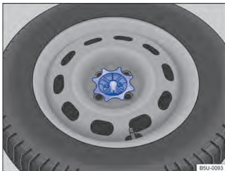
Fig. 181 No compartimento de bagagem: manípulo para fixação da roda de emergência.
