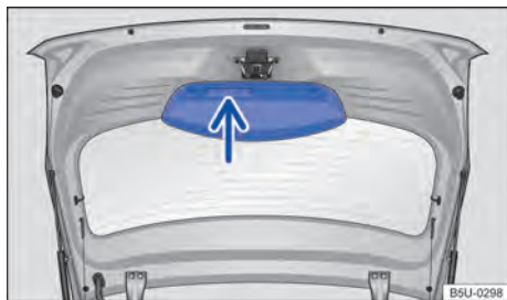
Fig. 51 Tampa traseira aberta: puxador para fechamento.
