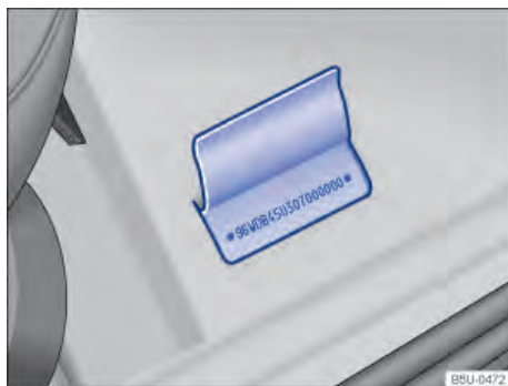
Fig. 190 Em frente ao banco do passageiro dianteiro: número de identificação do veículo (número do chassi) no assoalho, em frente ao banco do passageiro dianteiro.
