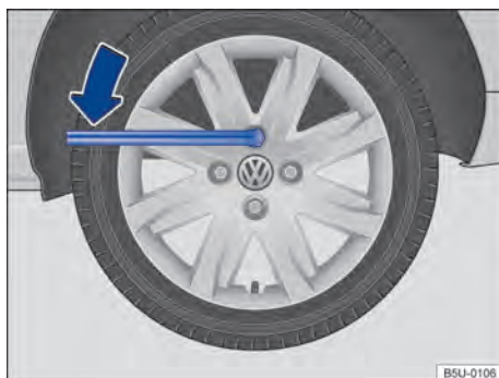
Fig. 185 Troca de roda: soltar os parafusos da roda.
