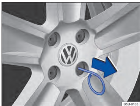
Fig. 183 Retirar as capas de cobertura dos parafusos da roda.
