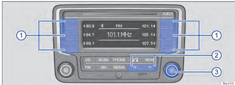
Fig. 127 Troca de estação por meio dos botões de função ou dos botões do aparelho.
