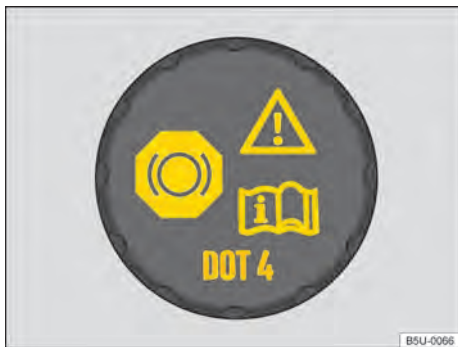
Fig. 174 No compartimento do motor: tampa do reservatório de fluido de freio.
