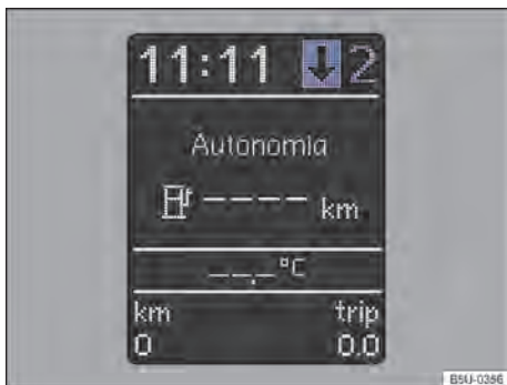
Fig. 77 No instrumento combinado: indicador de troca de marcha (variante 2).
