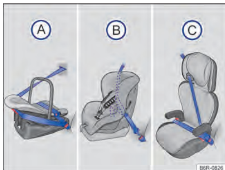
Fig. 34 As ilustrações (A), (B) e (C) mostram a fixação do sistema de retenção para crianças apenas com o cinto de segurança do veículo.
