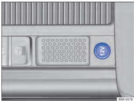
Fig. 127 Na parte inferior do console central: tomada 12 V.
