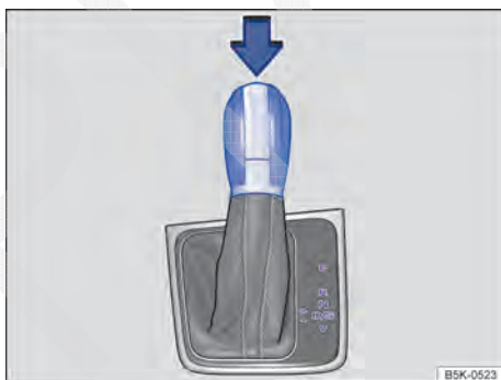
Fig. 138 Veículos com direção à direita: alavanca seletora da transmissão automática com botão bloqueador (seta).
