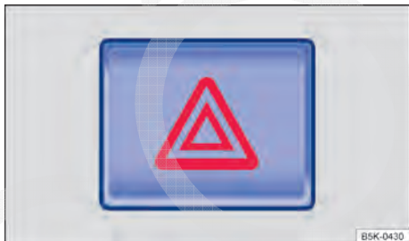
Fig. 214 Na parte superior do console central: botão das luzes de advertência.
