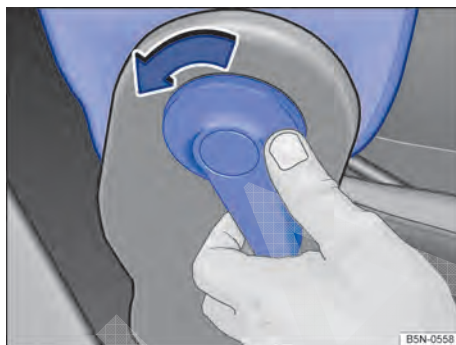
Fig. 57 Destruar o encosto do banco do passageiro dianteiro rebatível.
