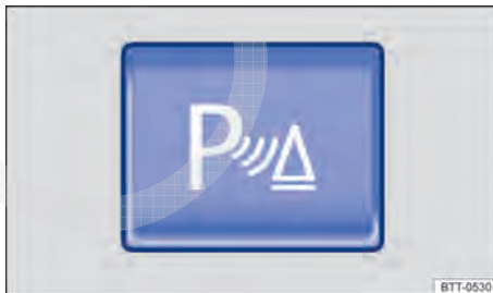
Fig. 149 Na parte inferior do console central: botão para ligar e desligar o Park Pilot.
