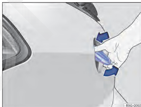
Fig. 37 Abrir a tampa traseira por fora.
