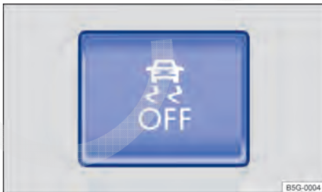
Fig. 143 Na parte inferior do console central: botão para desligar e ligar manualmente o ASR, ASR com ESC ou ESC Sport.
