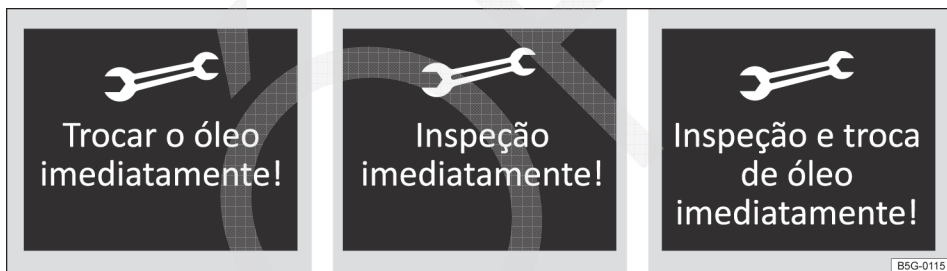
Fig. 14 Representação esquemática: exemplos de indicações no display do instrumento combinado para um evento de serviço próximo de vencer.
