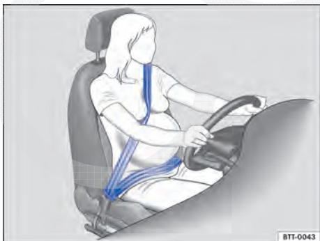
Fig. 68 Posição correta do cadarço do cinto de segurança para mulheres grávidas.
