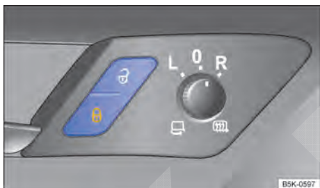
Fig. 29 Na porta do condutor: botão do travamento central.
