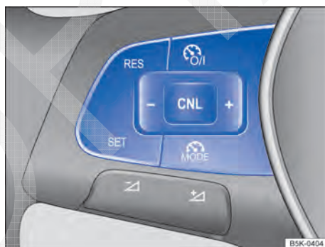
Fig. 167 Lado esquerdo do volante multifunções: botões para comandar o limitador de velocidade.
