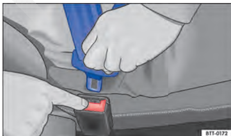
Fig. 66 Soltar a lingueta do cinto de segurança do fecho do cinto de segurança.
