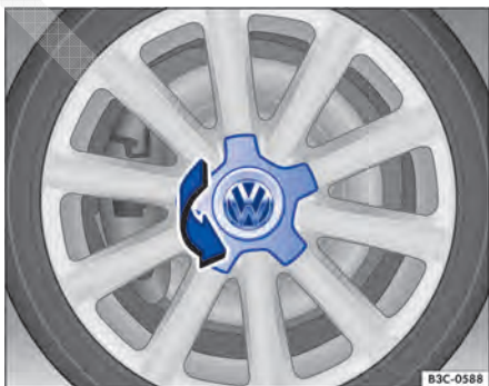
Fig. 226 Virar a calota central.
