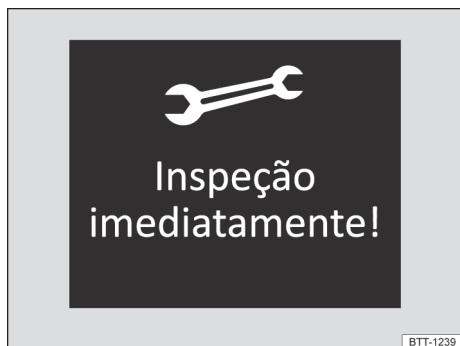
Fig. 22 Representação esquemática: exemplo de indicação no display do instrumento combinado para um evento de serviço próximo de vencer.
