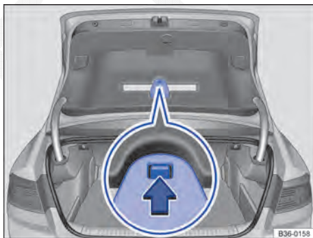
Fig. 279 Na tampa do compartimento de bagagem: suporte para o triângulo de segurança (Passat).
