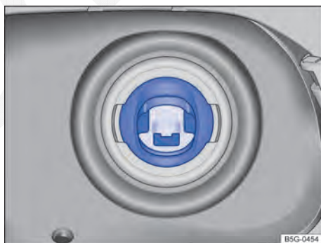
Fig. 254 Com a portinhola do tanque aberta: proteção contra abastecimento errado no bocal de abastecimento do tanque.
