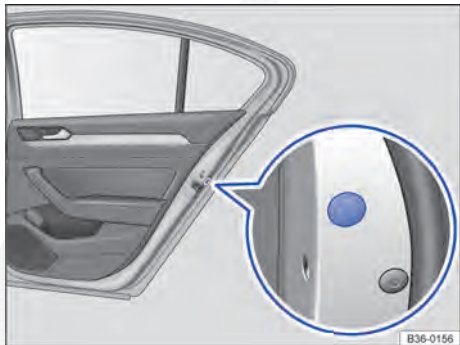
Fig. 282 Na parte dianteira da porta traseira direita: travamento de emergência, coberto por uma vedação de borracha.
