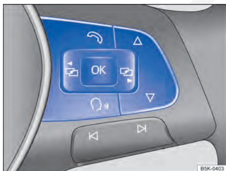
Fig. 27 Lado direito do volante multifunções: botões para comando dos menus e exibições de informação do instrumento combinado.
