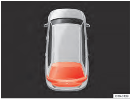
Fig. 46 Passat Variant: no display do instrumento combinado: tampa do compartimento de bagagem aberta ou fechada incorretamente.
