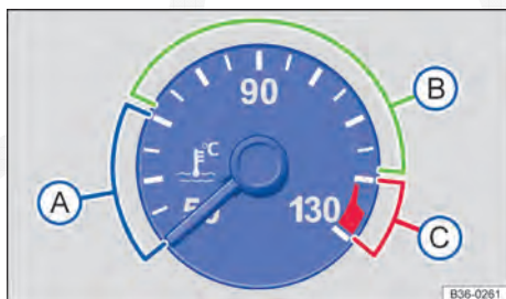
Fig. 262 Indicador de temperatura do líquido de arrefecimento do motor no instrumento combinado: (A) área fria; (B) área normal; (C) área de advertência.
