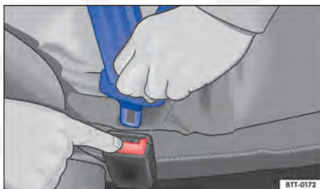
Fig. 83 Soltar a lingueta do cinto de segurança do fecho do cinto de segurança.
