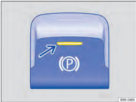
Fig. 186 Na parte inferior do console central: botão do freio de estacionamento eletrônico.
