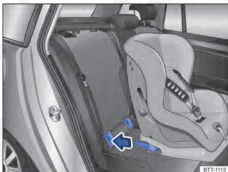
Fig. 101 Representação esquemática: instalar a cadeira de criança ISOFIX com os braços de apoio.
