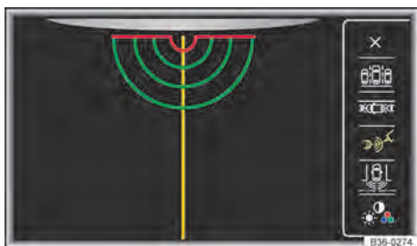
Fig. 207 Exibição do display da câmera de marcha a ré: assistente do reboque.
