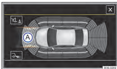
Fig. 199 Exibição do display do Park Pilot: exibição do percurso sem ângulo de direção.
