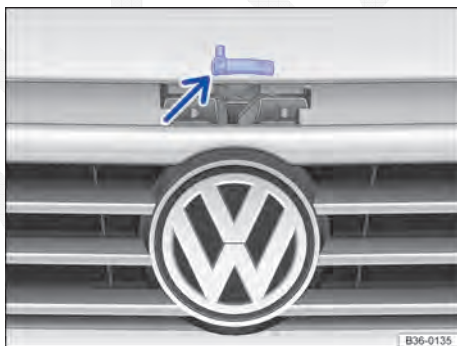
Fig. 259 Acima da grade do radiador: alavanca de abertura da tampa de compartimento do motor
