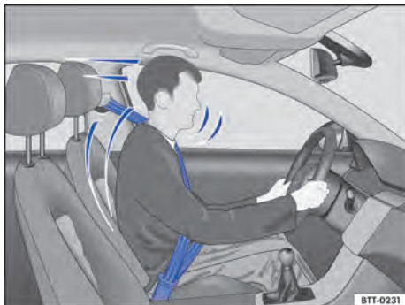
Fig. 81 Condutores protegidos pelo cinto de segurança colocado corretamente em uma manobra de frenagem súbita.
