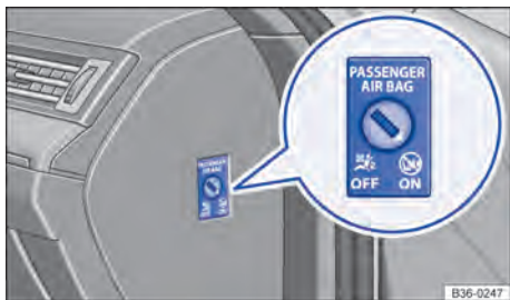
Fig. 90 No painel de instrumentos no lado do passageiro dianteiro: interruptor acionado pela chave para desligar e ligar o airbag frontal do passageiro dianteiro.
