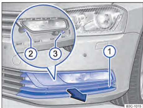
Fig. 249 No para-choque dianteiro à esquerda: lanterna para luz de neblina, farol de rodagem diurna e farol de conversão.
