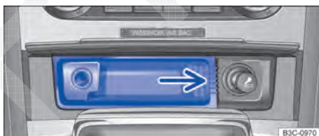
Fig. 132 No console central dianteiro: remover o cinzeiro.
