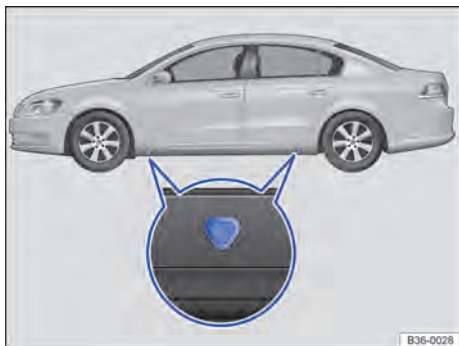
Fig. 235 Pontos de apoio do macaco.
