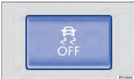
Fig. 152 No console central: botão para desligar e ligar o ASR manualmente.
