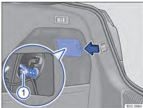
Fig. 255 Na carroceria: desinstalar a lanternas traseiras.
