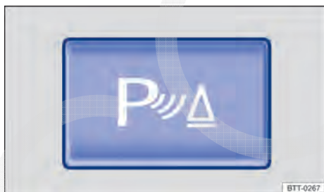
Fig. 158 Na parte inferior do console central: botão para ligar e desligar o Park Pilot.
