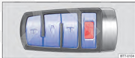
Fig. 27 Chave do veículo com botão do alarme.
