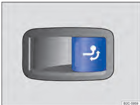
Fig. 115 No compartimento de bagagem, à direita: botão para destravamento da rótula de engate.
