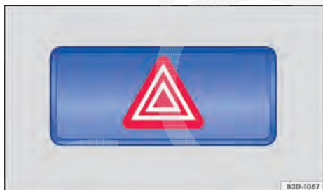
Fig. 216 Na parte superior do console central: interruptor das luzes de advertência.
