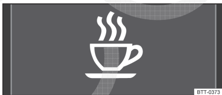
Fig. 184 No display do instrumento combinado: símbolo do sistema de reconhecimento de cansaço.
