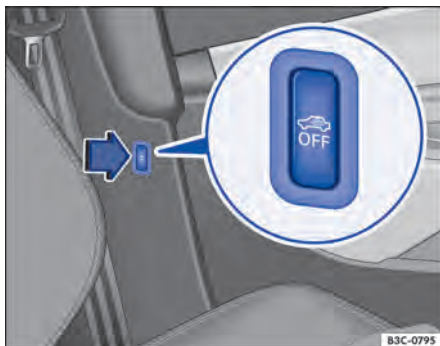
Fig. 31 Ao lado do banco do condutor: botão para desligar o monitoramento do interior do veículo e o alarme antirrebocagem.
