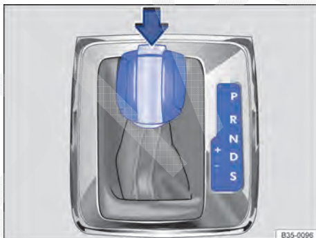
Fig. 148 Veículos com direção à direita: alavanca seletora da transmissão automática com botão bloqueador (seta).
