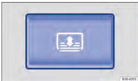
Fig. 93 No console central: interruptor da cortina de proteção solar do vidro traseiro.
