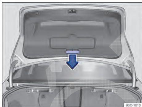
Fig. 221 A partir do compartimento de bagagem: destravar emergencialmente a tampa do compartimento de bagagem (variante 1)
