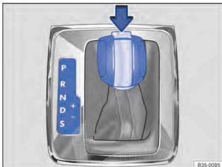
Fig. 147 Veículos com direção à esquerda: alavanca seletora da transmissão automática com botão bloqueador (seta).
