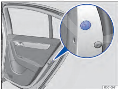
Fig. 219 Na parte dianteira da porta traseira direita: travamento de emergência, coberto por uma vedação de borracha.
