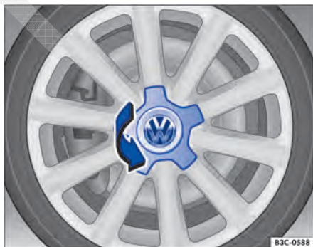
Fig. 230 Virar a calota central.
