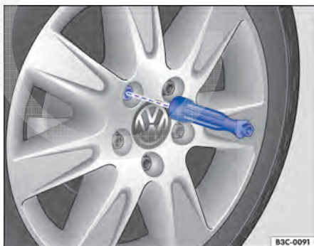
Fig. 241 Troca de roda: desparafusar os parafusos de roda com o punho da chave de fenda.
