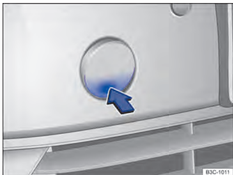
Fig. 260 No para-choque dianteiro à direita: retirar a cobertura.
