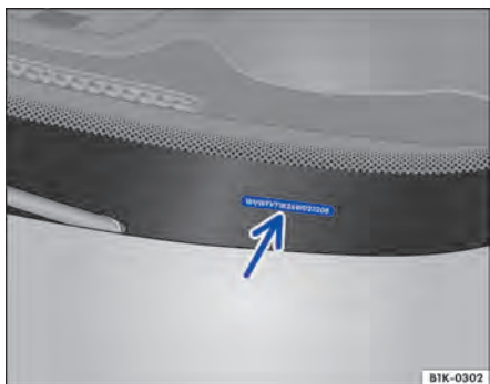
Fig. 18 No para-brisa: número de identificação do veículo.
