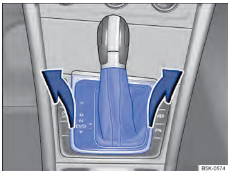
Fig. 225 Desinstalar a cobertura do quadro da alavanca seletora.
