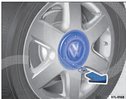
Fig. 229 Retirar a calota central.
