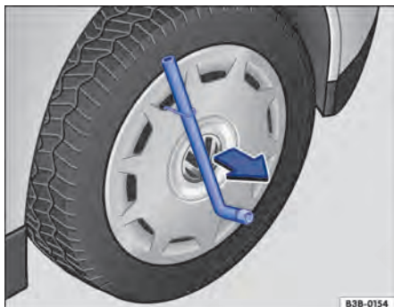
Fig. 231 Retirar a calota integral.
