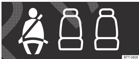
Fig. 61 Indicador de status do cinto de segurança no instrumento combinado para os assentos traseiros.
