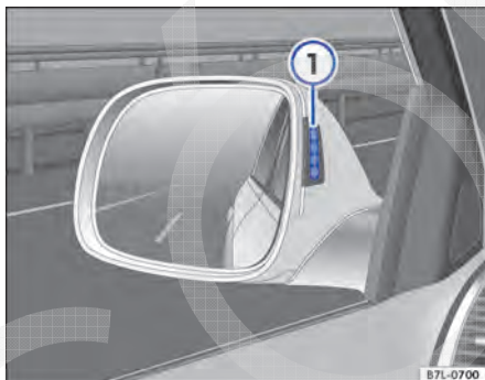
Fig. 182 No espelho retrovisor externo: indicador do assistente de mudança de faixa.
