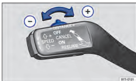
Fig. 175 Alavanca de operação ACC à esquerda na coluna de direção: ajustar o nível de distância.
