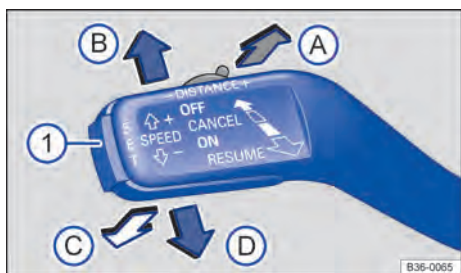
Fig. 174 Alavanca de operação ACC à esquerda na coluna de direção: regular a velocidade.
