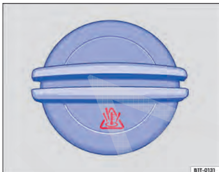
Fig. 204 No compartimento do motor: tampa do reservatório do líquido de arrefecimento do motor.
