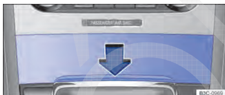
Fig. 131 No console central dianteiro: abrir o cinzeiro.
