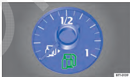
Fig. 193 No instrumento combinado: indicador do nível de combustível para gás natural.
