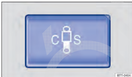
Fig. 185 No console central: botão de ajuste da regulagem dinâmica da suspensão.
