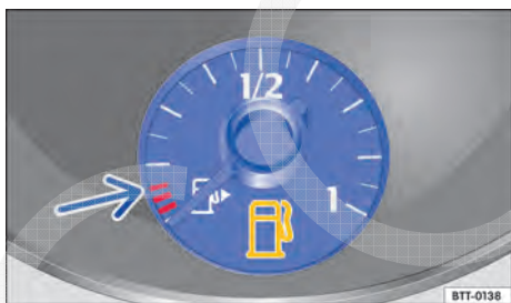
Fig. 192 No instrumento combinado: indicador do nível de combustível para gasolina e óleo diesel.
