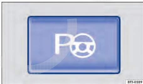
Fig. 166 Na parte inferior do console central: botão para ligar o assistente de direção para estacionamento.
