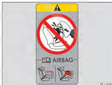
Fig. 80 Na coluna B do lado do passageiro dianteiro: etiqueta adesiva do airbag.
