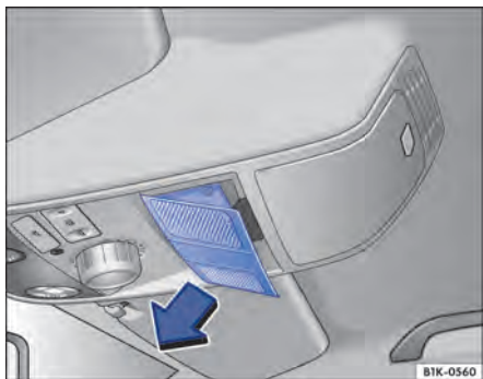
Fig. 223 No revestimento do teto: remover a cobertura.
