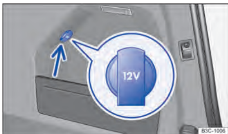
Fig. 135 No compartimento de bagagem: tomada 12 V.
