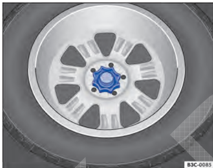
Fig. 212 No compartimento de bagagem: manípulo para fixação da roda sobressalente.
