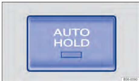
Fig. 155 No console central: botão do Auto Hold.
