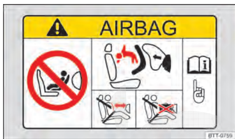
Fig. 79 No para-sol no lado do passageiro dianteiro: etiqueta adesiva de airbag.
