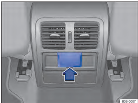
Fig. 138 Console central traseiro: abrir a cobertura dobrável.
