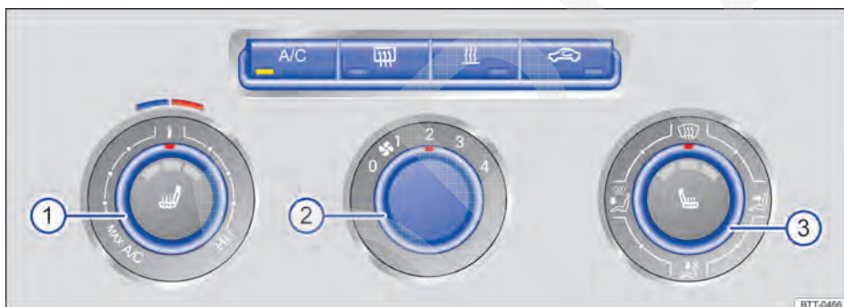
Fig. 187 No console central: comandos do ar-condicionado (manual).
