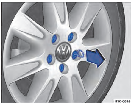
Fig. 232 Remover as capas de cobertura dos parafusos de roda.
