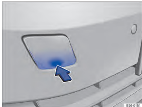
Fig. 317 No para-choque dianteiro à direita: retirar a cobertura.
