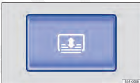
Fig. 112 No console central: botão da cortina de proteção solar do vidro traseiro.
