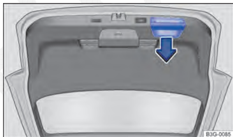
Fig. 50 Passat Variant: tampa do compartimento de bagagem aberta: alça para puxar.
