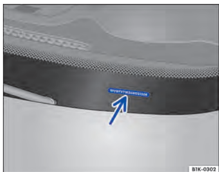
Fig. 322 No para-brisa: número de identificação do veículo.
