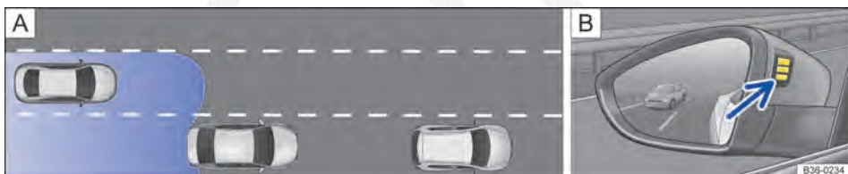
Fig. 238 A Situação de condução ao ultrapassar com o trânsito traseiro. B Indicação visual no espelho retrovisor externo esquerdo.
