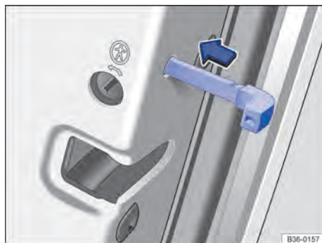
Fig. 283 Na parte dianteira da porta traseira direita: travamento de emergência do veículo com a chave de emergência.
