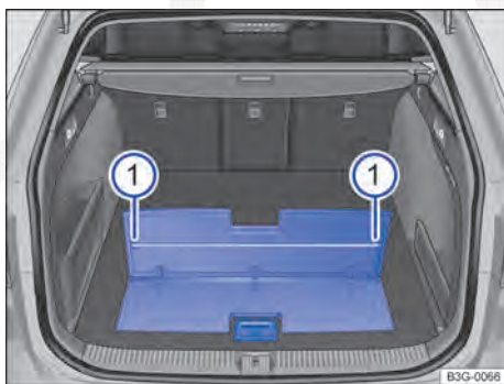
Fig. 146 No compartimento de bagagem: assoalho do compartimento de bagagem dividido.
