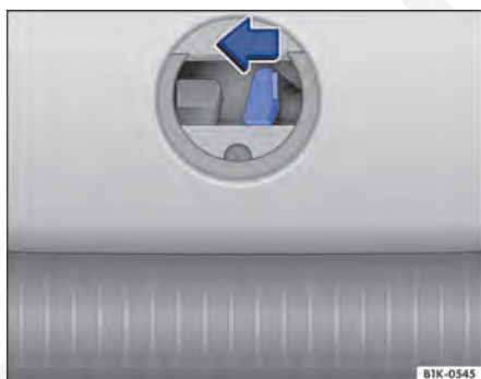
Fig. 285 Pelo compartimento de bagagem: destravar emergencialmente a tampa do compartimento de bagagem.
