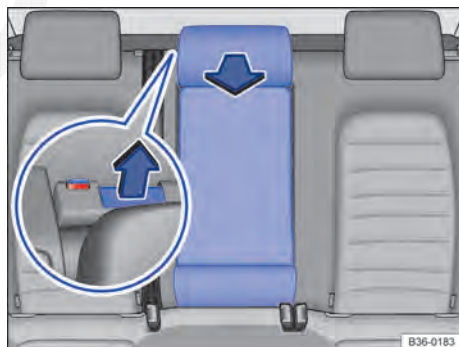
Fig. 132 No encosto do banco traseiro: abrir o dispositivo para transporte de objetos longos. ▶
