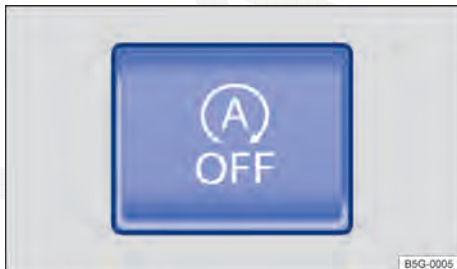
Fig. 195 Na parte inferior do console central: botão do sistema Start-Stop.
