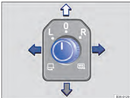
Fig. 123 Na porta do condutor: botão rotativo dos espelhos retrovisores externos.
