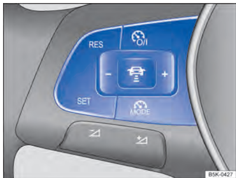
Fig. 226 Lado esquerdo do volante multifunções: botões para comandar o controle automático de distância (ACC).
