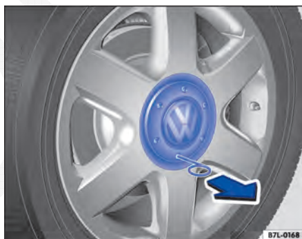
Fig. 289 Retirar a calota central.
