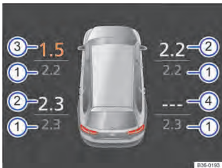
Fig. 268 Representação esquemática da exibição do display do instrumento combinado (Passat Variant): pressões dos pneus atuais.
