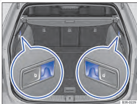
Fig. 138 No compartimento de bagagem: ganchos para sacolas na parte traseira.
