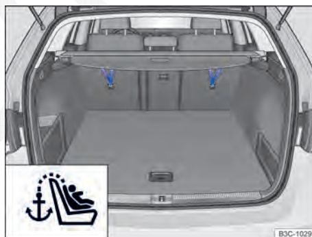
Fig. 103 Cintos de fixação superiores encaixados no compartimento de bagagem (Passat Variant).
