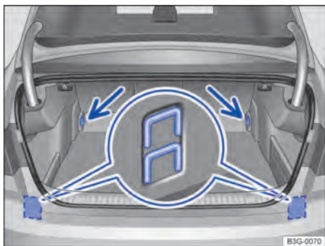
Fig. 133 No compartimento de bagagem: olhais de amarração.
