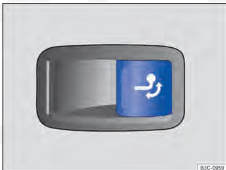
Fig. 153 No compartimento de bagagem, à direita: botão para destravamento da rótula de engate.
