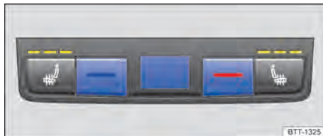
Fig. 247 No console central traseiro: comandos para regular a temperatura para os assentos traseiros.
