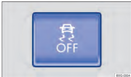
Fig. 187 Na parte inferior do console central: botão para desligar e ligar manualmente o ASR, ASR com ESC ou ESC Sport.
