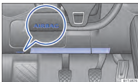
Fig. 95 No lado do condutor: local de instalação do airbag para joelhos.
