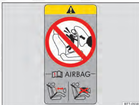
Fig. 98 Representação esquemática: etiqueta de airbag na coluna B.
