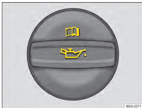
Fig. 261 No compartimento do motor: tampa da abertura de enchimento de óleo do motor.
