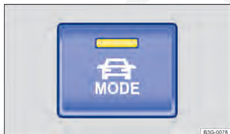
Fig. 244 Na parte inferior do console central: botão de seleção do perfil de condução.
