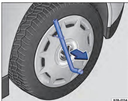
Fig. 291 Retirar a calota integral.
