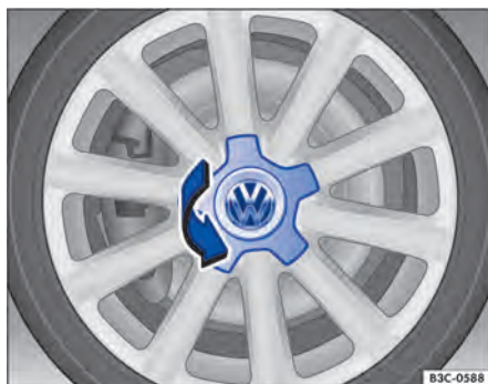
Fig. 290 Virar a calota central.
