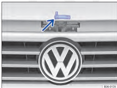
Fig. 259 Acima da grade do radiador: alavanca de abertura da tampa de compartimento do motor
