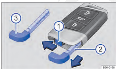
Fig. 33 Chave do veículo: destravamento da chave de emergência.
