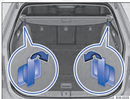
Fig. 137 No compartimento de bagagem: ganchos para sacolas na parte dianteira.
