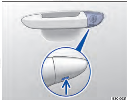
Fig. 281 Maçaneta da porta do condutor: cilindro da fechadura coberto.
