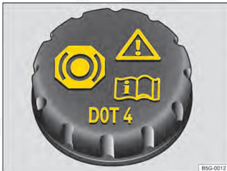
Fig. 188 No compartimento do motor: tampa do reservatório de fluido de freio.
