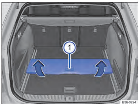
Fig. 148 No compartimento de bagagem: remover o assoalho do compartimento de bagagem deslizante.
