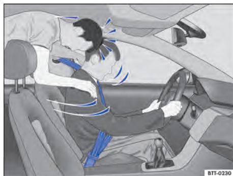
Fig. 80 O passageiro sem cinto de segurança no banco traseiro é lançado para frente sobre o condutor com cinto de segurança.
