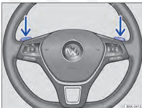
Fig. 184 Volante com 2 seletores basculantes do Tiptronic.
