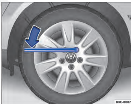
Fig. 293 Troca de roda: soltar os parafusos de roda.
