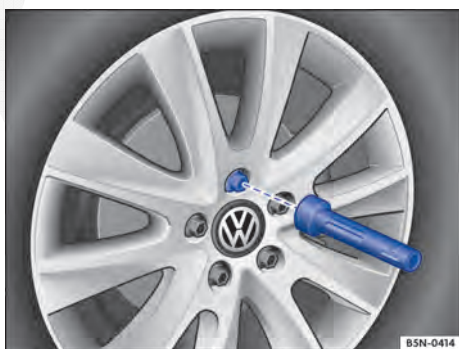
Fig. 299 Troca de roda: desaparafusar os parafusos de roda com o punho da chave de fenda.
