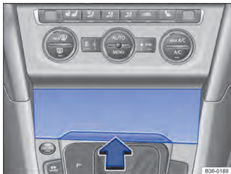
Fig. 168 No console central dianteiro: abrir o cinzeiro.
