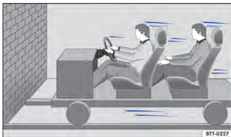
Fig. 77 Um veículo com os ocupantes do veículo sem cintos de segurança está em rota de colisão com um muro.
