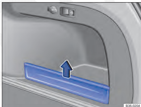
Fig. 164 No compartimento de bagagem: porta-objetos lateral (Passat Variant).
