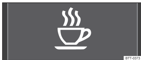
Fig. 243 No display do instrumento combinado: símbolo do sistema de reconhecimento de cansaço.
