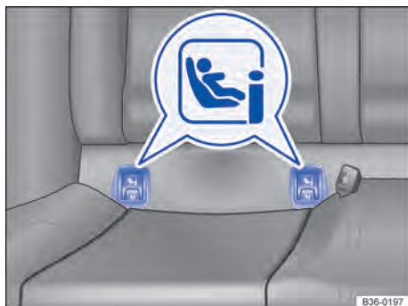
Fig. 100 No banco do veículo: identificação dos pontos de ancoragem ISOFIX para cadeiras de criança.
