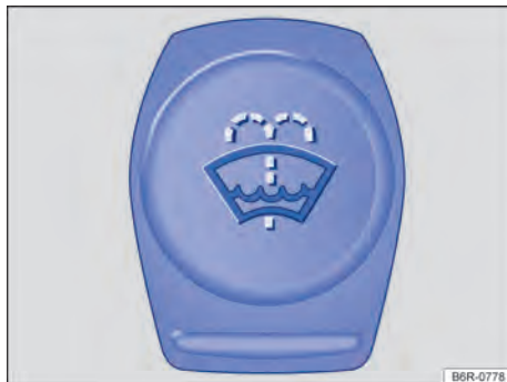
Fig. 120 No compartimento do motor: tampa do reservatório de água dos lavadores dos vidros.
