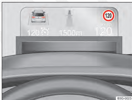
Fig. 25 No painel de instrumentos acima do volante: exemplos de indicações no display Head-up.
