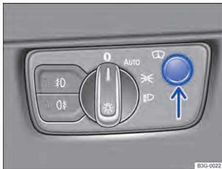
Fig. 24 Ao lado do volante: regulador do display Head-up (seta).
