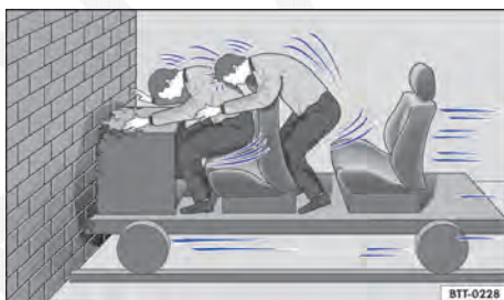
Fig. 78 Um veículo com os ocupantes do veículo sem cintos de segurança colide com o muro.
