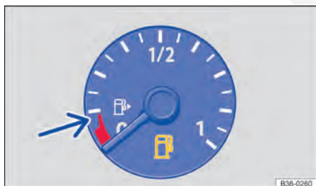
Fig. 252 No instrumento combinado: indicador do nível de combustível para gasolina e óleo diesel.
