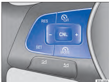
Fig. 220 Lado esquerdo do volante multifunções: botões para comandar o GRA.
