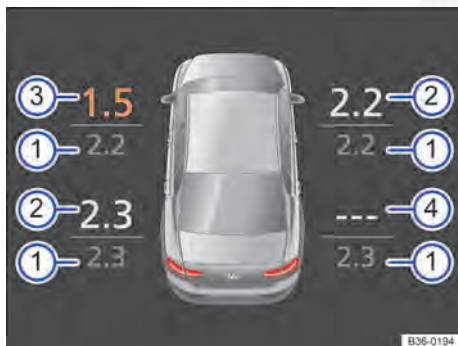
Fig. 267 Representação esquemática da exibição do display do instrumento combinado (Passat): pressões dos pneus atuais.
