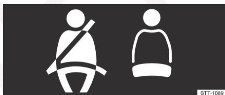
Fig. 76 Indicador de status do cinto de segurança no display do instrumento combinado para os assentos traseiros.
