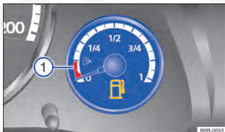
Fig. 99 No instrumento combinado: indicador do nível de combustível (variante 2).
