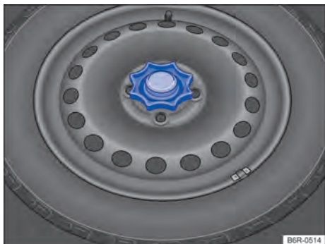
Fig. 116 No compartimento de bagagem: manípulo para fixação da roda de emergência.
