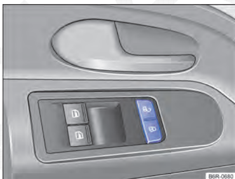
Fig. 21 Na porta do condutor: botão do travamento central.
