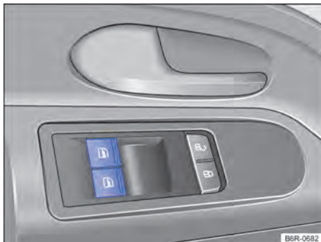
Fig. 27 Na porta do condutor: teclas dos vidros elétricos dianteiros.
