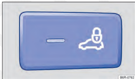
Fig. 18 Luz de controle no painel de instrumentos para indicação do travamento central acionado e/ou indicação do monitoramento do interior do veículo desligado.
