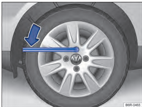
Fig. 136 Troca de roda: soltar os parafusos da roda.
