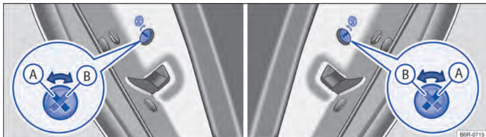
Fig. 51 Nas portas traseiras: trava de segurança para crianças (A) desacionada, (B) acionada.
