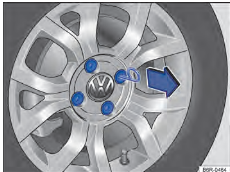
Fig. 135 Retirar as capas de cobertura dos parafusos da roda.
