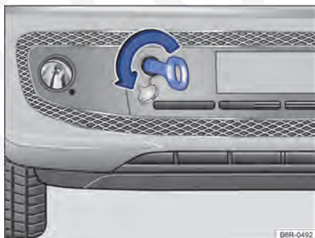
Fig. 153 No para-choque dianteiro à direita: rosquear a argola de reboque.
