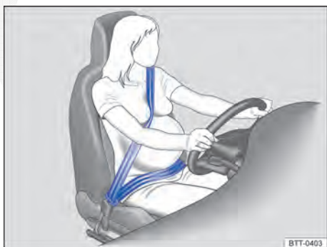
Fig. 43 Posição correta do cadarço do cinto de segurança para mulheres grávidas.
