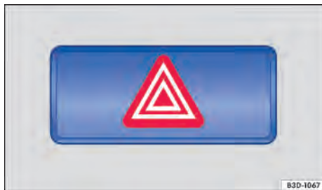
Fig. 124 Na parte superior do console central: interruptor para ligar e desligar as luzes de advertência.
