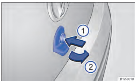
Fig. 25 Abrir a tampa traseira por fora.
