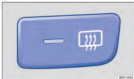
Fig. 97 No console central: botão do desembaçador do vidro traseiro.
