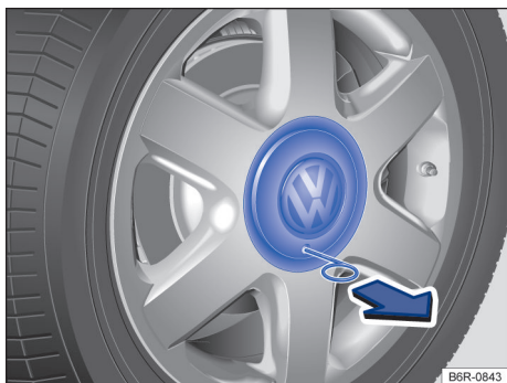
Fig. 142 Retirar a calota central da roda de liga leve.
