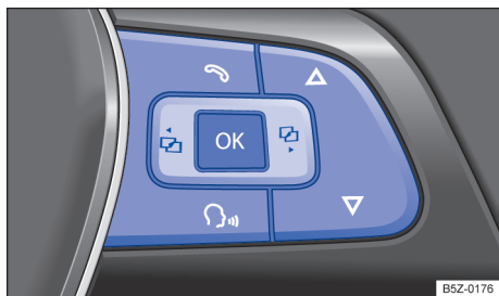
Fig. 17 Lado direito do volante multifunções: teclas de comando dos menus do instrumento combinado.
