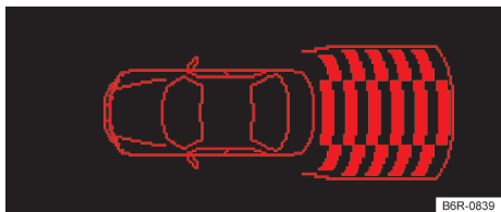
Fig. 86 Exibição do display do controle de distância de estacionamento no rádio.
