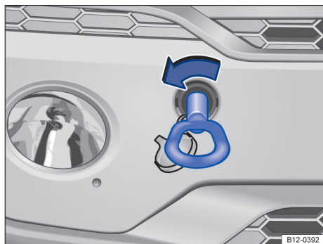
Fig. 125 No para-choque dianteiro à direita: rosquear a argola de reboque.
