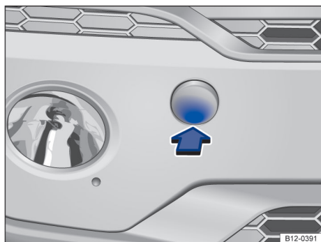
Fig. 124 No para-choque dianteiro à direita: soltar e remover a cobertura.
