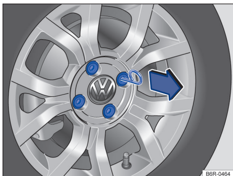
Fig. 144 Retirar as capas de cobertura dos parafusos da roda.
