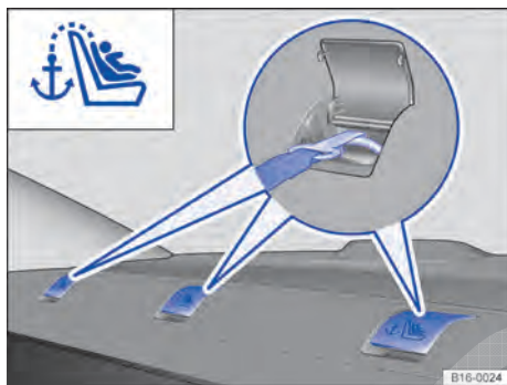
Fig. 8 Olhais de retenção na superfície atrás do encosto do banco traseiro.
