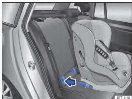
Fig. 8 Representação esquemática: instalar a cadeira de criança ISOFIX com os braços de apoio.
