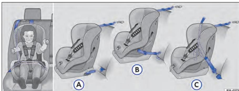
**Fig. 4** No banco traseiro: as figuras (A) e (B) mostram o princípio da fixação do sistema de retenção para crianças nos olhais de retenção inferiores e com o cinto de fixação superior. A figura (C) mostra a fixação do sistema de retenção para crianças com o cinto de segurança do veículo e com o cinto de fixação superior.
