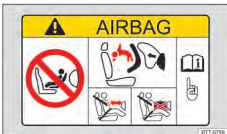
Fig. 6 No para-sol do lado do passageiro dianteiro: etiqueta adesiva do airbag.
