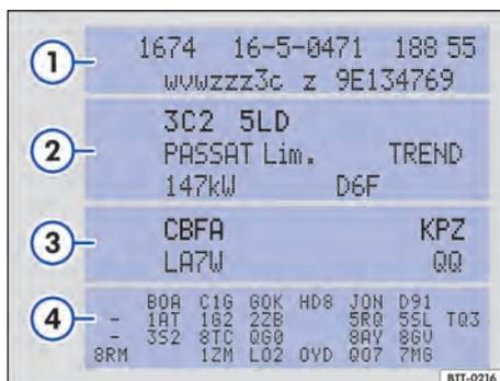
Fig. 1 Etiqueta de dados do veículo: na figura de exemplo, com o código do motor CBFA.
