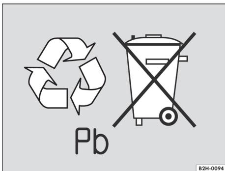
**Fig. 12** As baterias contêm substâncias tóxicas, como ácido sulfúrico e chumbo. Por isso, é proibido o seu descarte / disposição com o lixo doméstico. A legislação determina procedimentos específicos de descarte / disposição de baterias usadas.
