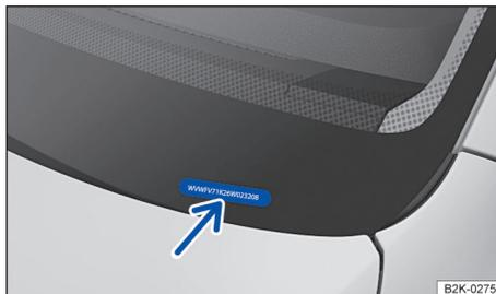
Fig. 2 Na área esquerda do para-brisa: número de identificação do veículo.
