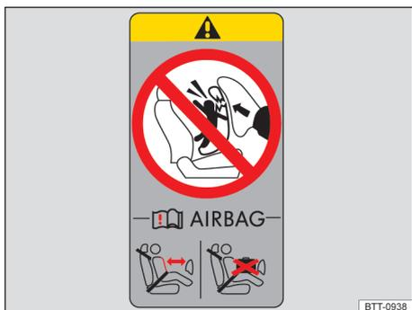
Fig. 7 Na coluna B do lado do passageiro dianteiro: etiqueta adesiva do airbag.
