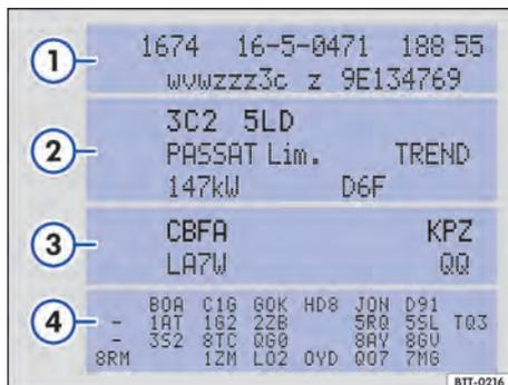
Fig. 1 Etiqueta de dados de veículo: na figura de exemplo, com o código do motor CBFA.
