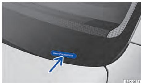
Fig. 2 Na área esquerda do para-brisa: número de identificação do veículo.
