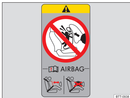
Fig. 6 Na coluna B do lado do passageiro dianteiro: etiqueta adesiva do airbag.
