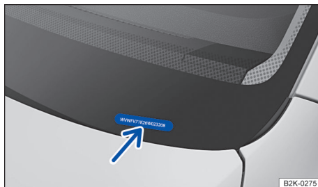
Fig. 18 Na área esquerda do para-brisa: número de identificação do veículo.
