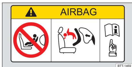
Fig. 5 No para-sol do lado do passageiro dianteiro: etiqueta adesiva do airbag.
