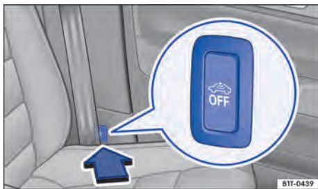
Fig. 64 Ao lado do banco do condutor: botão para desligar o monitoramento do interior do veículo e o alarme antirrebocagem.
