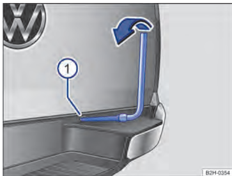
Fig. 203 Controlar a corda de elevação com o guincho.
