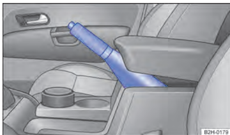
Fig. 118 Entre os assentos dianteiros: freio de estacionamento.
