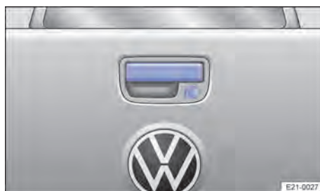
Fig. 65 Na tampa do compartimento de carga: alça para abrir a tampa do compartimento de carga.
