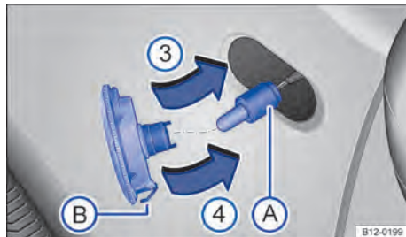
Fig. 162 Lanterna lateral dos indicadores de direção: substituir lâmpada incandescente.
