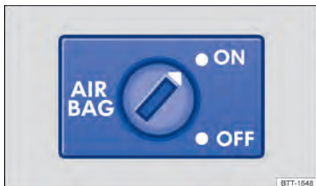
Fig. 49 Na parte frontal no lado do passageiro dianteiro: interruptor acionado pela chave para desativar e ativar o airbag frontal do passageiro dianteiro.
