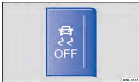
Fig. 124 No console central: botão para desligar e ligar ASR manualmente.
