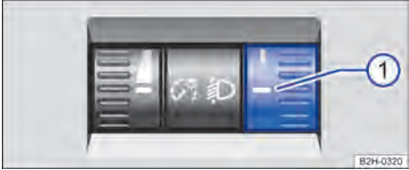
Fig. 89 Ao lado do volante: regulador do alcance do farol ①.
