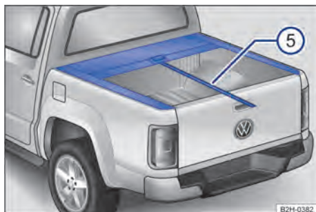
Fig. 68 Capota marítima do compartimento de carga: cinta de tração
