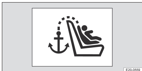
Fig. 56 Representação esquemática: identificação para o ponto de fixação do Top Tether.
