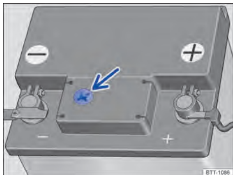
Fig. 191 Visor no lado superior da bateria do veículo 12 V (representação esquemática).
