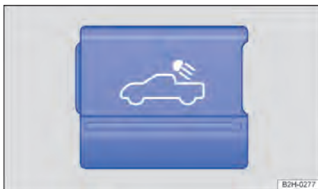
Fig. 91 No console central: botão da iluminação do compartimento de carga.
