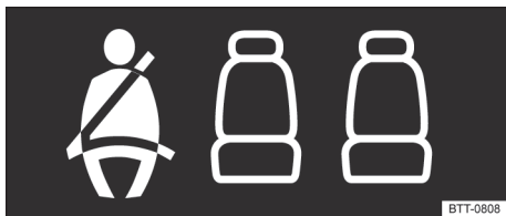
Fig. 31 Indicador de status do cinto de segurança para os assentos traseiros no display do instrumento combinado.
