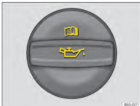
Fig. 186 No compartimento do motor: tampa da abertura para enchimento de óleo do motor (representação esquemática).
