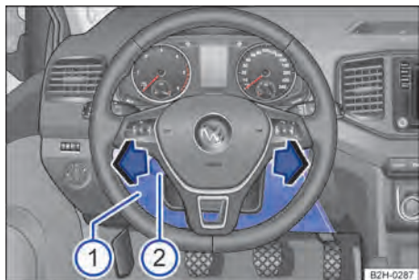
Fig. 168 No lado do condutor, veículos com direção à esquerda: caixa de fusíveis atrás do revestimento do painel de instrumentos.
