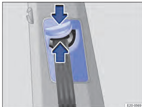
Fig. 45 Ao lado dos bancos dianteiros: regulagem de altura do cinto de segurança.
