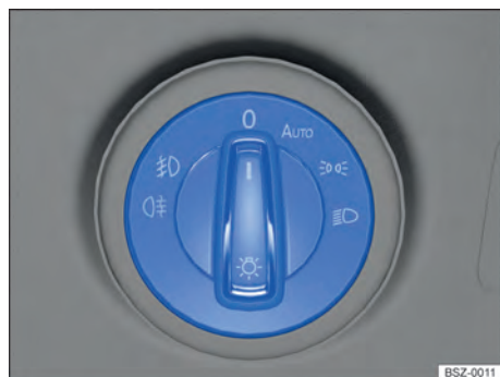
Fig. 86 Ao lado do volante: interruptor de luzes (uma variante).
