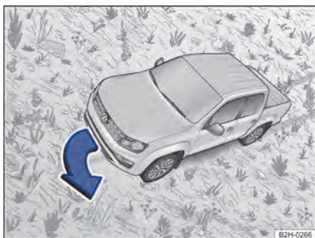
Fig. 114 Representação esquemática: dirigir na linha de inclinação.
