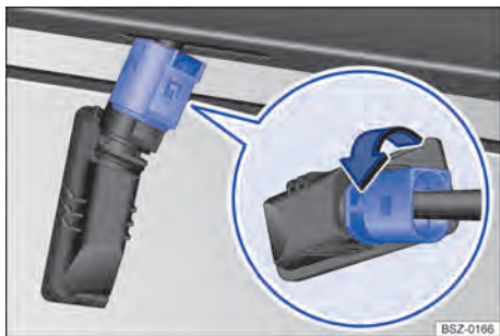
Fig. 164 Lanterna da placa de licença: desinstalar o suporte da lâmpada.
