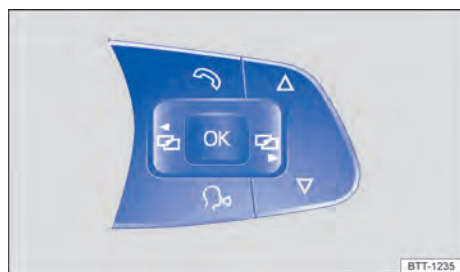
Fig. 12 No volante multifunções: botões para operação dos menus no instrumento combinado.
