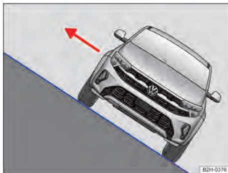
Fig. 115 Representação esquemática: desmontar do lado do veículo voltado para cima da ladeira.
