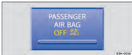
Fig. 46 Na parte superior do console central: luz de controle para o airbag frontal do passageiro dianteiro desligado.
