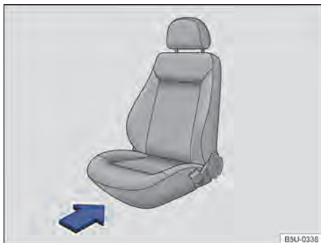
Fig. 60 Na parte frontal do banco do passageiro dianteiro: localização para instalação do suporte do extintor de incêndio.
