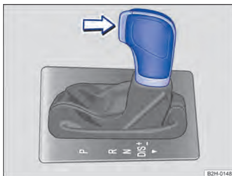
Fig. 105 Volante à esquerda: alavanca seletora da transmissão automática com botão bloqueador (seta). Em veículos com direção à direita, a disposição dos elementos é espelhada.
