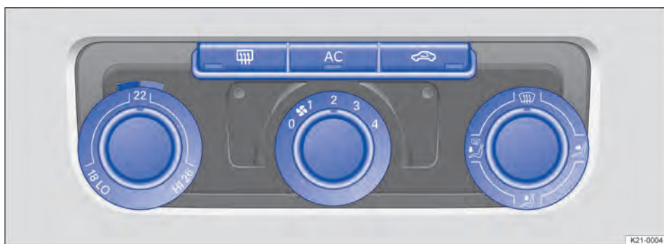
Fig. 100 No painel de instrumentos: elementos de comando do Climatic.
