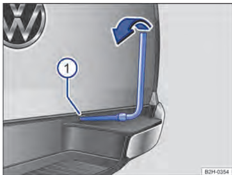
Fig. 209 Colocar a roda sobressalente sobre o guincho.
