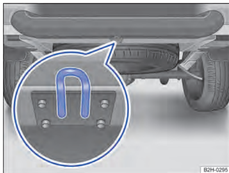
Fig. 174 Abaixo do para-choque: argola de reboque em veículos sem dispositivo de reboque de fábrica.
