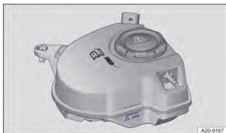
Fig. 188 No compartimento do motor: marca no reservatório de expansão do líquido de arrefecimento do motor (representação esquemática).
