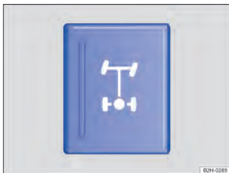
Fig. 113 No console central: botão do bloqueio do diferencial (representação esquemática)
