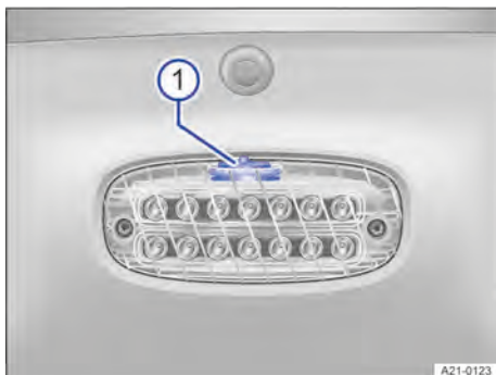
Fig. 92 Sobre a tampa do compartimento de carga: interruptor da iluminação da capota rígida do compartimento de carga.
