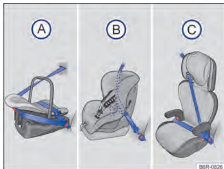
Fig. 53 As ilustrações A, B e C mostram a fixação do sistema de retenção para crianças apenas com o cinto de segurança do veículo.
