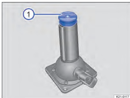
Fig. 215 Depressão no macaco
