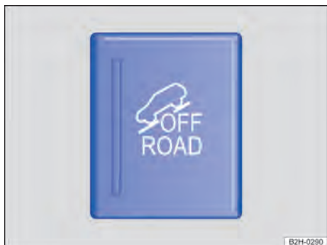
Fig. 110 No console central: botão para ligar e desligar a função off-road manualmente.
