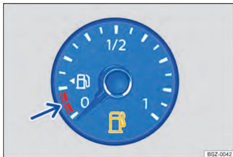
Fig. 14 Indicador do nível de combustível no instrumento combinado analógico (representação esquemática).
