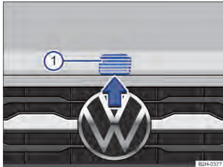
Fig. 179 Acima da grade do radiador: alavanca de acionamento para a tampa do compartimento do motor.
