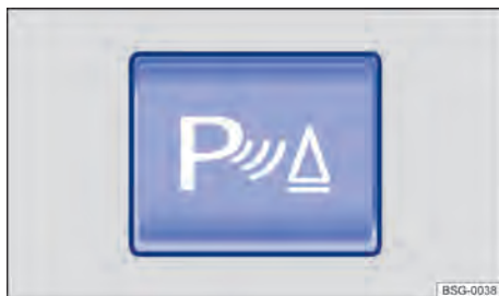
Fig. 120 No console central: botão para ligar ou desligar o auxílio de estacionamento (depende da versão).
