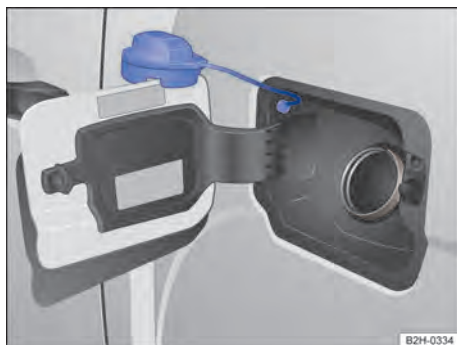
Fig. 151 No lado esquerdo do veículo: portinhola do tanque com tampa do tanque aberta.
