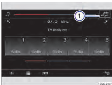
Fig. 129 Exibição do display no console central: superfície de função para acessar o amplificador de voz eletrônico.
