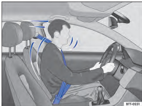
Fig. 36 Condutor protegido pelo cinto de segurança colocado corretamente em uma manobra de frenagem súbita.
