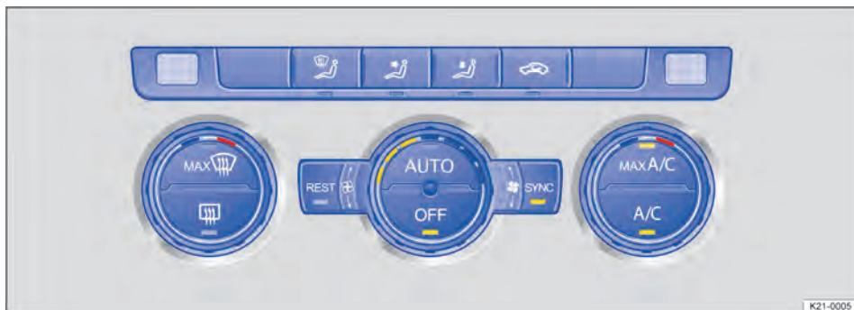
Fig. 101 No painel de instrumentos: elementos de comando do Climatronic.
