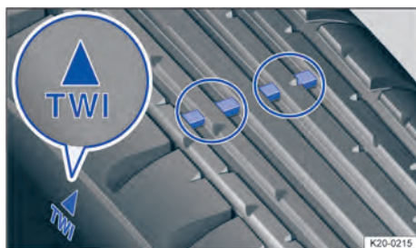
Fig. 197 Perfil do pneu: indicador de desgaste.
