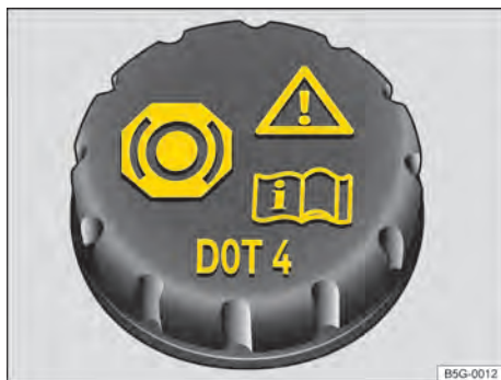
Fig. 190 No compartimento do motor: tampa do reservatório do fluido de freio.
