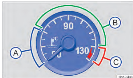
Fig. 15 Indicador da temperatura do líquido de arrefecimento do motor no instrumento combinado analógico (representação esquemática).
