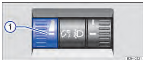
Fig. 90 Ao lado do volante: regulador da regulação da iluminação dos instrumentos e dos interruptores.
