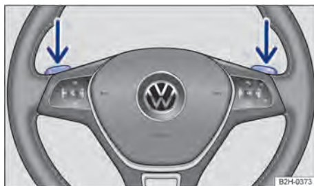
Fig. 107 Volante com seletores basculantes do Tiptronic.
