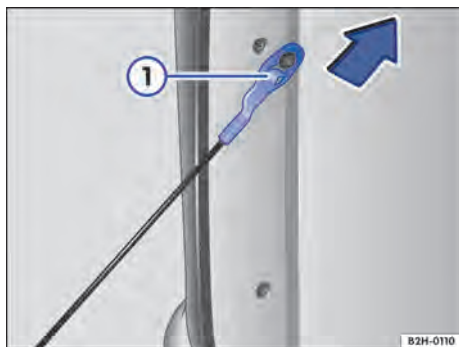
Fig. 66 Desprender os cabos de sustentação da tampa do compartimento de carga.
