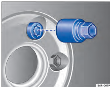
Fig. 201 Troca de roda: parafusos de roda antifurto e adaptador.
