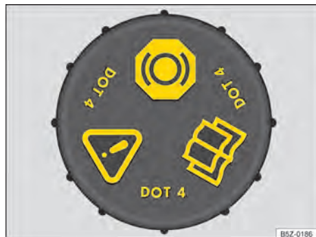
Fig. 183 No compartimento do motor: tampa do reservatório de fluido de freio (variante 2).
