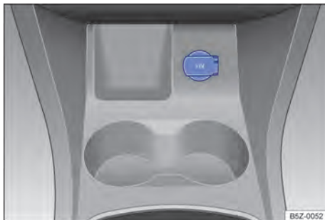
Fig. 108 No console central dianteiro: tomada 12 V.
