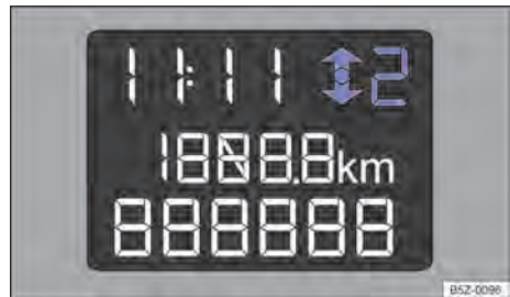
Fig. 84 No instrumento combinado: indicador de troca de marcha (variante 2).
