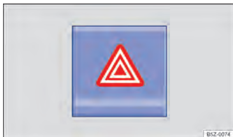
Fig. 40 Na parte superior do console central: interruptor para ligar e desligar as luzes de advertência. ▶
