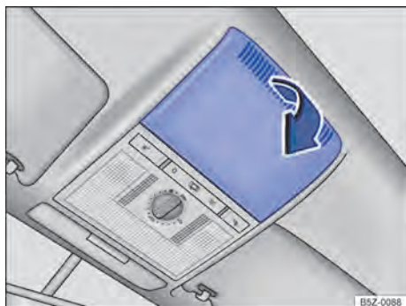
Fig. 58 No revestimento do teto: remover a cobertura.
