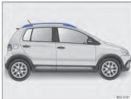
Fig. 142 Suportes longitudinais do bagageiro do teto (ambos os lados)
