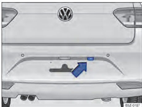
Fig. 95 No para-choque traseiro: local de instalação do assistente de condução em marcha a ré.
