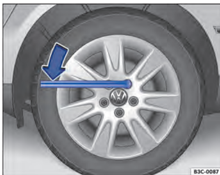
Fig. 194 Troca de roda: soltar os parafusos da roda.
