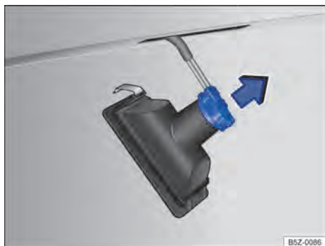
Fig. 160 Lanterna da placa de licença: remover o soquete da lâmpada.
