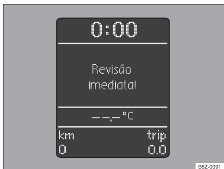
Fig. 15 Display do instrumento combinado: indicador do intervalo de serviço.
