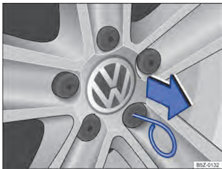
Fig. 192 Retirar as capas de cobertura dos parafusos da roda.
