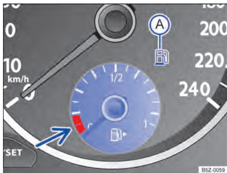
Fig. 13 No instrumento combinado: indicador do nível de combustível.
