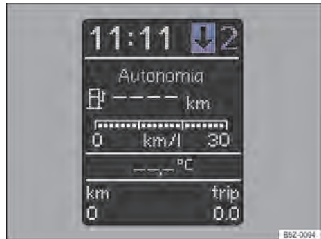
Fig. 83 No instrumento combinado: indicador de troca de marcha (variante 1).
