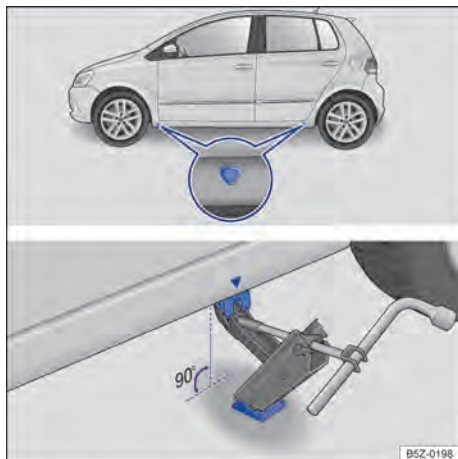
Fig. 195 Pontos de apoio do macaco e macaco posicionado no lado esquerdo traseiro do veículo.
