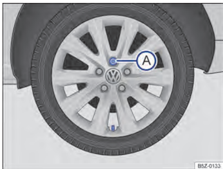
Fig. 193 Retirar a calota integral.
