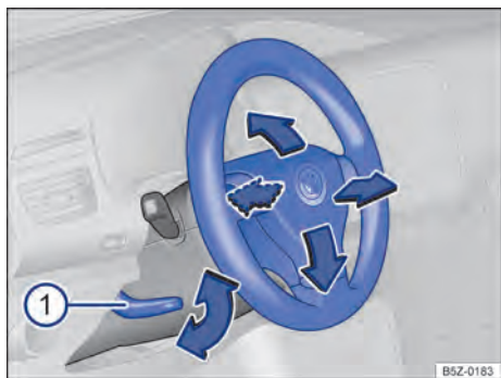
Fig. 60 Ajustar a posição do volante.
