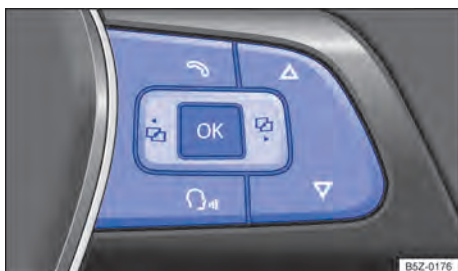
Fig. 18 Lado direito do volante multifunções: botões para comando dos menus do instrumento combinado.
