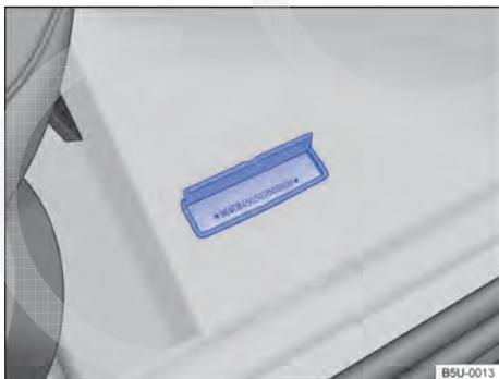
**Fig. 176** Em frente ao banco do passageiro dianteiro: número de identificação do veículo (número do chassi) no assoalho, em frente ao banco do passageiro dianteiro.
