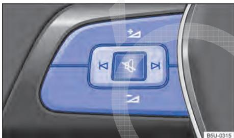
**Fig. 42** Lado esquerdo do volante multifunções: teclas de comando.
