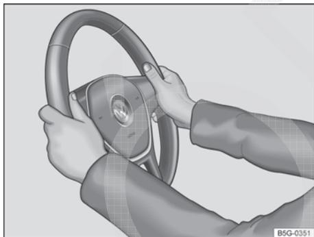
Fig. 61 No volante: posição 9 e 3 horas.
