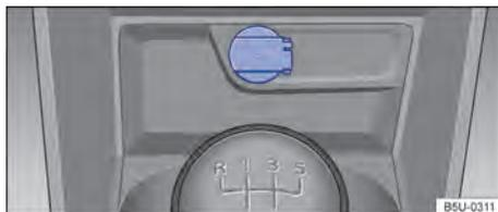
Fig. 119 No console central dianteiro: tomada 12 V.
