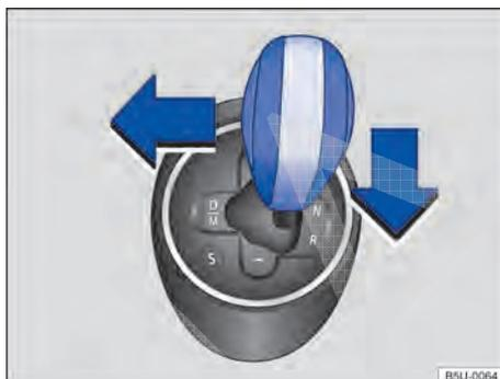
**Fig. 94** Alavanca seletora da transmissão automatizada ASG.
