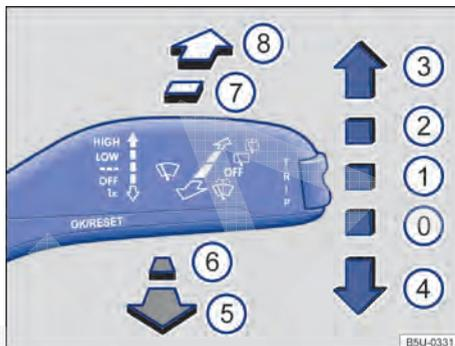
Fig. 72 Comandar os limpadores / lavadores do para-brisa e o limpador / lavador do vidro traseiro.
