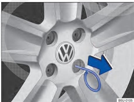
Fig. 164 Retirar as capas de cobertura dos parafusos da roda.
