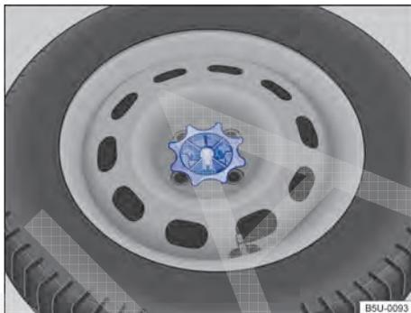
**Fig. 162** No compartimento de bagagem: manípulo para fixação da roda de emergência.
