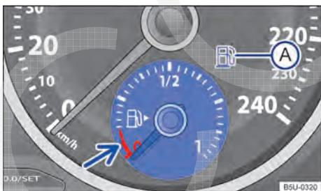
Fig. 36 No instrumento combinado: indicador do nível de combustível (variante 2).
