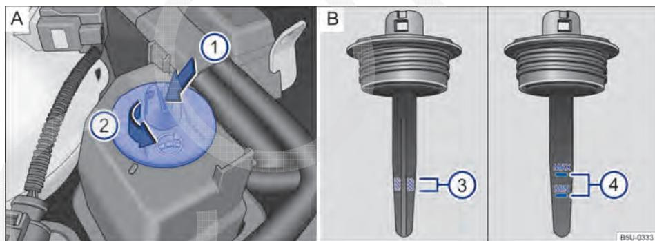
**Fig. 99** No compartimento do motor (variante 1): **A** Reservatório do fluido da direção hidráulica. **B** Marcações para controle do nível do fluido da direção hidráulica.
