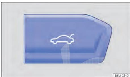
Fig. 56 Na parte superior do console central: tecla de abertura da tampa traseira.
