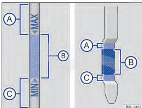
Fig. 151 Vareta de medição do óleo com marcas de nível do óleo do motor.
