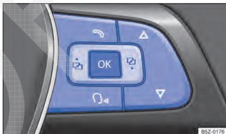
**Fig. 43** Lado direito do volante multifunções: teclas de comando.
