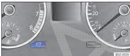
**Fig. 71** No instrumento combinado: tecla de regulação da iluminação dos instrumentos e dos interruptores.
