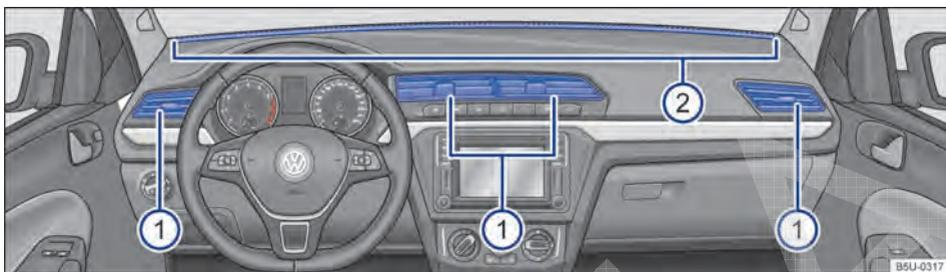
Fig. 83 No painel de instrumentos: difusores de ar.
