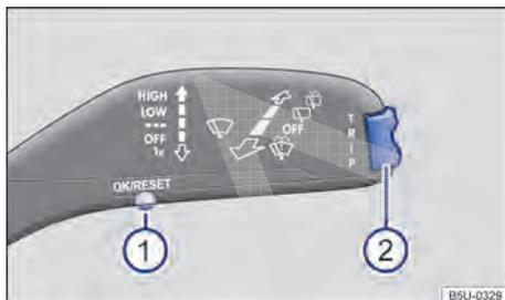
**Fig. 40** Veículos sem volante multifunções: tecla **1** na alavanca dos limpadores dos vidros para confirmação dos itens de menu e chave **2** para alternar entre os menus.
