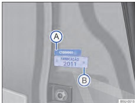
**Fig. 177** Na coluna da porta dianteira direita: etiqueta com o número de identificação do veículo parcial (A) e etiqueta de identificação do ano de fabricação (B).
