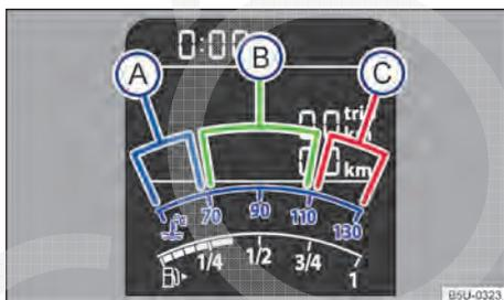
**Fig. 37** Indicador de temperatura do líquido de arrefecimento do motor no instrumento combinado (variante 1): (A) área fria; (B) área normal; (C) área de alerta.
