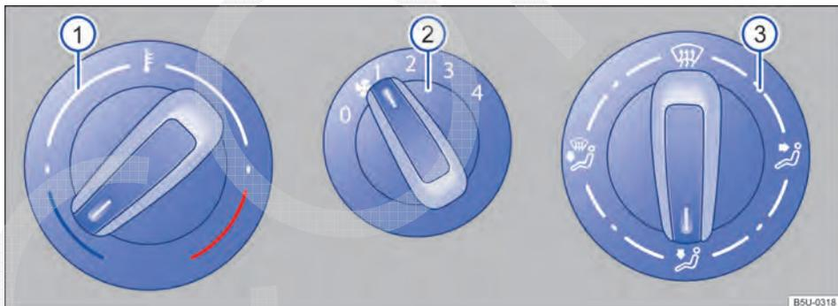
Fig. 81 Comandos do sistema de ventilação e aquecimento.
