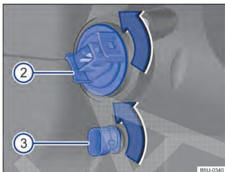
**Fig. 132** No compartimento do motor: vista traseira do farol dianteiro **2** indicadores de direção e **3** luz de posição.
