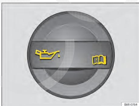
Fig. 152 No compartimento do motor: tampa da abertura para enchimento de óleo do motor.
