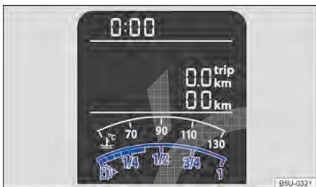
Fig. 35 No display do instrumento combinado: indicador do nível de combustível (variante 1).
