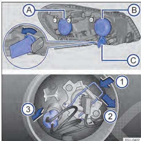
**Fig. 133** No compartimento do motor: vista traseira do farol dianteiro com cobertura de borracha (lado esquerdo da ilustração) - **A** farol baixo, **B** farol alto e luz de posição, e **C** indicador de direção. Vista traseira do farol dianteiro sem a cobertura de borracha (lado direito da ilustração): **1** mola de travamento da lâmpada incandescente do farol e **2** luz de posição.
