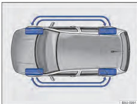
Fig. 159 Esquema para a troca das rodas.
