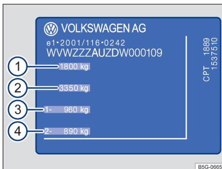
Fig. 19 Etiqueta de identificação da capacidade de carga máxima.
