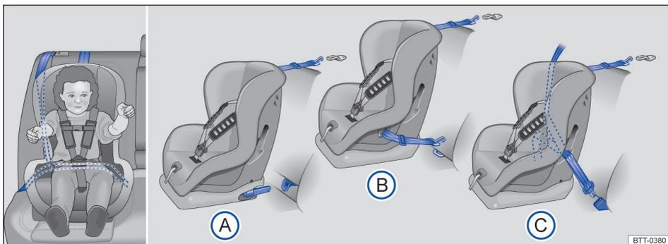
**Fig. 3** No banco traseiro: as figuras (A) e (B) mostram o princípio da fixação do sistema de retenção para crianças nos olhais de retenção inferiores e com o cinto de fixação superior. A figura (C) mostra a fixação do sistema de retenção para crianças com o cinto de segurança do veículo e com o cinto de fixação superior.
