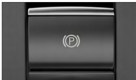
Fig. 123 No console central: botão do freio de estacionamento eletrônico (transmissão automática).
