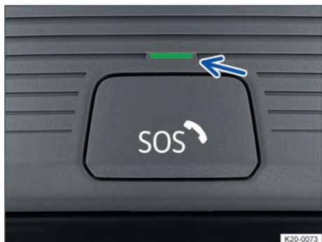
Fig. 45 No console do teto: botão do sistema de chamada de emergência eCall obrigatório por lei (atrás da cobertura dos botões) e luz de controle.
