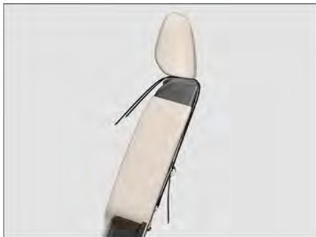
Fig. 40 No lado de trás dos bancos traseiros externos ou do banco do passageiro dianteiro: cinto de fixação superior preso.
