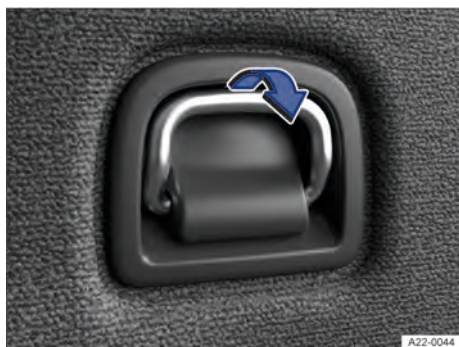
Fig. 159 No compartimento de bagagem: olhal de amarração rebatível (representação esquemática).
