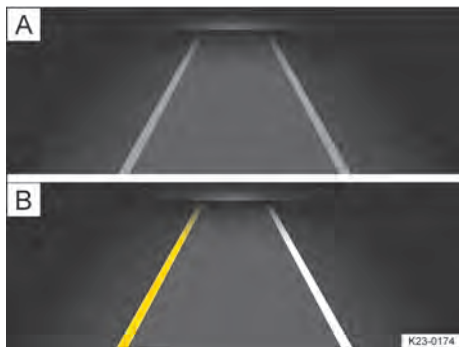
Fig. 116 No display do instrumento combinado: indicadores de display do Lane Assist.
