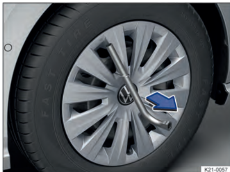
Fig. 227 Retirar a calota integral.
