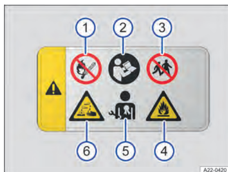
Fig. 217 Placa de advertência na bateria do veículo 48 V.
