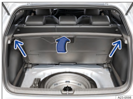
Fig. 156 No compartimento de bagagem: rebater para cima o assoalho variável do compartimento de bagagem.
