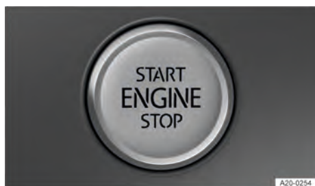
Fig. 96 Na parte inferior do console central: botão de partida em veículos com transmissão manual.
