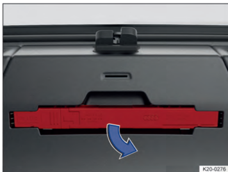
Fig. 41 Na tampa traseira: suporte para o triângulo de segurança.
