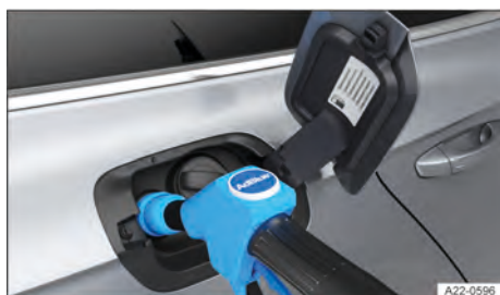
Fig. 178 Atrás da portinhola do tanque: reabastecer o AdBlue com o bico da bomba (representação esquemática).
