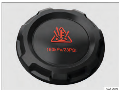
Fig. 213 No compartimento dianteiro: tampa do reservatório de expansão do líquido de arrefecimento (representação esquemática).
