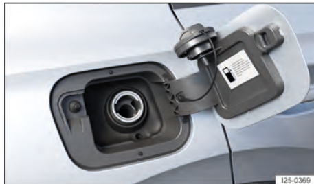
Fig. 175 Atrás da portinhola do tanque: tampa do tanque (representação esquemática).
