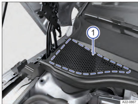
Fig. 244 Entre o compartimento dianteiro e o para-brisa: caixa coletora de água (representação esquemática).
