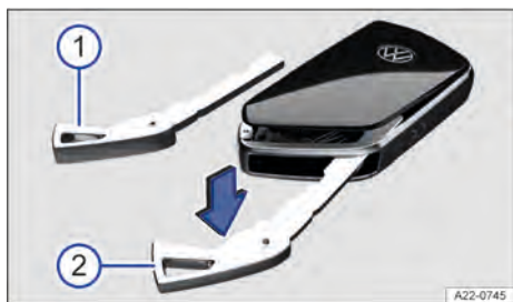
Fig. 49 Chave do veículo: abrir a tampa do compartimento da bateria.
