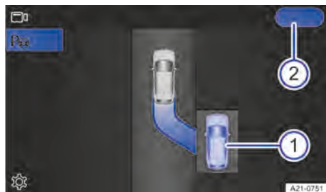
Fig. 136 Sistema Infotainment: processo de saída da vaga de estacionamento (representação esquemática).
