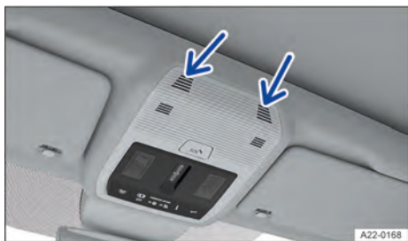
Fig. 56 No console do teto: sensores do monitoramento do interior do veículo (setas).
