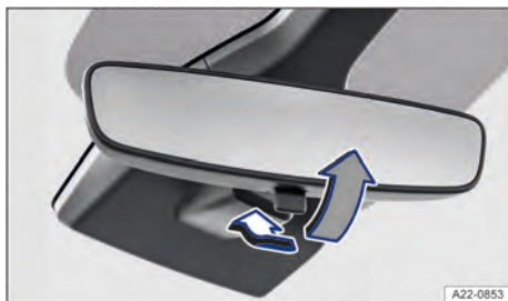
Fig. 87 No para-brisa: espelho retrovisor interno com antiofuscante manual.
