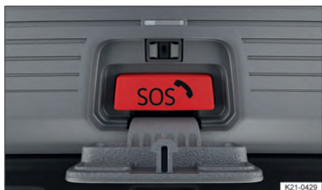
Fig. 46 No console do teto: botão do sistema de chamada de emergência eCall obrigatório por lei.
