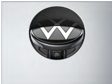
Fig. 245 Na traseira do veículo: câmera de marcha a ré no logo Volkswagen (representação esquemática).
