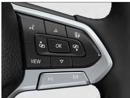
Fig. 13 Lado direito do volante multifunções: comandar o Digital Cockpit (representação esquemática).
