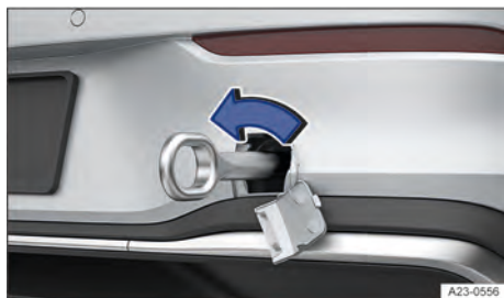
Fig. 201 No para-choque traseiro à direita: rosquear a argola de reboque.
