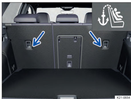
Fig. 37 No lado de trás do banco traseiro: pontos de ancoragem Top Tether do cinto de fixação superior.
