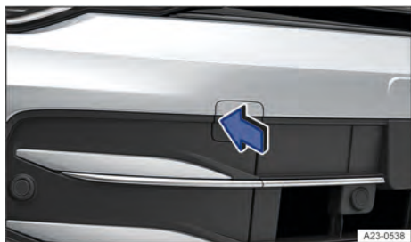
Fig. 196 No para-choque dianteiro à direita: desmontar a cobertura da variante 1.
