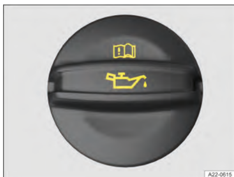
Fig. 210 No compartimento dianteiro: tampa da abertura de enchimento de óleo do motor (representação esquemática).
