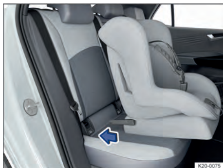
Fig. 36 Instalar a cadeira de criança com braços de apoio (representação esquemática).
