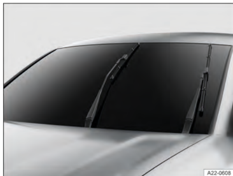
Fig. 182 Para-brisa: limpadores dos vidros na posição de serviço (representação esquemática).
