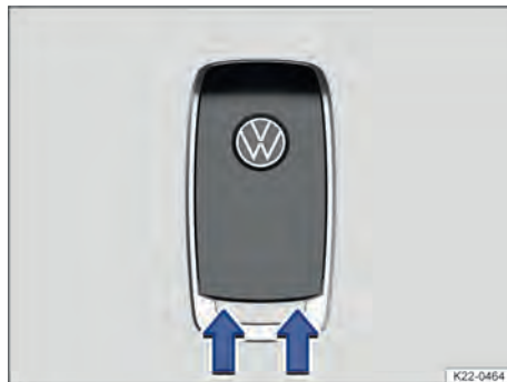
Fig. 91 Controle remoto: tampa do compartimento da bateria.
