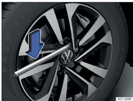
Fig. 234 Remover os parafusos de roda com a chave da roda.
