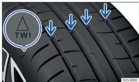
Fig. 223 Nos sulcos do perfil: indicador de desgaste.
