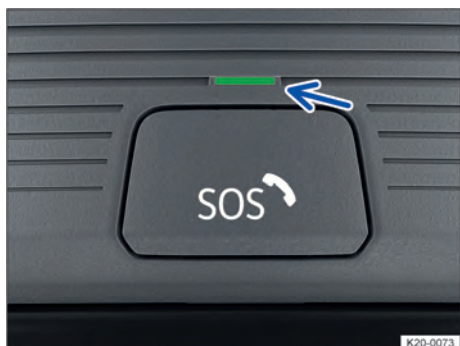
Fig. 42 No console do teto: botão para serviço de chamada de emergência (atrás da cobertura dos botões) e luz de controle.
