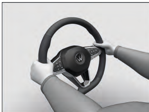
Fig. 61 No volante: posição de nove horas e três horas (representação esquemática).
