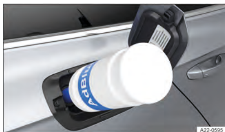
Fig. 177 Atrás da portinhola do tanque: reabastecer o AdBlue com o frasco de reabastecimento (representação esquemática).
