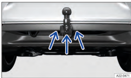
Fig. 163 No dispositivo de reboque: olhal para fixação do cabo de segurança ou de ruptura (representação esquemática).
