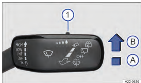
Fig. 85 À direita da coluna de direção: alavanca dos limpadores dos vidros.
