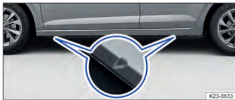
Fig. 230 Na longarina lateral: marcas dos pontos de apoio e do macaco.
