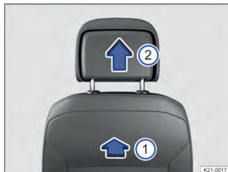
Fig. 69 Desinstalar o apoio para cabeça dianteiro (representação esquemática).
