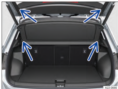
Fig. 154 No compartimento de bagagem: remover e instalar a cobertura do compartimento de bagagem (representação esquemática).
