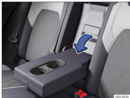
Fig. 161 No encosto do banco traseiro: dispositivo para transporte de objetos longos (representação esquemática).
