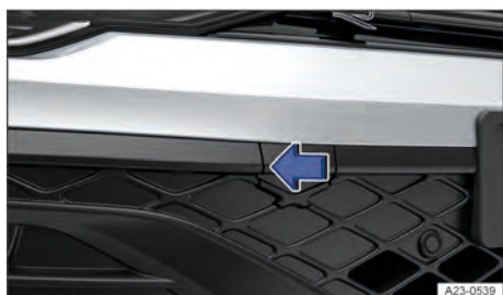
Fig. 197 No para-choque dianteiro à direita: desmontar a cobertura da variante 2.
