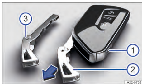
Fig. 48 Chave do veículo: destravamento da chave de emergência (representação esquemática).
