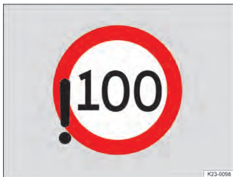
Fig. 20 No display do instrumento combinado digital: detectada ultrapassagem da velocidade máxima permitida (representação esquemática).
