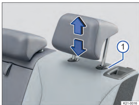
Fig. 68 Ajustar o apoio para cabeça traseiro (representação esquemática).
