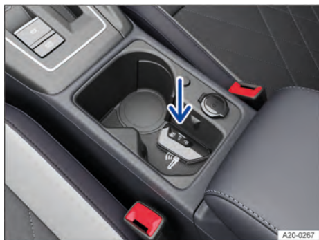
Fig. 97 No console central: função de partida de emergência.
