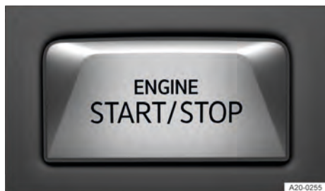
Fig. 95 Na parte inferior do console central: botão de partida em veículos com transmissão de dupla embreagem DSG.
