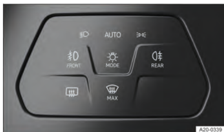
Fig. 77 Ao lado do volante: painel de controle para ligar a iluminação externa (modelos com farol de neblina).
