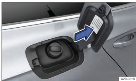
Fig. 169 No lado interno da portinhola do tanque: placa de indicação de combustível (representação esquemática).
