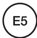
Fig. 170 Identificação para gasolina com 5% de etanol.
