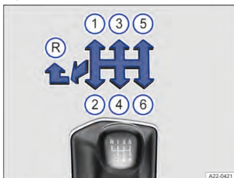
Fig. 98 Esquema de troca de marchas da transmissão manual de 6 marchas. Dependendo da versão, seu veículo pode dispor de uma transmissão manual de 5 marchas.
