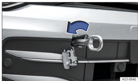
Fig. 198 No para-choque dianteiro à direita: rosquear a argola de reboque da variante 1.
