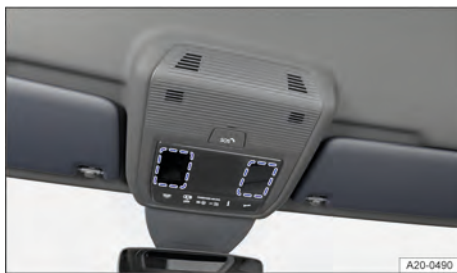
Fig. 82 No console do teto: lanterna de leitura sensível ao toque.
