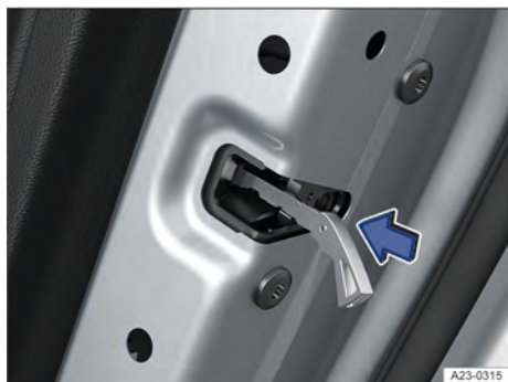
Fig. 54 Na parte dianteira de uma porta: travamento de emergência do veículo com a chave de emergência (representação esquemática).
