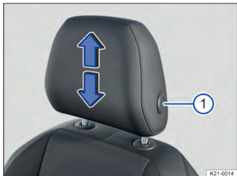
Fig. 67 Ajustar o apoio para cabeça dianteiro (representação esquemática).
