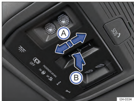
Fig. 59 No revestimento do teto: painel de controle do teto solar panorâmico.
