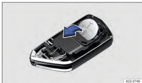
Fig. 50 Chave do veículo: trocar a pilha-botão.
