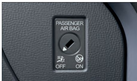
Fig. 29 No painel de instrumentos no lado do passageiro dianteiro: interruptor acionado pela chave para desligar e ligar o airbag frontal do passageiro dianteiro.
