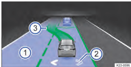
Fig. 120 No display do instrumento combinado: indicadores da mudança de faixa assistida (representação esquemática).
