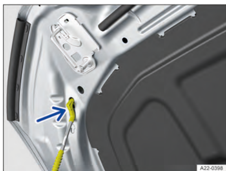
Fig. 205 Na tampa dianteira: alojamento para a haste de sustentação da tampa (representação esquemática).
