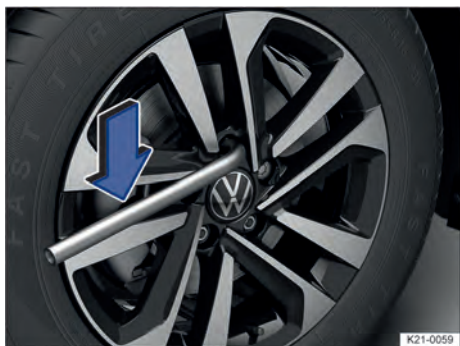
Fig. 229 Soltar os parafusos de roda.
