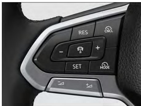
Fig. 112 Lado esquerdo do volante multifunções.
