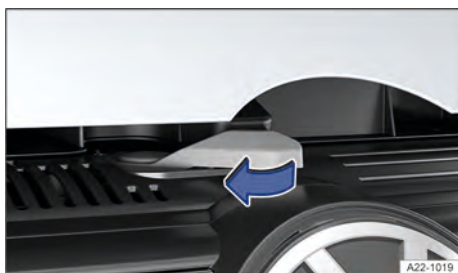
Fig. 203 Acima da grade do radiador: alavanca de comando da tampa dianteira (representação esquemática).
