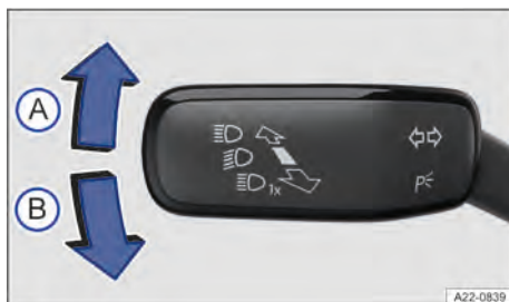
Fig. 75 À esquerda na coluna de direção: alavanca dos indicadores de direção e do farol alto.
