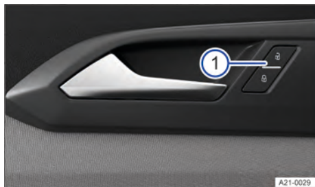
Fig. 53 Na porta do condutor: botão do travamento central (representação esquemática).
