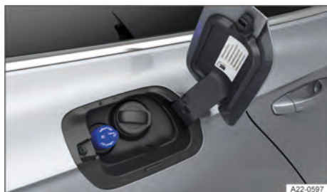
Fig. 176 Atrás da portinhola do tanque: tampa do tanque para AdBlue (representação esquemática).
