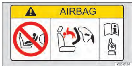
Fig. 34 No para-sol: etiqueta do airbag (representação esquemática).
