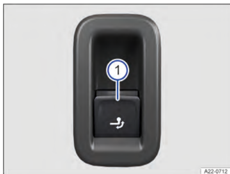
Fig. 164 No compartimento de bagagem, à direita: botão para destravamento do dispositivo de reboque.
