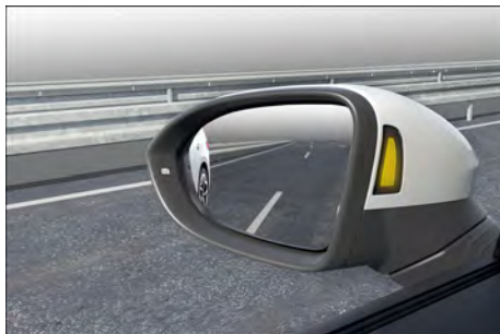
Fig. 121 Nas carcaças dos espelhos retrovisores externos: indicadores do Side Assist.
