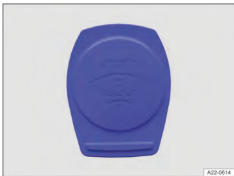
Fig. 207 No compartimento dianteiro: tampa do reservatório de água dos lavadores dos vidros (representação esquemática).
