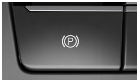
Fig. 122 No console central: botão do freio de estacionamento eletrônico (transmissão manual).
