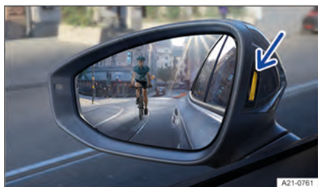
Fig. 124 Na carcaça dos espelhos retrovisores externos: exibição do alerta de saída do veículo (representação esquemática).
