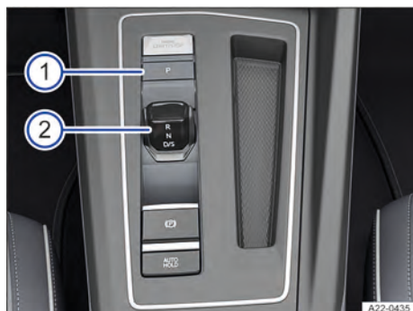
Fig. 99 No console central: alavanca seletora da transmissão automática.
