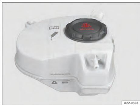
Fig. 214 No compartimento dianteiro: marcas no reservatório de expansão do líquido de arrefecimento (representação esquemática).
