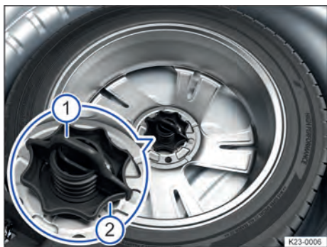
Fig. 226 Sob o assoalho do compartimento de bagagem: manípulo de fixação da roda sobressalente.
