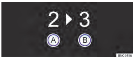
Fig. 101 No display do instrumento combinado: recomendação de marcha.
