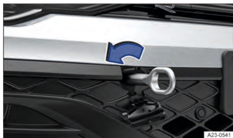
Fig. 199 No para-choque dianteiro à direita: rosquear a argola de reboque da variante 2.
