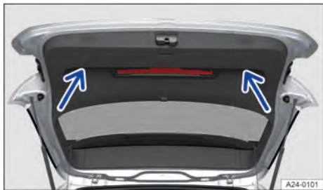
Fig. 57 Na tampa traseira aberta: rebaixo para fechar a tampa traseira.
