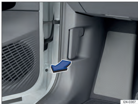
Fig. 202 Na área para os pés no lado do condutor: alavanca de destravamento da tampa dianteira (representação esquemática).
