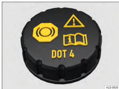
Fig. 215 No compartimento dianteiro: tampa do reservatório do fluido de freio.
