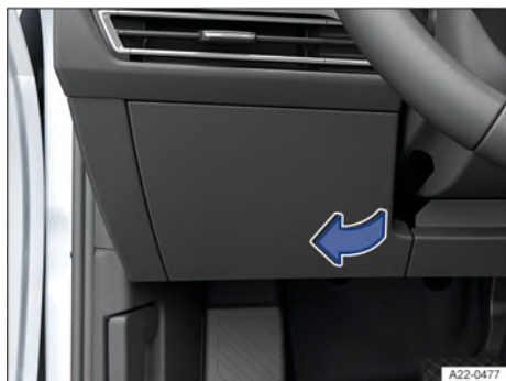
Fig. 187 No lado do condutor: cobertura da caixa de fusíveis no painel de instrumentos (veículos com direção à esquerda).
