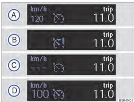
Fig. 133 No display do instrumento combinado: indicadores de status do GRA (representação esquemática).
