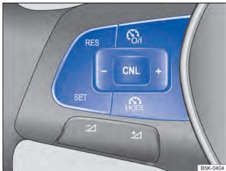
**Fig. 138** Lado esquerdo do volante multifunções: botões para comandar o limitador de velocidade.
