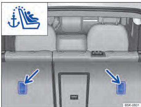
**Fig. 54** Olhais de retenção para o cinto de fixação superior no lado de trás do banco traseiro.
