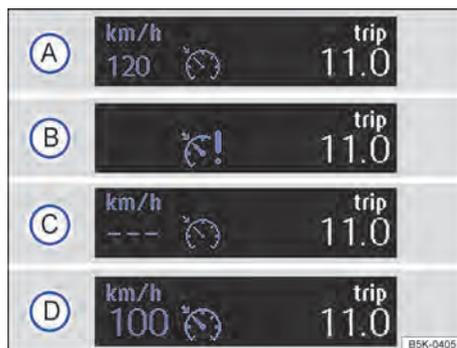
**Fig. 135** No display do instrumento combinado: indicadores de status do GRA (representação esquemática).
