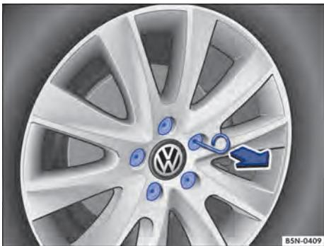
Fig. 241 Remover as capas de cobertura dos parafusos de roda.
