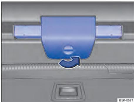
Fig. 75 Na tampa do compartimento de bagagem: abrir o suporte para o triângulo de segurança.
