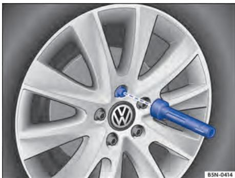
**Fig. 250** Troca de roda: desaparafusar os parafusos de roda com o punho da chave de fenda.
