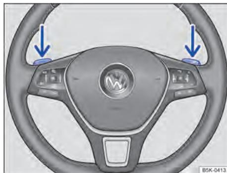
Fig. 125 Volante com seletores basculantes do Tiptronic.
