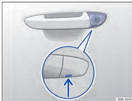
Fig. 69 Maçaneta da porta do condutor: cilindro da fechadura coberto.
