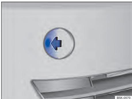
Fig. 218 No para-choque dianteiro à direita: remover a cobertura.
