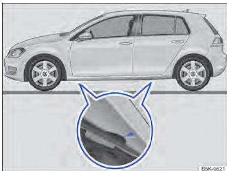
Fig. 246 Pontos de apoio do macaco.
