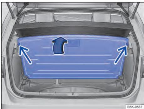
**Fig. 187** No compartimento de bagagem: dobrar o assoalho variável do compartimento de bagagem para cima.
