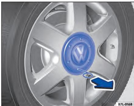
Fig. 238 Retirar a calota central.
