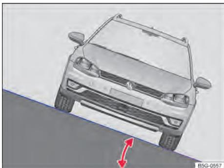
Fig. 131 Representação esquemática: ângulo de inclinação lateral.
