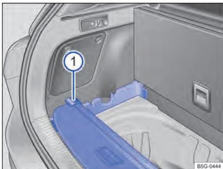
Fig. 176 Embaixo do assoalho do compartimento de bagagem variável: guardar a cobertura do compartimento de bagagem.
