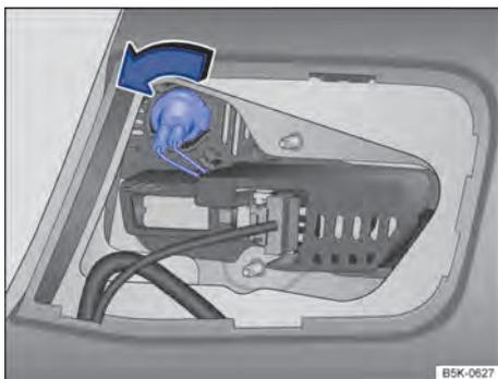
**Fig. 209** Na tampa do compartimento de bagagem: remover o suporte da lâmpada.
