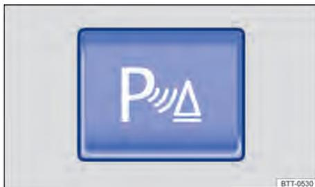
**Fig. 148** No console central: botão para ligar e desligar o auxílio ao estacionamento (dependendo da versão).
