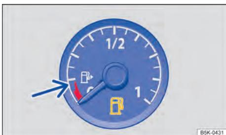
Fig. 17 No instrumento combinado: indicador do nível de combustível.
