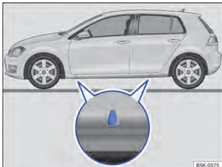
Fig. 244 Pontos de apoio do macaco.
