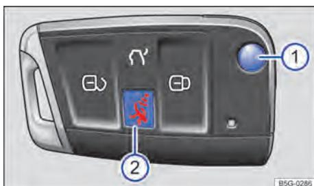
Fig. 58 Chave do veículo com botão do alarme.
