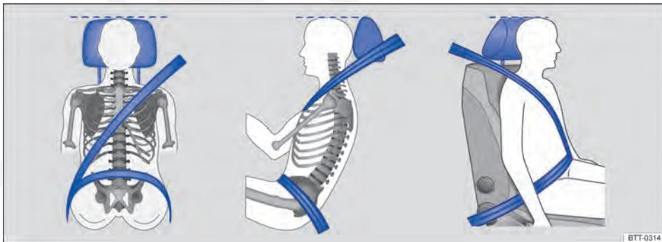
Fig. 66 Posição correta do cadorço do cinto de segurança e ajuste correto do apoio para cabeça.
