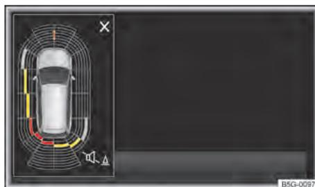
Fig. 142 Exibição do display da vista em miniatura nos arredores do veículo.
