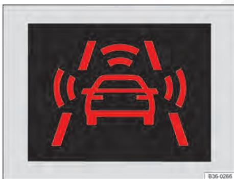
**Fig. 166** No display do instrumento combinado: exibição do alerta antecipado.
