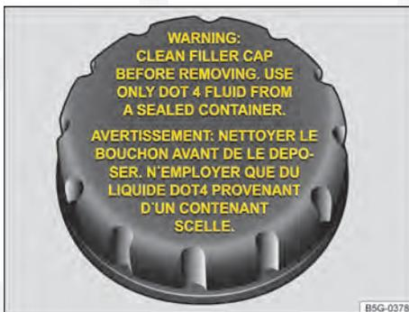
**Fig. 136** No compartimento do motor: tampa do reservatório do fluido de freio (representação esquemática).
