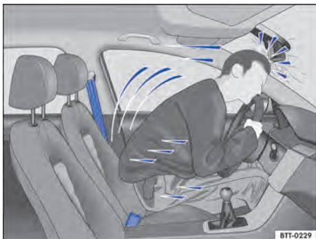
**Fig. 61** O condutor sem cinto de segurança é lançado para frente.
