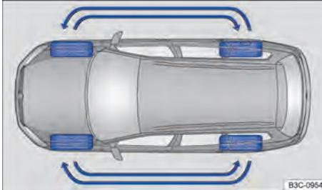
**Fig. 188** Esquema para a troca das rodas.
