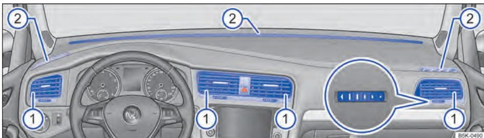
Fig. 174 No painel de instrumentos: difusores de ar.
