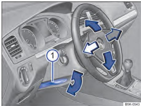
Fig. 53 Ajustar a posição do volante mecanicamente.
