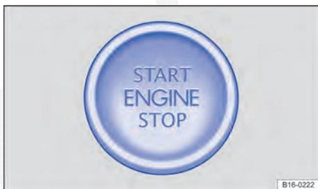
Fig. 125 Na parte inferior do console central: botão de partida do sistema de travamento e de partida Keyless Access.
