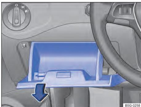
**Fig. 220** À esquerda do volante: cobertura da caixa de fusíveis no painel de instrumentos.
