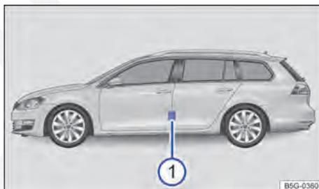
**Fig. 190** Na coluna do condutor: etiqueta com as pressões dos pneus **1** (alternativa ao lado interno da portinhola do tanque).
