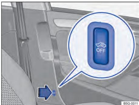
**Fig. 33** Ao lado do banco do condutor: botão para desligar o monitoramento do interior do veículo e o alarme antirrebocagem.
