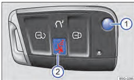
Fig. 23 Chave do veículo com botão do alarme.
