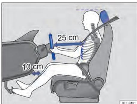
**Fig. 43** A distância correta entre o condutor e o volante deve ser de, no mínimo, 25 cm. Na área dos joelhos, a distância ao painel de instrumentos deve ser, no mínimo, 10 cm.
