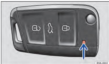
Fig. 24 Luz de controle da chave do veículo.
