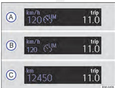
Fig. 155 No display do instrumento combinado: indicadores de status do limitador de velocidade.
