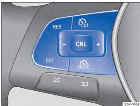
**Fig. 154** Lado esquerdo do volante multifunções: botões para comandar o GRA.
