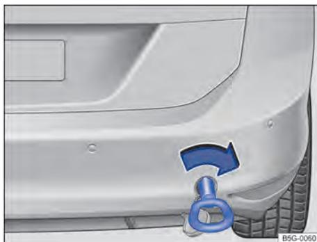
**Fig. 237** No para-choque traseiro à direita: rosquear a argola de reboque.
