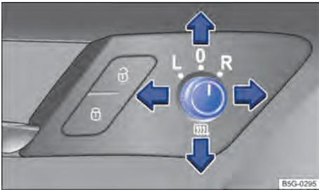
Fig. 94 Na porta do condutor: botão giratório dos espelhos retrovisores externos.
