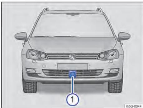
**Fig. 167** No para-choque dianteiro: sensor do radar.
