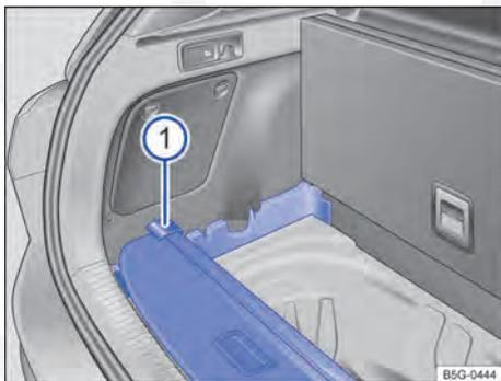
**Fig. 99** Embaixo da cobertura do compartimento variável: guardar a cobertura do compartimento de bagagem.
