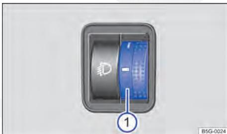
**Fig. 83** Ao lado do volante: regulador da regulagem de alcance do farol
