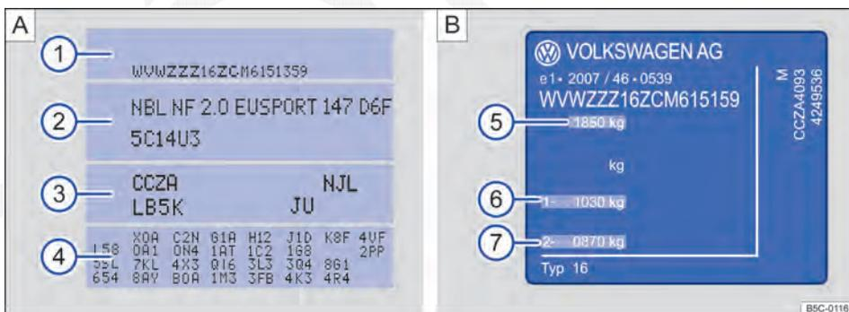
**Fig. 19** A) Etiqueta de dados do veículo: na figura de exemplo com o código do motor CCZA ③. B) Plaqueta de identificação.
