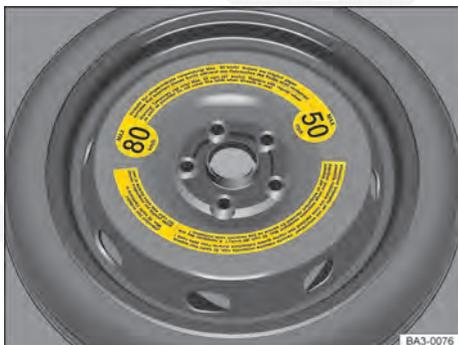
Fig. 192 No compartimento de bagagem: roda de emergência.
