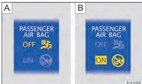
**Fig. 69** Na parte superior do console central: luz de controle para o airbag frontal do passageiro dianteiro desligado **A** ou luz de controle para o airbag frontal do passageiro dianteiro ligado **B**.
