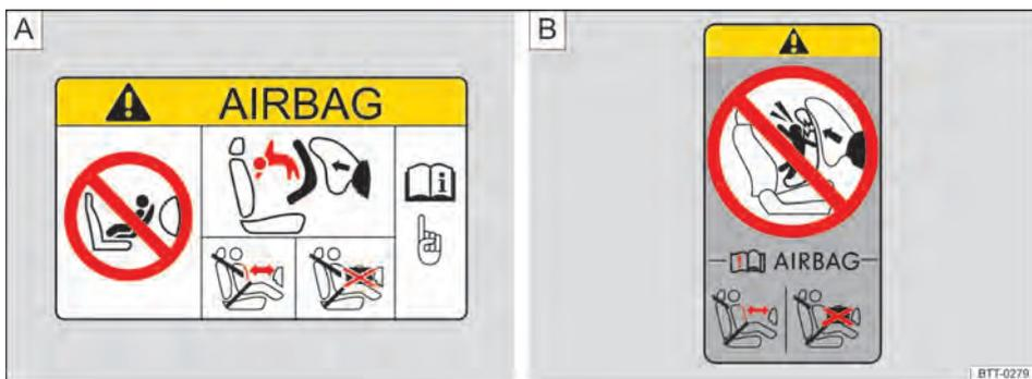
Fig. 76 Representação esquemática: etiqueta do airbag no para-sol [A] ou na coluna B [B].
