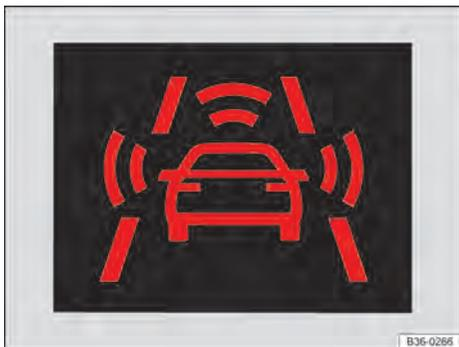
**Fig. 169** No display do instrumento combinado: exibição do alerta antecipado.
