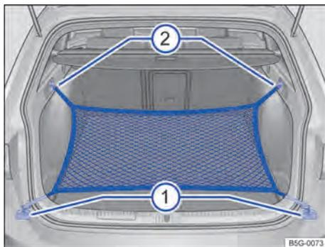
**Fig. 106** No compartimento de bagagem: olhal e gancho para prender a rede para bagagem.
