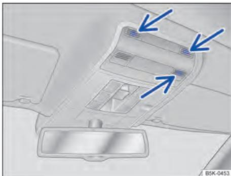
**Fig. 34** No console do teto: sensores do monitoramento do interior do veículo (setas).
