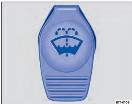
**Fig. 91** No compartimento do motor: tampa do reservatório de água dos lavadores dos vidros.
