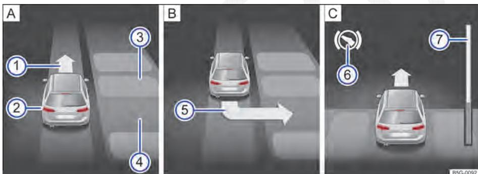
**Fig. 150** No display do instrumento combinado: entrar na vaga de estacionamento transversalmente à pista. **A** Procurar box de estacionamento, **B** posição em relação à entrada na vaga de estacionamento, **C** manobrar.
