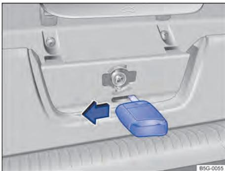
**Fig. 203** No compartimento de bagagem: destravar a tampa traseira.
