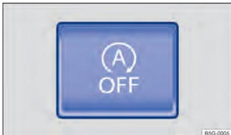
**Fig. 138** Na parte inferior do console central: botão do sistema Start-Stop.
