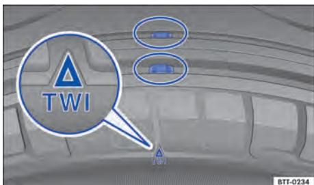
Fig. 191 Perfil do pneu: indicadores de desgaste.
