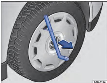
Fig. 211 Retirar a calota integral
