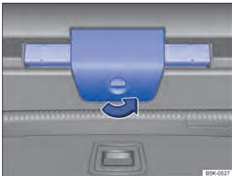
**Fig. 202** Na tampa traseira: abrir o suporte do triângulo de segurança.
