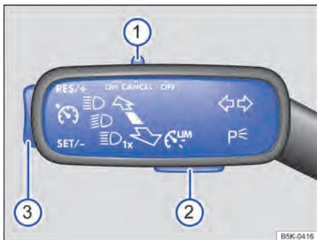
**Fig. 153** À esquerda na coluna de direção: interruptores e botões para comandar o GRA.
