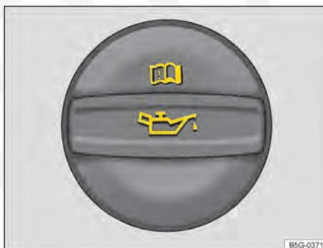
**Fig. 180** No compartimento do motor: tampa da abertura para enchimento de óleo do motor.
