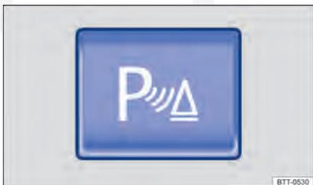
**Fig. 140** Na parte inferior do console central: botão para ligar e desligar o Park Pilot.
