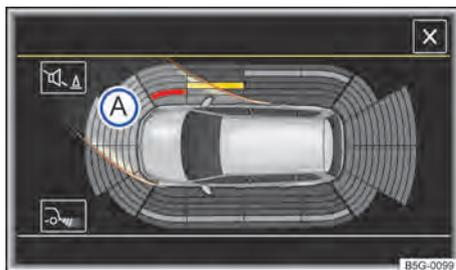
Fig. 144 Exibição do display do Park Pilot: exibição do percurso com ângulo de direção.
