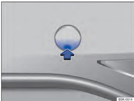
**Fig. 236** No para-choque traseiro à direita: retirar a cobertura.
