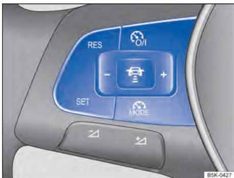
**Fig. 162** Lado esquerdo do volante multifunções: botões para comandar a regulagem automática de distância.
