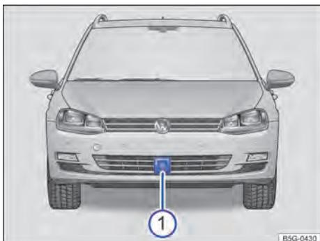
**Fig. 160** No para-choque dianteiro: sensor do radar.
