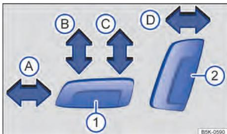
**Fig. 46** Interruptor no banco dianteiro esquerdo: ajustar o banco dianteiro esquerdo na longitudinal, o assento do banco em altura e inclinação, bem como o encosto do banco dianteiro.
