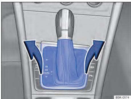
Fig. 204 Desinstalar a cobertura do quadro da alavanca seletora.
