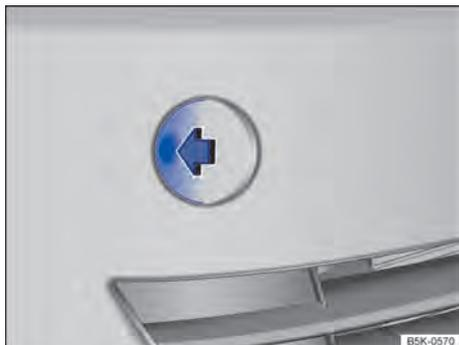
**Fig. 234** No para-choque dianteiro à direita: retirar a cobertura.
