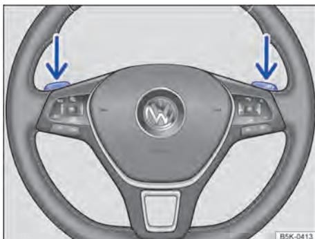
Fig. 133 Volante com 2 seletores basculantes do Tiptronic.
