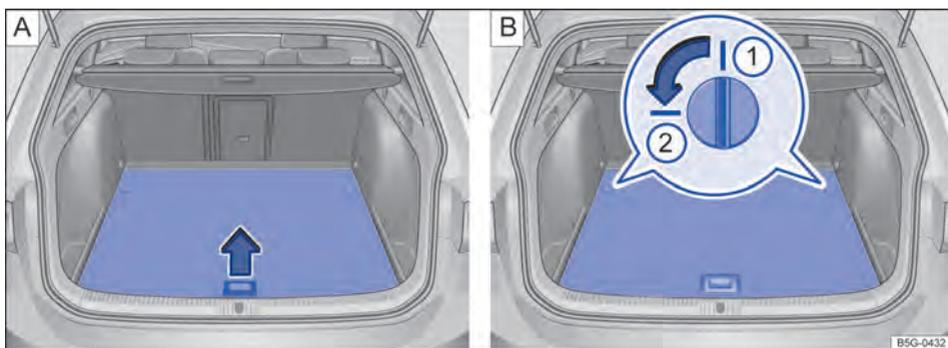
**Fig. 107** No compartimento de bagagem: **A** levantar o assoalho do compartimento de bagagem, **B** Posição ①: travamento do assoalho do compartimento de bagagem fechado, Posição ②: travamento aberto.
