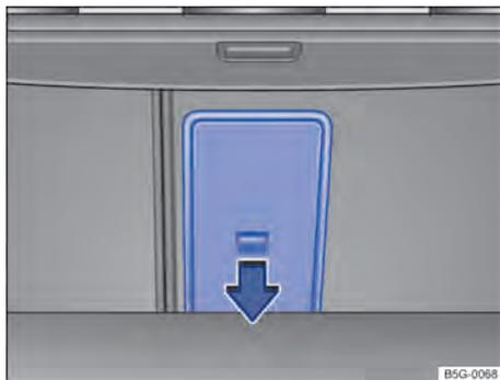
**Fig. 101** No compartimento de bagagem: abrir o dispositivo para transporte de objetos longos.
