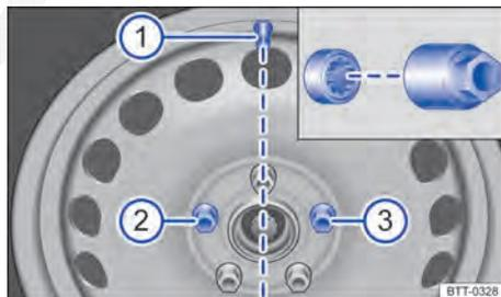
Fig. 214 Troca de roda: válvula do pneu ① e posições de montagem do parafuso de roda antifurto ② ou ③.
