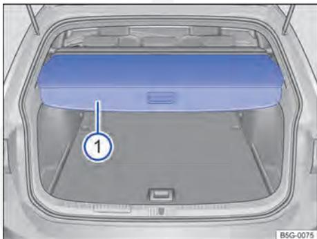
Fig. 97 No compartimento de bagagem: abrir e fechar a cobertura do compartimento de bagagem.
