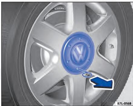
Fig. 209 Retirar a calota central.
