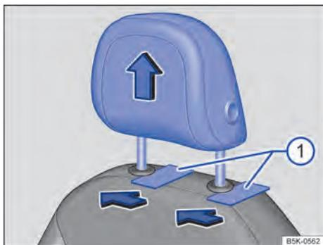
Fig. 50 Desinstalar o apoio para cabeça dianteiro.
