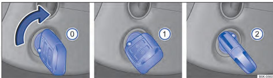
Fig. 124 Posições da chave do veículo no cilindro da ignição.
