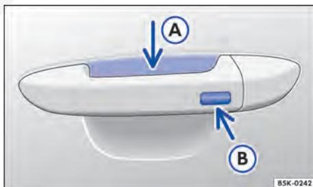
Fig. 32 Sistema de fechamento e de partida Keyless Access sem chave: superfície do sensor **A** para destravamento na parte interna da maçaneta da porta e superfície do sensor **B** para travamento na parte externa da maçaneta da porta.
