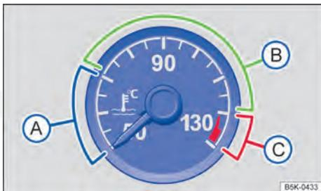
**Fig. 181** Indicador de temperatura do líquido de arrefecimento do motor no instrumento combinado: (A) área fria; (B) área normal; (C) área de advertência.
