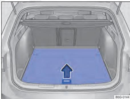
**Fig. 207** No compartimento de bagagem: abrir o assoalho do compartimento de bagagem.
