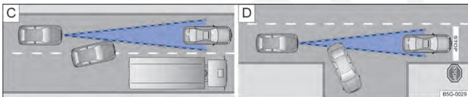
**Fig. 164** **C** Mudança de faixa de um veículo. **D** Veículo virando ou parado.
