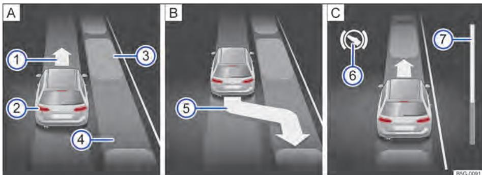
**Fig. 149** No display do instrumento combinado: entrar na vaga de estacionamento paralelo à pista. **A** Procurar vaga de estacionamento, **B** posição em relação à entrada na vaga de estacionamento, **C** manobrar.
