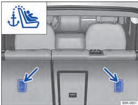
**Fig. 80** Olhais de retenção para o cinto de fixação superior no lado de trás do banco traseiro.
