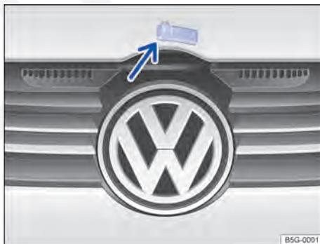
**Fig. 178** Alavanca de destravamento para abrir a tampa do compartimento do motor na grade do radiador.
