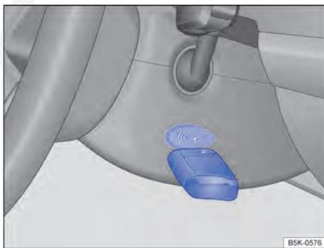
Fig. 126 À direita na coluna de direção: função de partida de emergência em veículos com Keyless Access.
