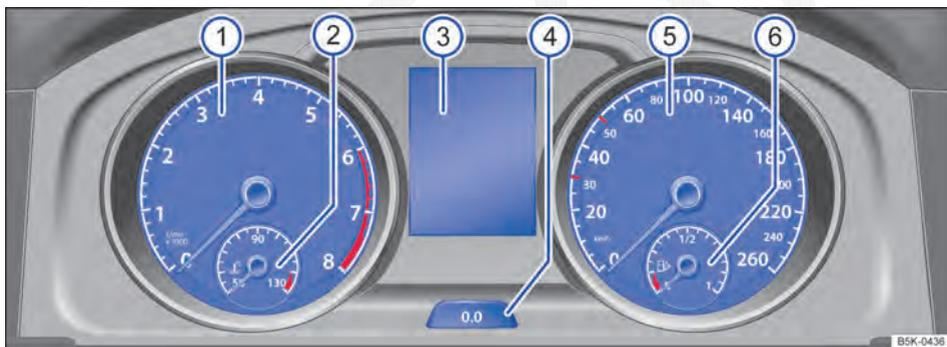
Fig. 10 Instrumento combinado no painel de instrumentos.
