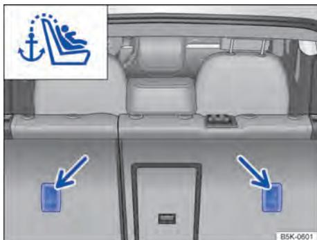
Fig. 10 Olhais de retenção para o cinto de fixação superior no lado de trás do banco traseiro.
