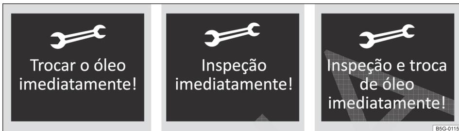
**Fig. 1** Representação esquemática: exemplos de indicações no display do instrumento combinado para um evento de serviço vencido.
