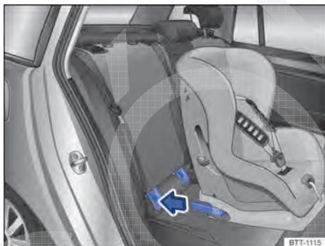
**Fig. 9** Representação esquemática: instalar a cadeira de criança ISOFIX com os braços de apoio.
