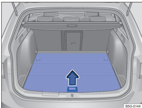
**Fig. 180** No compartimento de bagagem: abrir o assoalho do compartimento de bagagem.
