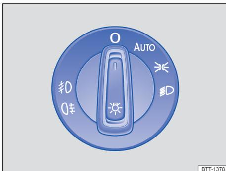
**Fig. 87** Junto ao volante: botão rotativo das luzes (uma variante).
