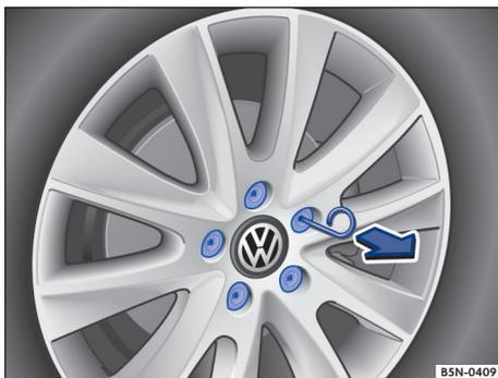
**Fig. 231** Retirar as capas de cobertura dos parafusos da roda.
