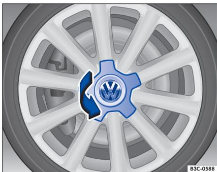
**Fig. 229** Remover a calota central girando-a.
