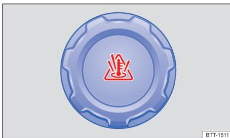
Fig. 217 No compartimento do motor: tampa do reservatório de expansão do líquido de arrefecimento do motor (representação esquemática).
