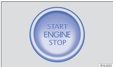
Fig. 109 Na parte inferior do console central: botão de partida para colocar o motor em funcionamento.
