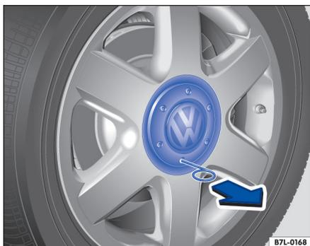
Fig. 228 Remover a calota central puxando a mesma.
