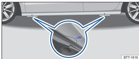
Fig. 236 Pontos de apoio para o macaco.
