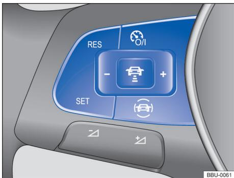
Fig. 128 Lado esquerdo do volante multifunções: botões para comandar o ACC.
