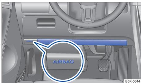
Fig. 48 No lado do condutor: localização do airbag para joelhos.
