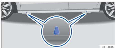
Fig. 234 Pontos de apoio para o macaco.
