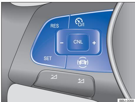
Fig. 124 Lado esquerdo do volante multifunções: botões para comandar o GRA.
