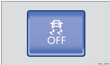
**Fig. 137** No console central: botão para desligar e ligar manualmente o ASR.
