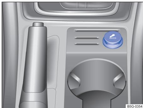
Fig. 148 Na parte inferior do console central: acendedor.
