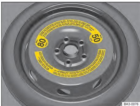
Fig. 188 No compartimento de bagagem: roda de emergência.
