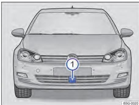
**Fig. 156** No para-choque dianteiro: sensor do radar.
