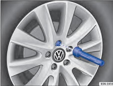
**Fig. 213** Troca de roda: desaparafusar os parafusos de roda com o punho da chave de fenda.
