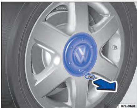
Fig. 204 Retirar a calota central.
