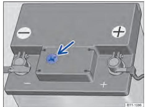
**Fig. 181** Representação esquemática: visor no lado superior da bateria do veículo 12 V.
