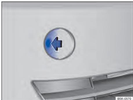
**Fig. 232** No para-choque dianteiro à direita: remover a cobertura.
