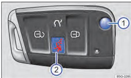
Fig. 21 Chave do veículo com botão do alarme.
