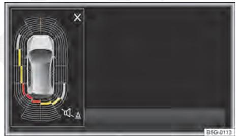
Fig. 138 Exibição do display da vista em miniatura nos arredores do veículo.
