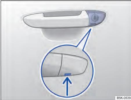
**Fig. 195** Maçaneta da porta do condutor: cilindro da fechadura coberto.
