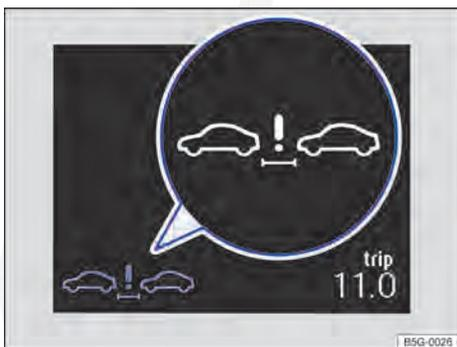
**Fig. 161** No display do instrumento combinado: exibição do alerta de distância.
