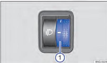
**Fig. 80** Ao lado do volante: regulador da regulagem de alcance do farol
