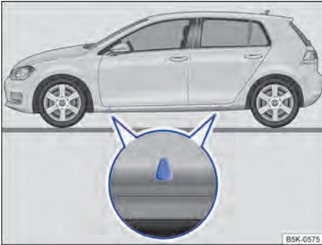
Fig. 208 Pontos de apoio do macaco.
