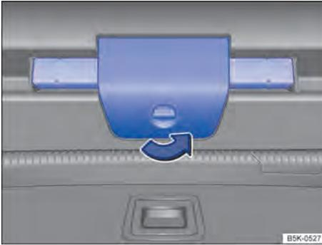
**Fig. 198** Na tampa do compartimento de bagagem: abrir o suporte para o triângulo de segurança.
