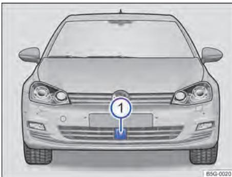
**Fig. 163** No para-choque dianteiro: sensor do radar.
