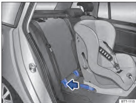
**Fig. 76** Representação esquemática: instalar a cadeira de criança ISOFIX com os braços de apoio.
