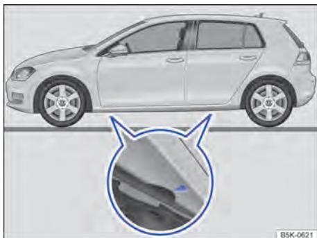
Fig. 210 Pontos de apoio do macaco.
