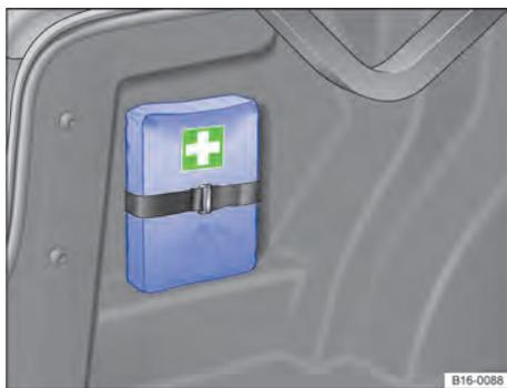
**Fig. 43** No compartimento de bagagem: suporte do kit de primeiros socorros.
