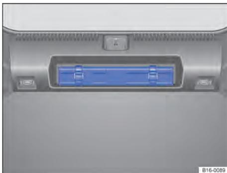
**Fig. 44** Na tampa do compartimento de bagagem: suporte para o triângulo de segurança.
