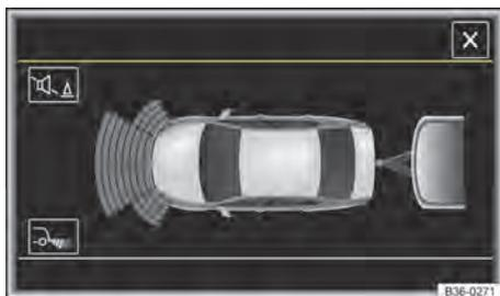
**Fig. 140** Exibição do display (display colorido) do Park Pilot em condução com reboque (representação esquemática).
