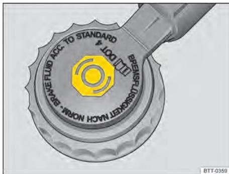
Fig. 205 No compartimento do motor: tampa do reservatório do fluido de freio (representação esquemática).
