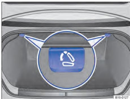
**Fig. 73** No compartimento de bagagem: alavanca de destravamento para o encosto do banco traseiro.
