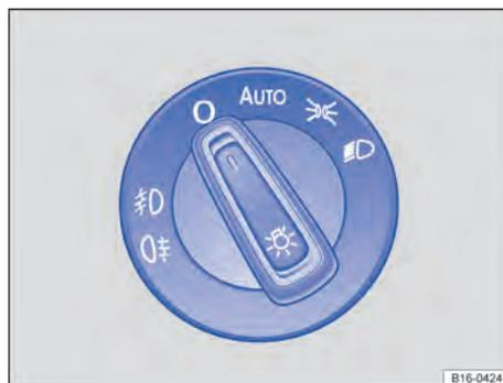
Fig. 82 Ao lado do volante: interruptor das luzes (uma variante).
