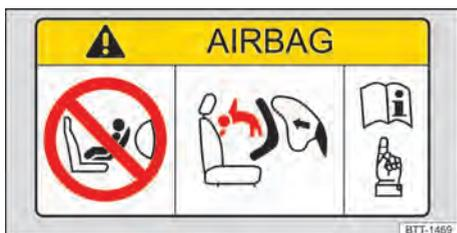
Fig. 38 Etiqueta do airbag no para-sol (representação esquemática).
