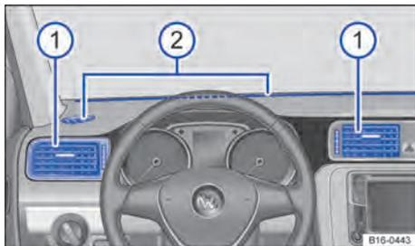
Fig. 99 Difusores de ar no painel de instrumentos (lado do condutor).
