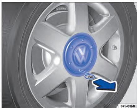
Fig. 215 Retirar a calota central.
