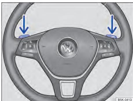
**Fig. 114** Volante com seletores basculantes do Tiptronic.
