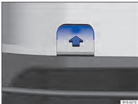
Fig. 194 No para-choque dianteiro à direita: retirar cobertura.
