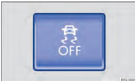
**Fig. 144** Na parte inferior do console central: botão para desligar e ligar o ASR manualmente (dependendo do modelo).
