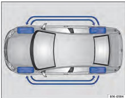
Fig. 209 Esquema para a troca de roda.
