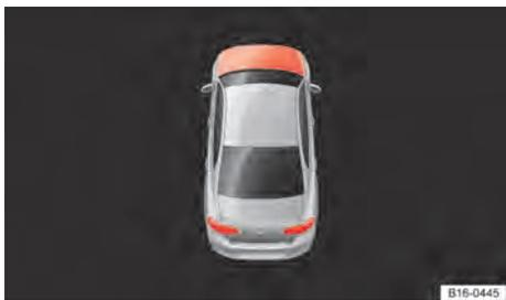
**Fig. 199** No display do instrumento combinado: tampa do compartimento do motor aberta ou fechada incorretamente (variante 2).
