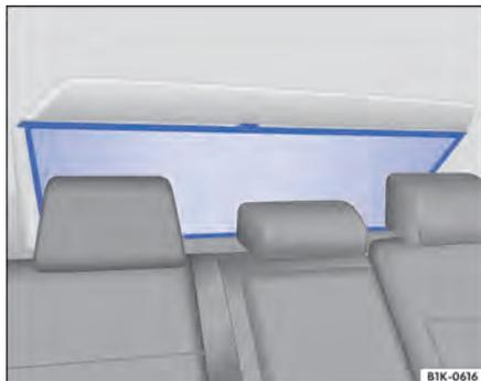
Fig. 94 Cortina de proteção solar do vidro traseiro.
