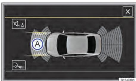
**Fig. 138** Exibição do display do Park Pilot: exibição do percurso sem ângulo de direção (representação esquemática).
