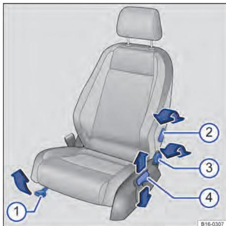
**Fig. 70** No banco dianteiro esquerdo: elementos de comando (variante 2).
