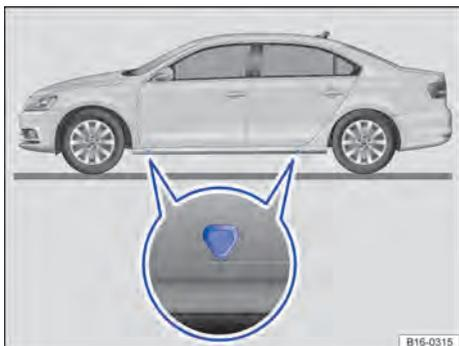
Fig. 221 Pontos de apoio do macaco.
