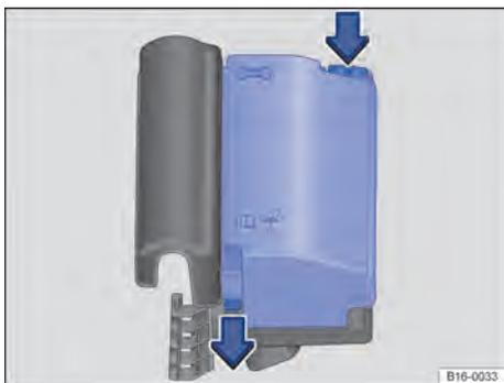
Fig. 188 No compartimento do motor: cobertura da caixa de fusíveis.
