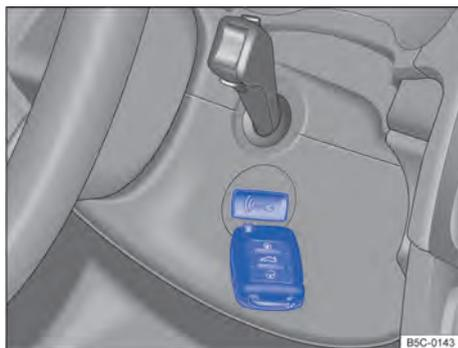
**Fig. 107** À direita na coluna de direção: função de partida de emergência em veículos com sistema de travamento e de partida Keyless Access sem chave.
