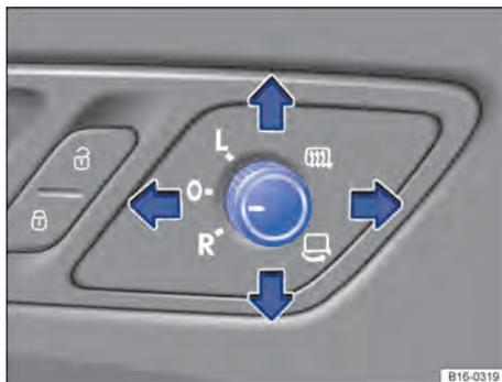
Fig. 92 Na porta do condutor: botão rotativo para espelho retrovisor externo elétrico.
