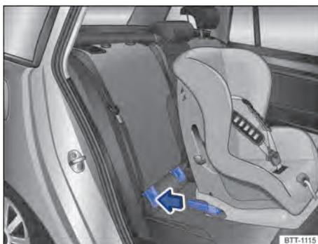
Fig. 41 Instalar a cadeira de criança ISOFIX com os braços de apoio (representação esquemática).
