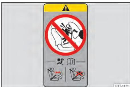
Fig. 39 Etiqueta do airbag na coluna B (representação esquemática).
