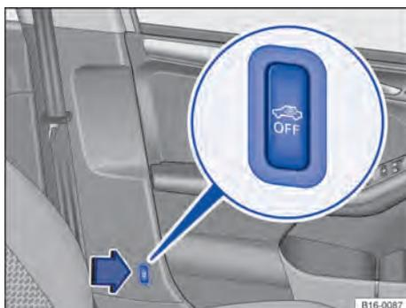
**Fig. 52** Ao lado do banco do condutor: botão para desligar o monitoramento do interior do veículo e o alarme antirrebocagem.
