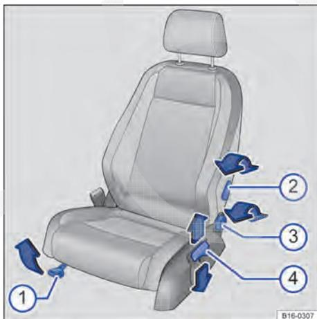
**Fig. 51** Comandos do banco dianteiro esquerdo (variante 2).
