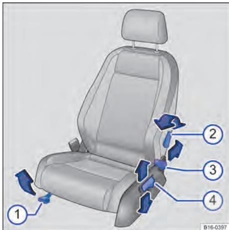
**Fig. 50** Comandos do banco dianteiro esquerdo (variante 1).
