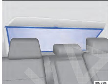
Fig. 92 Cortina de proteção solar do vidro traseiro.
