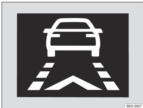
**Fig. 171** No display do instrumento combinado: exibição do alerta antecipado.
