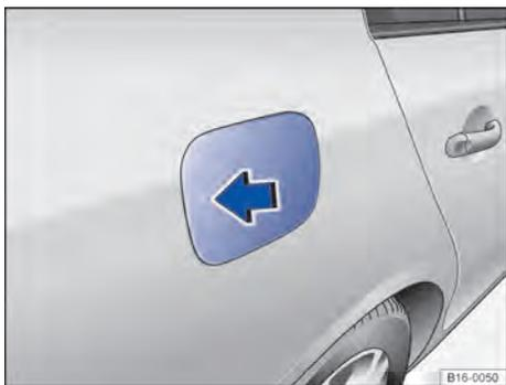
**Fig. 191** Lado do veículo tras. direito: Abertura da tampa do tanque.
