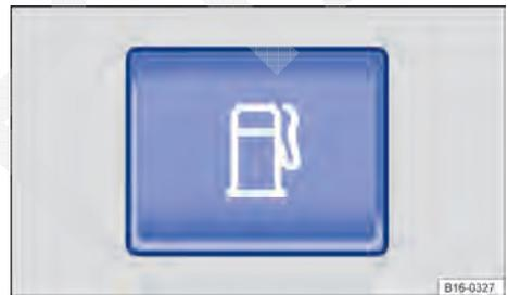
Fig. 23 Na parte inferior do console central: botão para destravar a portinhola do combustível.
