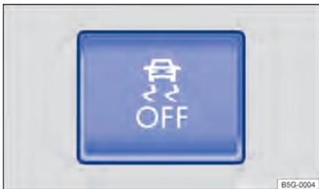
**Fig. 147** Na parte inferior do console central: botão para desligar e ligar o ASR manualmente (dependendo do modelo).
