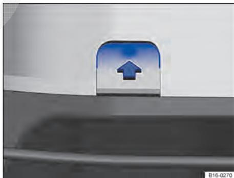
**Fig. 249** No para-choque dianteiro à direita: retirar cobertura.
