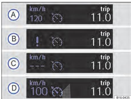
**Fig. 161** No display do instrumento combinado: indicadores de status do GRA.
