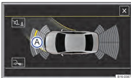
**Fig. 156** Exibição do display do Park Pilot: exibição do percurso com ângulo de direção (representação esquemática).
