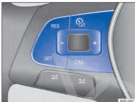
**Fig. 163** Lado esquerdo do volante multifunções: botões para comandar o GRA.
