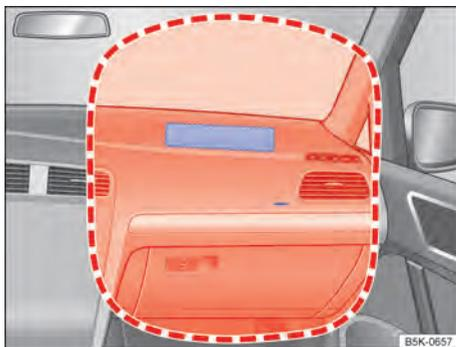
Fig. 77 Local de instalação e área de expansão do airbag frontal do passageiro dianteiro.
