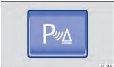
**Fig. 152** Na parte inferior do console central: botão para ligar e desligar o Park Pilot.
