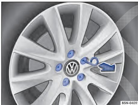
**Fig. 228** Remover as capas de cobertura dos parafusos de roda.
