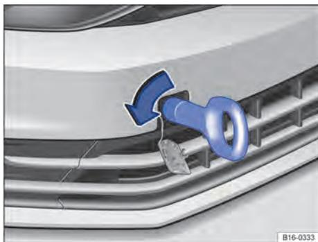
**Fig. 250** No para-choque dianteiro à direita: rosquear a argola de reboque.
