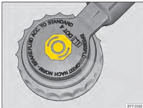
**Fig. 148** No compartimento do motor: tampa do reservatório do fluido de freio.
