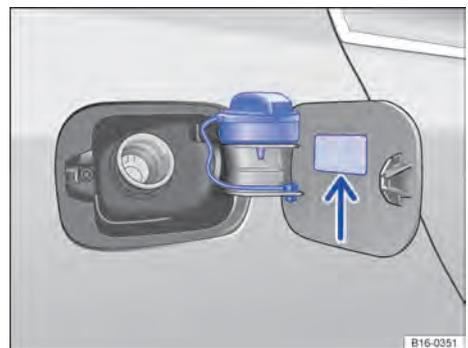
Fig. 24 Portinhola do tanque aberta com a tampa do tanque pendurada.
