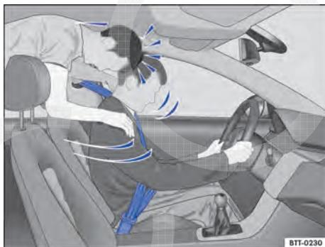
**Fig. 68** O passageiro sem cinto de segurança no banco traseiro é lançado para frente sobre o condutor com cinto de segurança.
