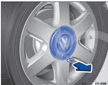
Fig. 225 Retirar a calota central.
