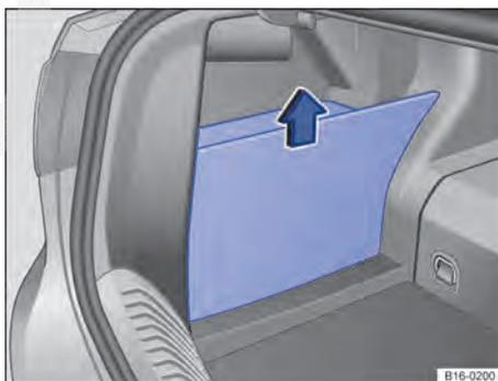
**Fig. 26** A bateria do veículo 12 V no compartimento de bagagem: desinstalar a cobertura da bateria do veículo 12 V.
