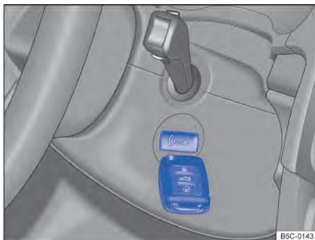
**Fig. 136** À direita na coluna de direção: função de partida de emergência em veículos com Keyless Access.
