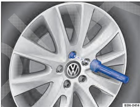
Fig. 235 Troca de roda: desaparafusar os parafusos de roda com o punho da chave de fenda.
