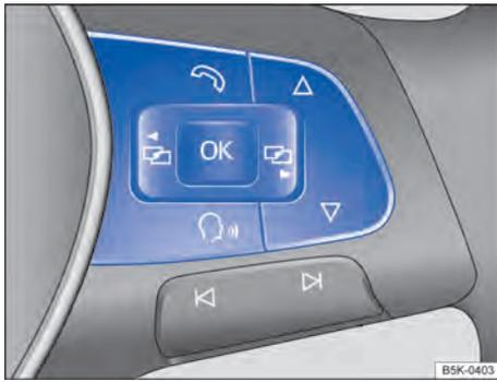
**Fig. 14** Lado direito do volante multifunções: botões para comando dos menus e exibições de informação do instrumento combinado.
