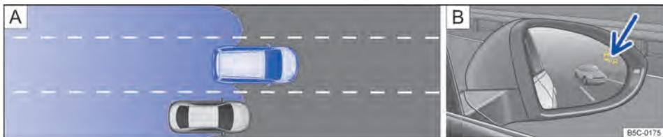
**Fig. 176** **A** Situação de condução ao ultrapassar e mudar frequentemente de faixa. **B** Indicação do sensor de ponto cego no espelho retrovisor externo direito (representação esquemática).
