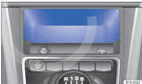
Fig. 116 Na parte inferior do console central: porta-objetos.
