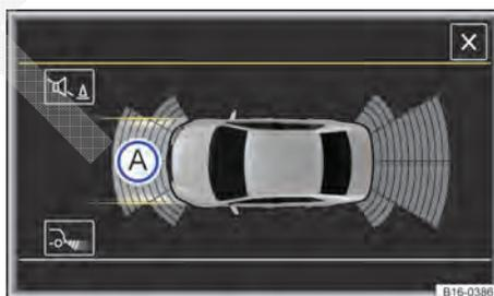
**Fig. 155** Exibição do display do Park Pilot: exibição do percurso sem ângulo de direção (representação esquemática).
