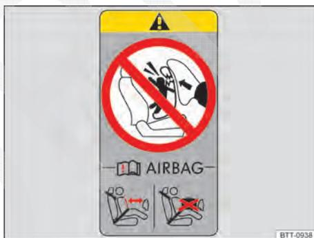
Fig. 83 Etiqueta do airbag na coluna B (representação esquemática).
