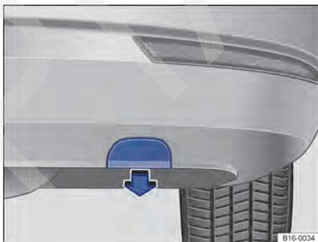
**Fig. 251** No para-choque traseiro à direita: remover cobertura.
