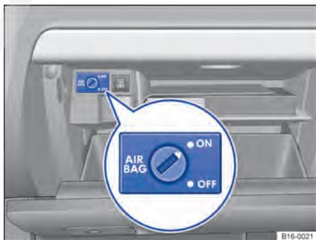
**Fig. 78** No porta-luvas: interruptor acionado pela chave para desligar e ligar o airbag frontal do passageiro.
