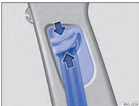
Fig. 74 Ao lado dos bancos dianteiros: regulagem de altura do cinto de segurança.
