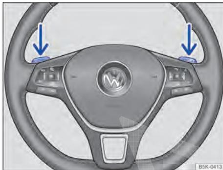
Fig. 145 Volante com seletores basculantes do Tiptronic.
