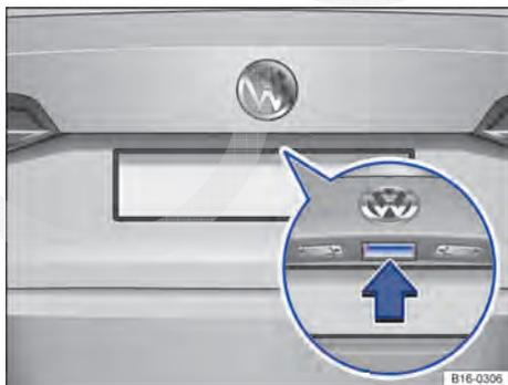
**Fig. 42** Abrir a tampa do compartimento de bagagem por fora.
