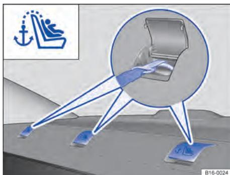
Fig. 87 Nos porta-objetos atrás da superfície atrás do banco traseiro: olhas de retenção para o cinto de fixação superior.
