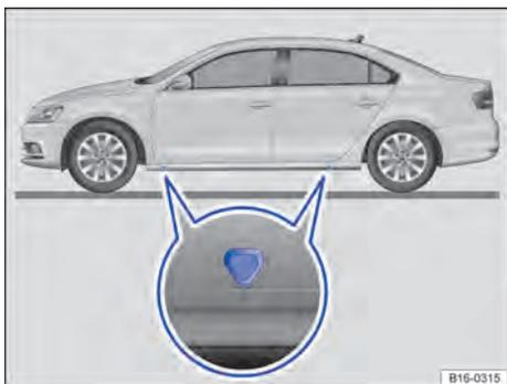
Fig. 231 Pontos de apoio do macaco.
