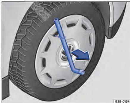
Fig. 227 Retirar a calota integral.
