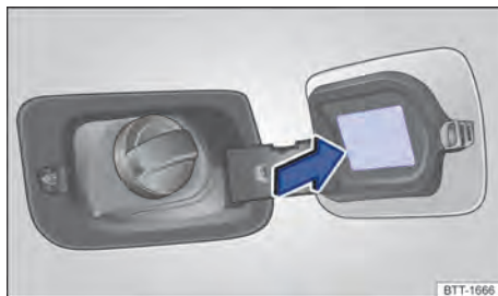
Fig. 188 Na parte interna da portinhola do tanque de combustível: etiqueta com a pressão dos pneus.
