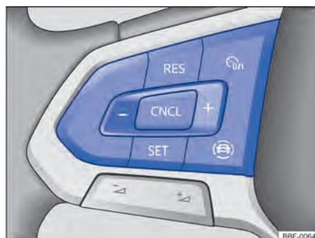
Fig. 92 Lado esquerdo do volante multifunções (variante 2): botões para comandar o GRA.
