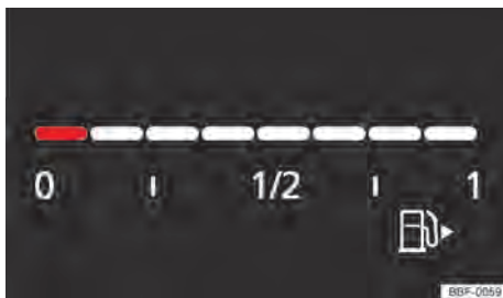
Fig. 12 No instrumento combinado digital: indicador do nível de combustível (variante 2).
