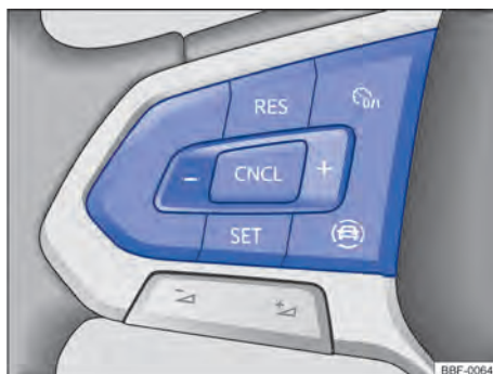
Fig. 94 Lado esquerdo do volante multifunções (variante 2): botões para comandar o limitador de velocidade.
