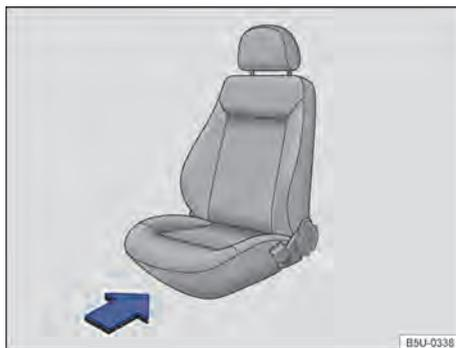
Fig. 47 Na parte frontal do banco do passageiro dianteiro: localização para instalação do suporte do extintor de incêndio.
