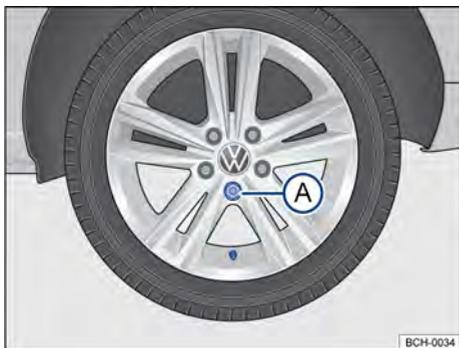
Fig. 198 Troca de roda: sequência de remoção dos parafusos da roda.
