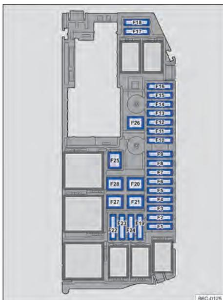
Fig. 172 No compartimento do motor: disposição dos fusíveis.
