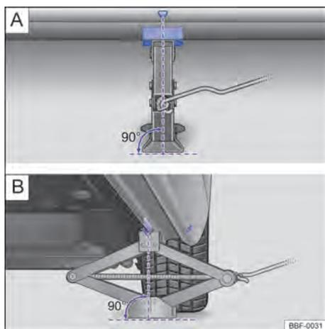
Fig. 197 Pontos de apoio do macaco e macaco posicionado no lado esquerdo traseiro do veículo.
