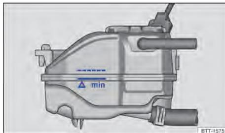
Fig. 184 No compartimento do motor: marcação no reservatório de expansão do líquido de arrefecimento do motor.
