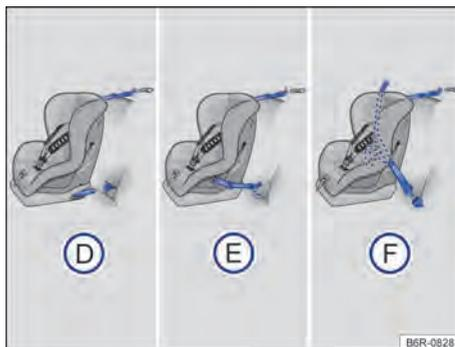
**Fig. 40** No banco traseiro: as figuras (D) e (E) mostram o princípio da fixação do sistema de retenção para crianças nos olhais de retenção inferiores e com o cinto de fixação superior. A figura (F) mostra a fixação do sistema de retenção para crianças com o cinto de segurança do veículo e com o cinto de fixação superior.
