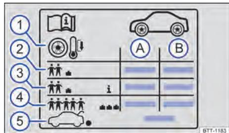
Fig. 190 Etiqueta com as pressões dos pneus.
