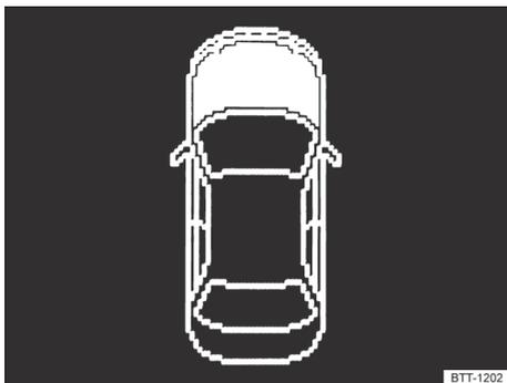
**Fig. 180** No display do instrumento combinado: tampa do compartimento do motor aberta ou fechada incorretamente (representação esquemática).
