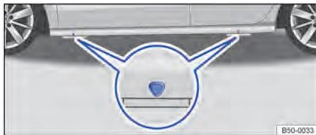
Fig. 196 Pontos de apoio do macaco.
