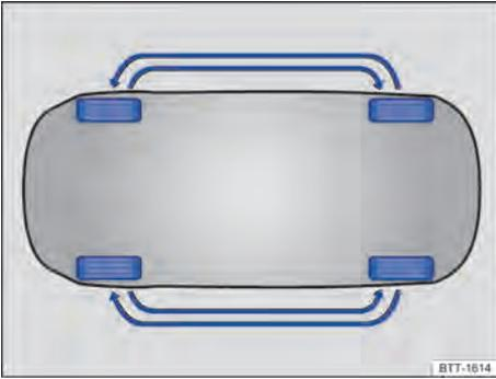
Fig. 189 Esquema para a troca das rodas.
