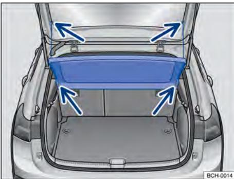
**Fig. 155** No compartimento de bagagem: remover e instalar a cobertura do compartimento de bagagem.
