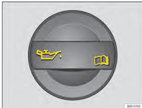
**Fig. 183** No compartimento do motor: tampa da abertura para enchimento de óleo do motor.
