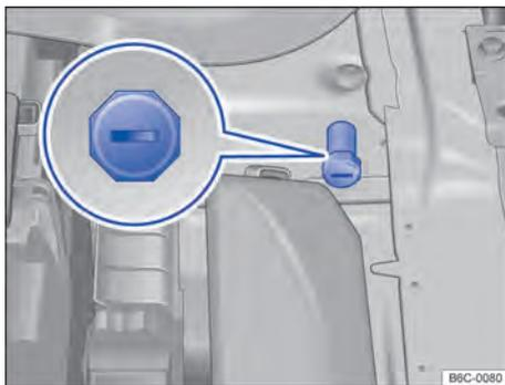
**Fig. 176** No compartimento do motor: ponto de auxílio à partida (ponto de aterramento).
