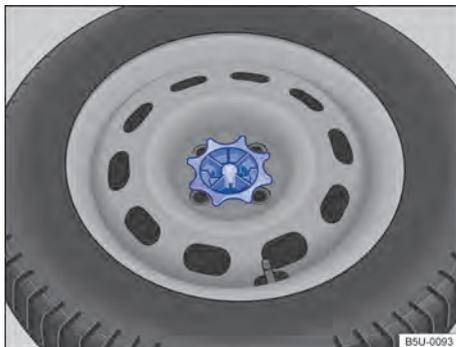
**Fig. 193** No compartimento de bagagem: manípulo para fixação da roda de emergência.
