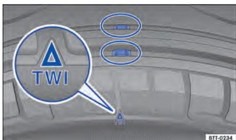
Fig. 192 Perfil do pneu: indicadores de desgaste.
