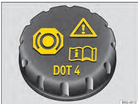
**Fig. 186** No compartimento do motor: tampa do reservatório de fluido de freio.
