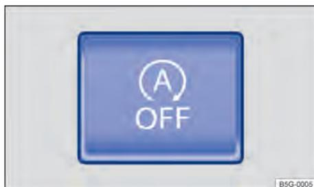
**Fig. 90** Na parte superior do console central: botão do sistema Start-Stop.
