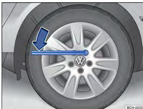
Fig. 195 Troca de roda: soltar os parafusos da roda.
