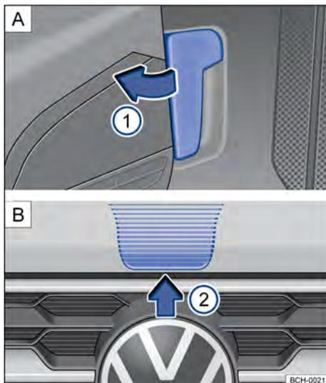
Fig. 178 [A] Alavanca de destravamento da tampa do compartimento do motor na área para os pés do lado do condutor. [B] Alavanca de destravamento na parte interna da tampa do compartimento do motor. ▶
