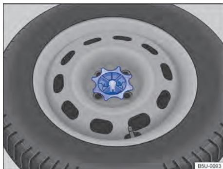
Fig. 172 No compartimento de bagagem: manípulo para fixação da roda de emergência.
