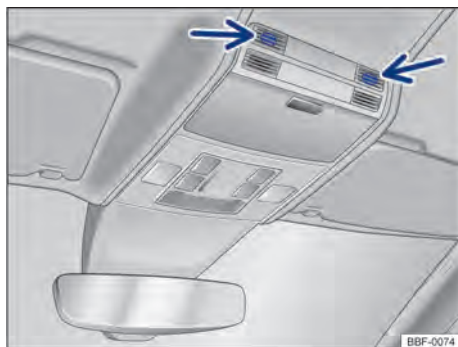
Fig. 57 No console do teto: sensores de monitoramento do interior do veículo (setas).
