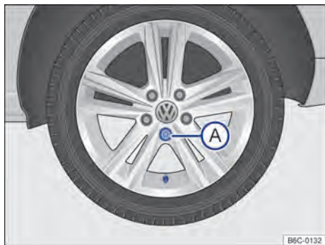
Fig. 177 Troca de roda: sequência de remoção dos parafusos da roda.
