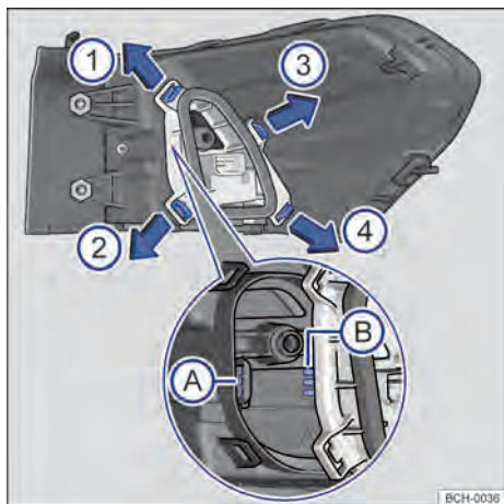
Fig. 148 Lanterna traseira: desinstalar o suporte das lâmpadas
