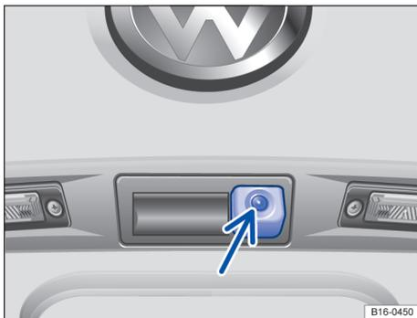
**Fig. 198** Na parte traseira do veículo: câmera do assistente de marcha à ré na luz da placa de licença (representação esquemática).
