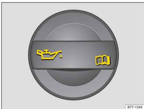
Fig. 173 No compartimento do motor: tampa do bocal de abastecimento de óleo do motor (representação esquemática).
