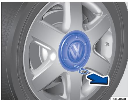
Fig. 185 Remover a calota central puxando a mesma.
