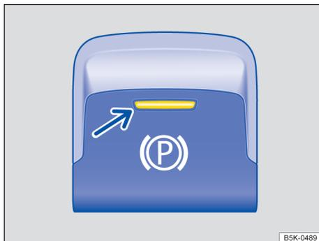
Fig. 133 No console central: botão de freio de estacionamento eletrônico.
