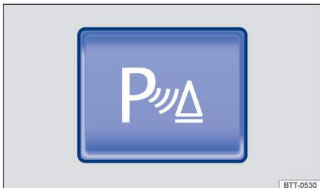
**Fig. 134** No console central: botão para ligar e desligar o auxílio de estacionamento (dependendo da versão).
