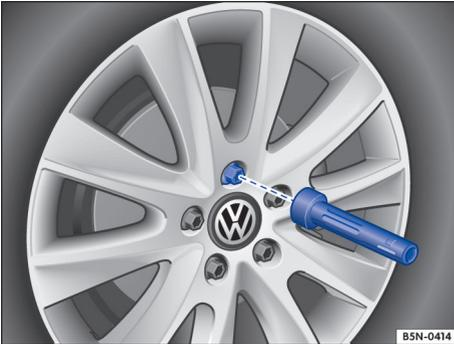
Fig. 193 Substituição de roda: desrosquear os parafusos de roda com o cabo da chave de fenda.
