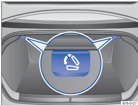
Fig. 79 No compartimento de bagagem: alavanca de destravamento para o encosto do banco traseiro.
