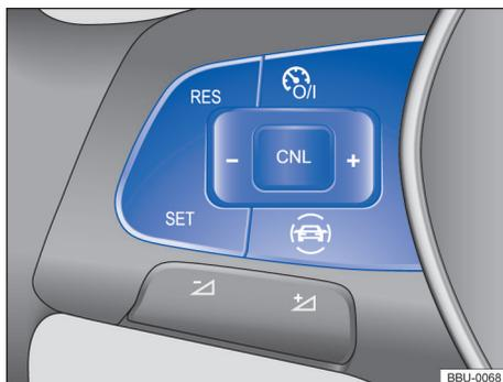
**Fig. 123** Lado esquerdo do volante multifunções: botões para comandar o GRA. ▶
