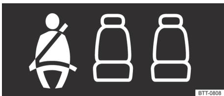
Fig. 27 No display do instrumento combinado: indicação de status dos cintos de segurança dos assentos traseiros.
