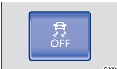
**Fig. 137** Na parte inferior do console central: botão para desligar e ligar manualmente o ASR (em função do modelo).
