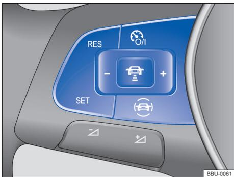
Fig. 131 Lado esquerdo do volante multifunções: botões para comandar o ACC.
