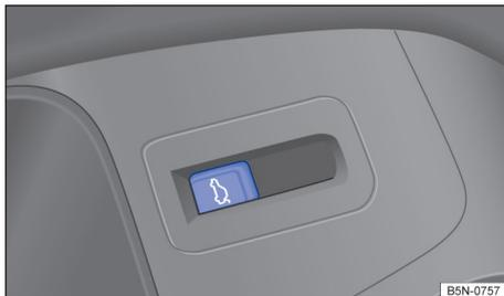
**Fig. 63** Na porta do condutor: destravamento da tampa do compartimento de bagagem.
