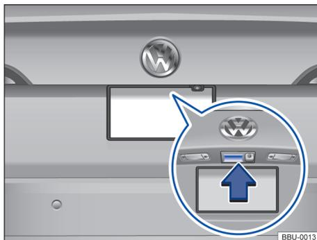
Fig. 69 Abrir a tampa do compartimento de bagagem por fora.
