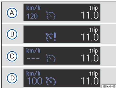
**Fig. 122** No display do instrumento combinado: indicações do estado do GRA (representação esquemática).
