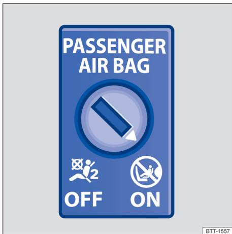
Fig. 41 No porta-luvas: interruptor acionado pela chave para desligar e ligar o airbag frontal do passageiro.
