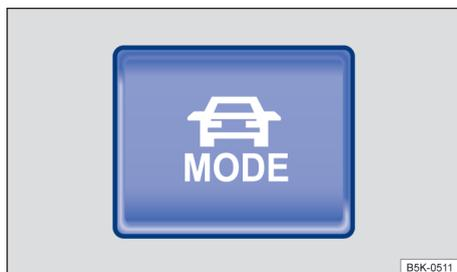
Fig. 120 Na parte inferior do console central: botão de seleção do perfil de condução.
