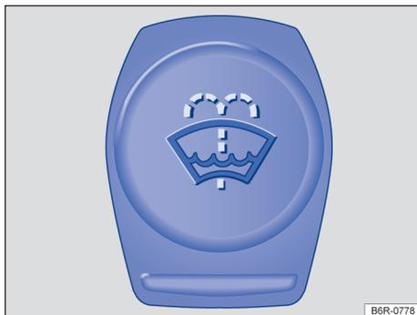
**Fig. 171** No compartimento do motor: tampa do reservatório da água dos lavadores dos vidros.
