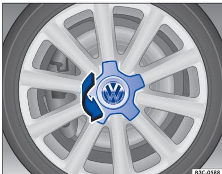
Fig. 186 Remover a calota central girando-a.
