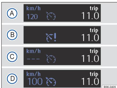
**Fig. 124** No display do instrumento combinado: indicações do estado do GRA (representação esquemática).
