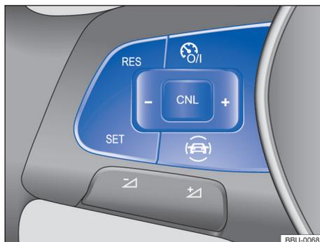
**Fig. 127** Lado esquerdo do volante multifunções: botões para comandar o limitador de velocidade.
