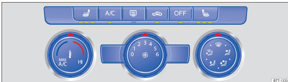
Fig. 100 Na parte superior do console central: painel de comando do ar-condicionado manual.
