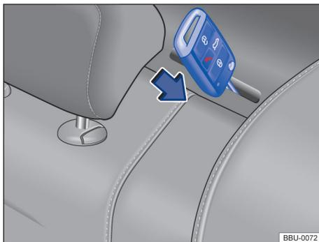
Fig. 71 Atrás do encosto do banco traseiro: destravamento de emergência do encosto do assento traseiro.
