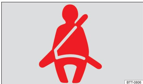
Fig. 26 No display do instrumento combinado: luz de advertência.
