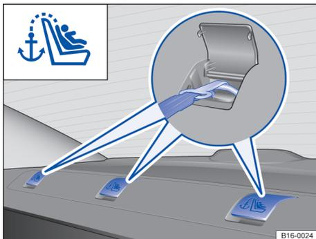
**Fig. 50** Nos porta-objetos atrás da superfície posterior do banco traseiro: olhas de retenção para o cinto de fixação superior.
