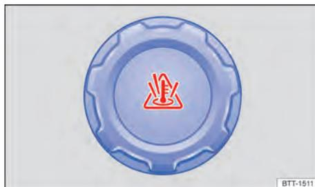
Fig. 208 No compartimento do motor: tampa do reservatório de expansão do líquido de arrefecimento do motor.
