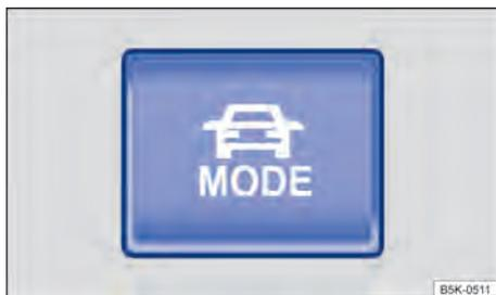
Fig. 100 No console central: botão MODE na seleção do perfil de condução.
