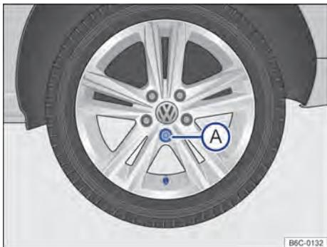
Fig. 223 Troca de roda: seqüência de remoção dos parafusos da roda.
