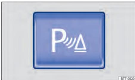
**Fig. 103** No console central: botão para ligar e desligar o auxílio de estacionamento (dependendo da versão do veículo).
