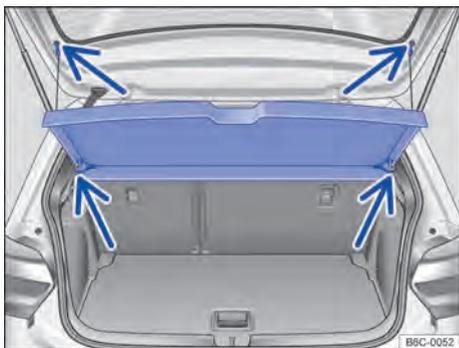
Fig. 169 No compartimento de bagagem: remover e instalar a cobertura do compartimento de bagagem.
