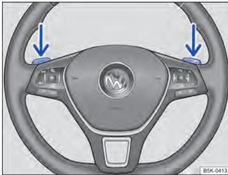
**Fig. 98** Volante com seletores basculantes do Tiptronic.
