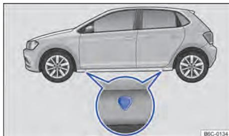
Fig. 221 Pontos de apoio do macaco.
