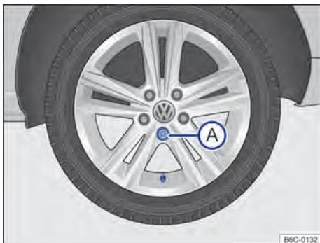
Fig. 218 Retirar a calota integral.
