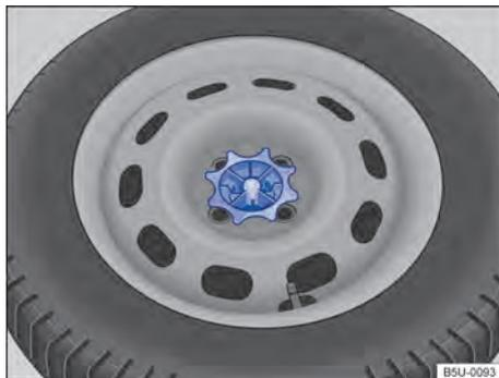
**Fig. 216** No compartimento de bagagem: manípulo para fixação da roda de emergência.
