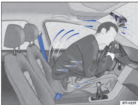
**Fig. 29** O condutor sem cinto de segurança é lançado para frente.
