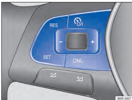
Fig. 101 Lado esquerdo do volante multifunções: botões para comandar o GRA.
