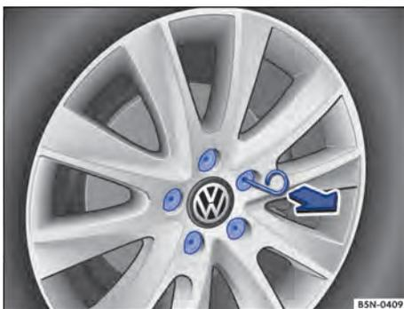
Fig. 219 Remover as capas de cobertura dos parafusos de roda.
