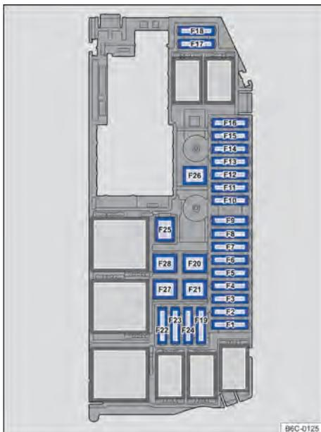
Fig. 195 No compartimento do motor: disposição dos fusíveis.
