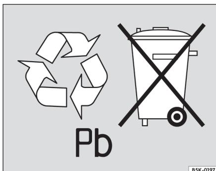
**Fig. 211** As baterias contêm substâncias tóxicas e a sua reciclagem é obrigatória. Por isso, é proibido o seu descarte / disposição com o lixo doméstico e a bateria deve ser devolvida ao revendedor, após a substituição.
