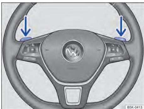
Fig. 98 Volante com seletores basculantes do Tiptronic.
