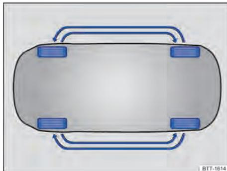
Fig. 212 Esquema para a troca das rodas.
