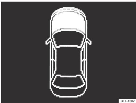
**Fig. 203** No display do instrumento combinado: tampa do compartimento do motor aberta ou fechada incorretamente (representação esquemática).
