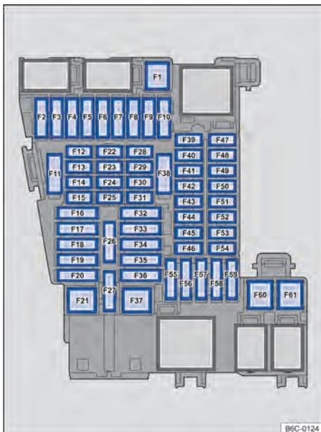
**Fig. 193** No painel de instrumentos: disposição dos fusíveis.
