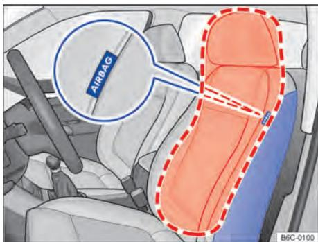
**Fig. 42** Lateralmente no banco dianteiro: localização de instalação e área de expansão dos airbags laterais.
