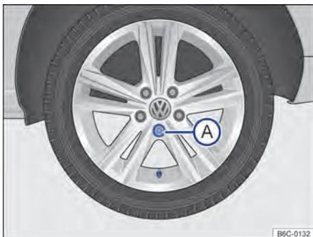
Fig. 218 Retirar a calota integral.
