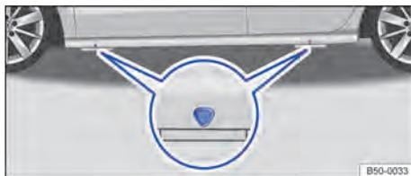
Fig. 221 Pontos de apoio do macaco.
