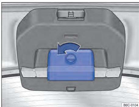
Fig. 50 Na tampa do compartimento de bagagem: suporte para o triângulo de segurança.
