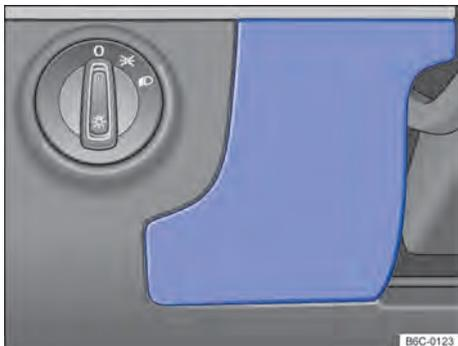
**Fig. 192** No lado do condutor do painel de instrumentos: cobertura da caixa de fusíveis.
