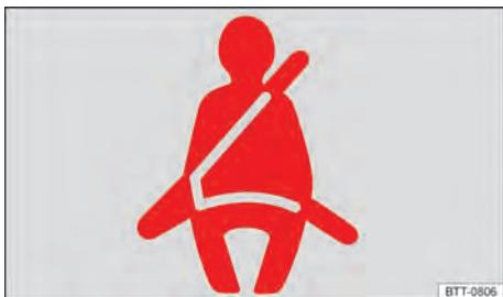
Fig. 26 Luz de advertência no display do instrumento combinado.
