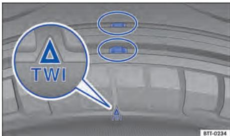
Fig. 165 Perfil do pneu: indicadores de desgaste.
