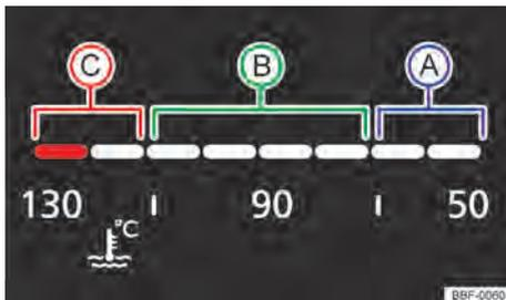
**Fig. 15** Indicador de temperatura do líquido de arrefecimento do motor no instrumento combinado digital (variante 2): (A) área fria; (B) área normal; (C) área de alerta.
