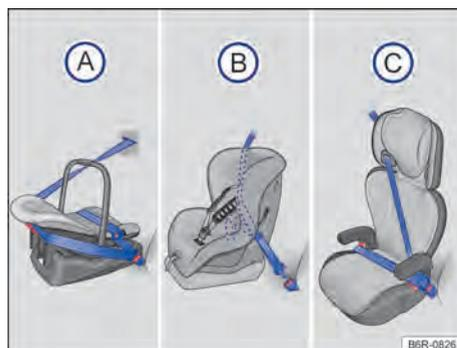
Fig. 41 As ilustrações A, B e C mostram a fixação do sistema de retenção para crianças apenas com o cinto de segurança do veículo.
