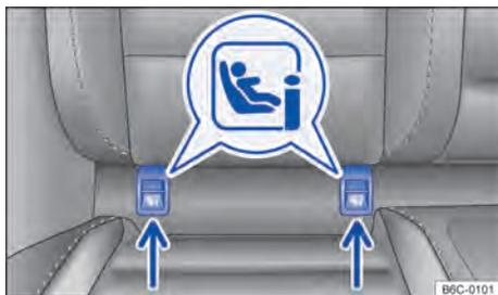
Fig. 43 No banco do veículo: identificação dos pontos de ancoragem inferiores para cadeiras de criança.
