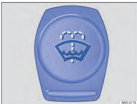
**Fig. 155** No compartimento do motor: tampa do reservatório de água dos lavadores dos vidros.
