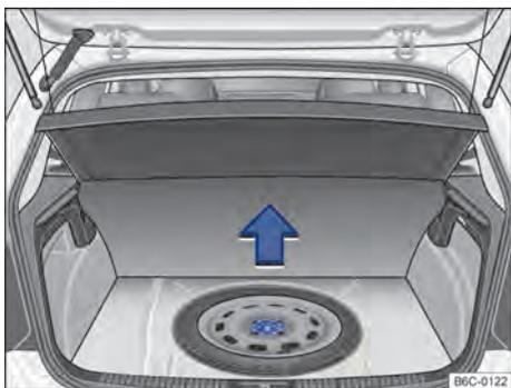
**Fig. 130** No compartimento de bagagem, sob o revestimento de assoalho: roda de emergência e ferramentas de bordo.
