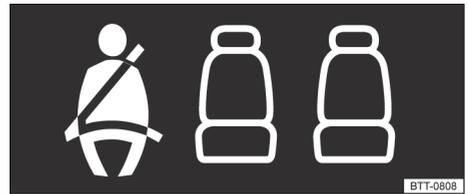
Fig. 24 Indicador de status do cinto de segurança para os assentos traseiros no display do instrumento combinado.
