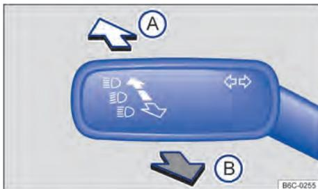
Fig. 71 À esquerda na coluna de direção: alavanca dos indicadores de direção e do farol alto (variante 1).
