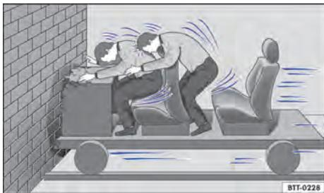
Fig. 26 Um veículo com os ocupantes sem cintos de segurança colide com o muro.
