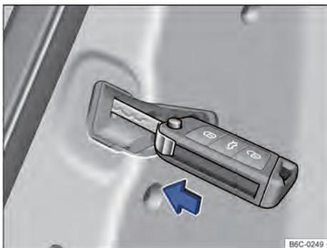
**Fig. 57** Nas portas, dianteira direita e traseiras: travamento de emergência do veículo com a haste metálica da chave.
