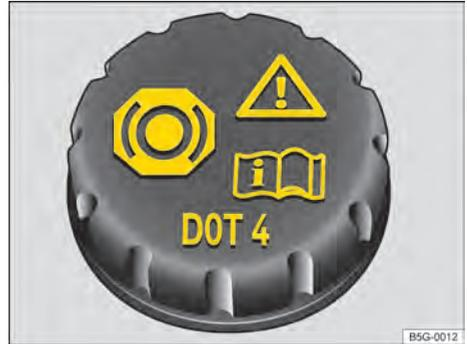
**Fig. 160** No compartimento do motor: tampa do reservatório de fluido de freio.
