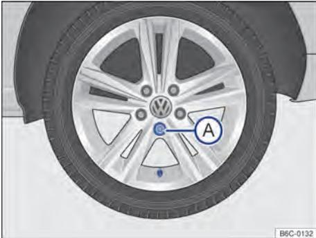
Fig. 173 Troca de roda: seqüência de remoção dos parafusos da roda.
