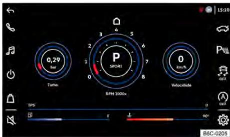
Fig. 17 No display do rádio: monitor de dados do veículo.
