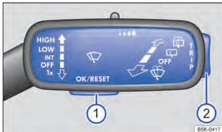
Veículos sem volante multifunções: botão 1 na alavanca dos limpadores dos vidros para confirmação dos itens de menu e chave 2 para alternar entre os menus.
