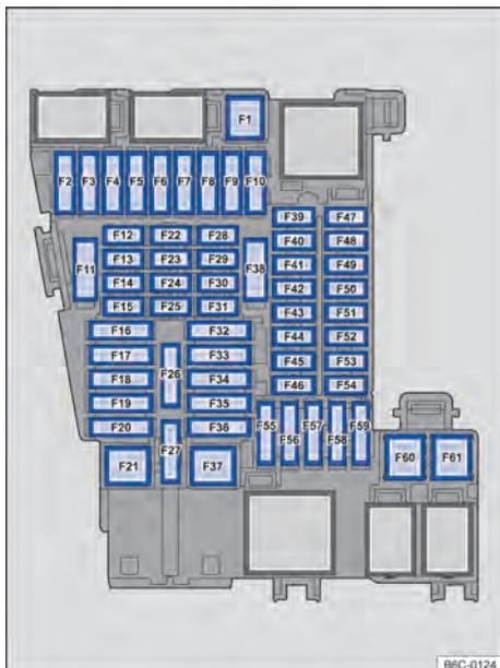
**Fig. 146** No painel de instrumentos: disposição dos fusíveis.
