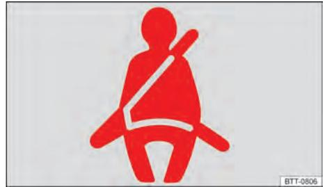
Fig. 23 Luz de advertência no display do instrumento combinado.
