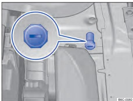
**Fig. 150** No compartimento do motor: ponto de auxílio à partida (ponto de aterramento).
