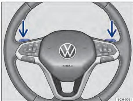
**Fig. 95** Volante com seletores basculantes do Tiptronic.
