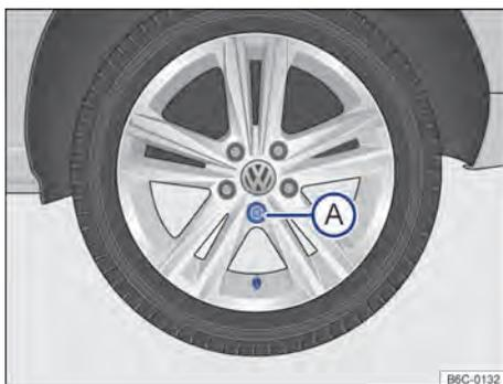
**Fig. 172** Retirar a calota integral.
