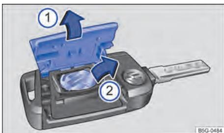
Fig. 51 Chave do veículo: substituir a bateria.
