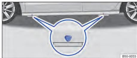
**Fig. 170** Pontos de apoio do macaco.
