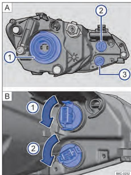
**Fig. 137** No compartimento do motor: farol dianteiro. **1** Luz de rodagem diurna e luz de posição e **2** Indicadora de direção.
