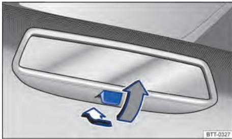
**Fig. 79** No para-brisa: espelho retrovisor interno com antiofuscante manual.
