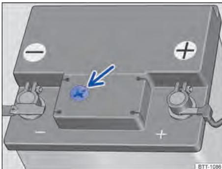
**Fig. 161** No compartimento do motor: exemplo de posição do visor no lado superior da bateria do veículo.
