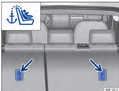
**Fig. 44** Olhais de retenção para o cinto de fixação superior no lado de trás do banco traseiro.
