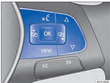
Fig. 19 Lado direito do volante multifunções (variante 1): botões para comando dos menus e exibições de informação do instrumento combinado.
