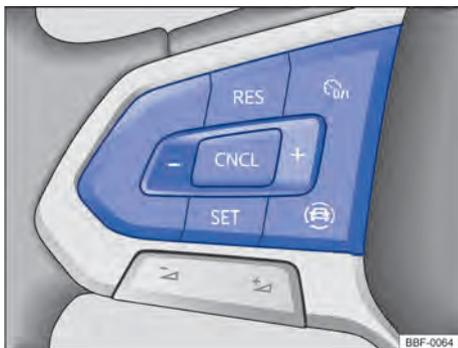
**Fig. 97** Lado esquerdo do volante multifunções: botões para comandar o GRA.
