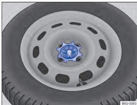
Fig. 166 No compartimento de bagagem: manipulador para fixação da roda de emergência.
