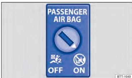
**Fig. 38** No painel de instrumentos no lado do passageiro dianteiro: interruptor acionado pela chave para desligar e ligar o airbag frontal do passageiro dianteiro.
