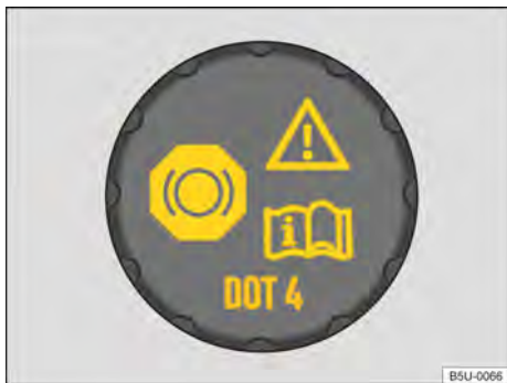
Fig. 206 No compartimento do motor: tampa do reservatório de fluido de freio.
