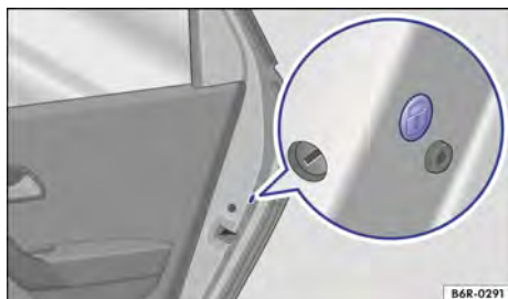
Fig. 46 Na parte dianteira da porta direita: travamento de emergência, coberto por uma vedação de borracha.
