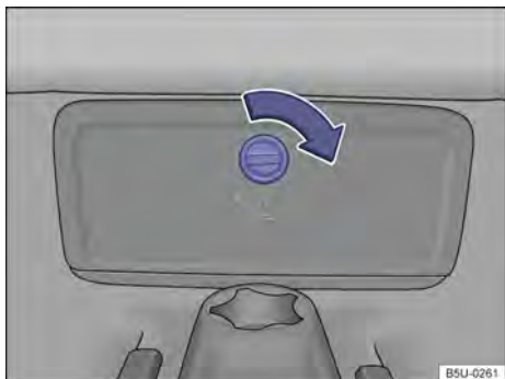
Fig. 174 No assento do banco traseiro: acesso à caixa de fixação das ferramentas de bordo.
