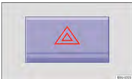
Fig. 38 Na parte superior do console central: interruptor das luzes de advertência.
