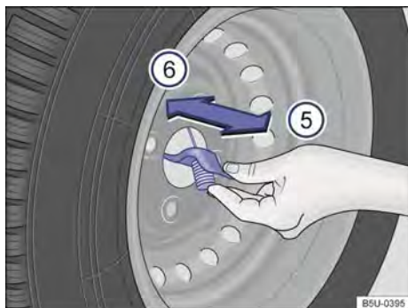
Fig. 214 Na roda de emergência: remover o cabo da roda de emergência.
