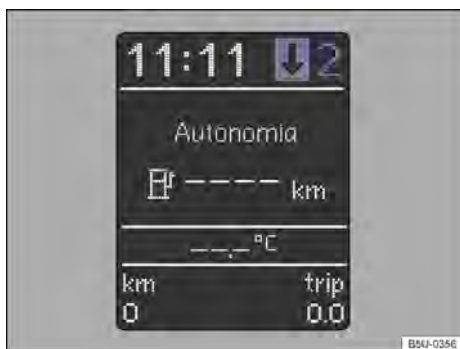
Fig. 84 No instrumento combinado: indicador de troca de marcha (variante 2).
