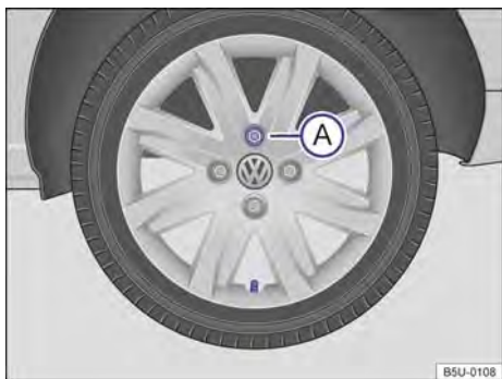
Fig. 221 Troca de roda: seqüência de remoção dos parafusos da roda.
