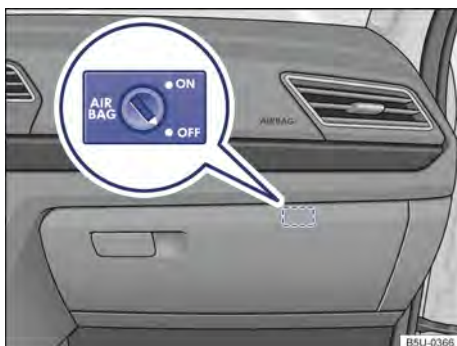
Fig. 36 No porta-luvas: interruptor desacionado pela chave para desligar e ligar o airbag frontal do passageiro.
