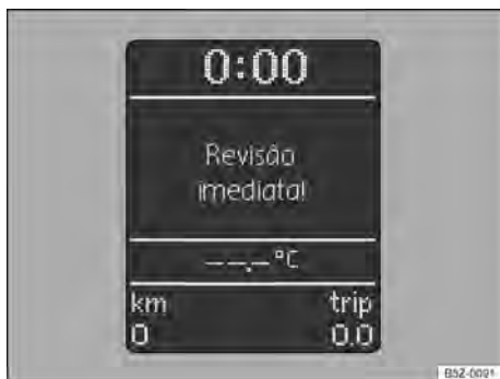
Fig. 17 Display do instrumento combinado: indicador do intervalo de serviço.
