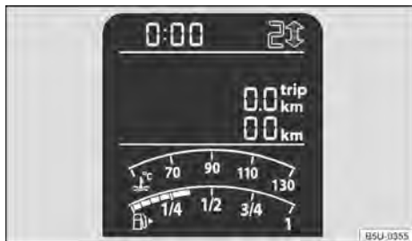
Fig. 83 No instrumento combinado: indicador de troca de marcha (variante 1).
