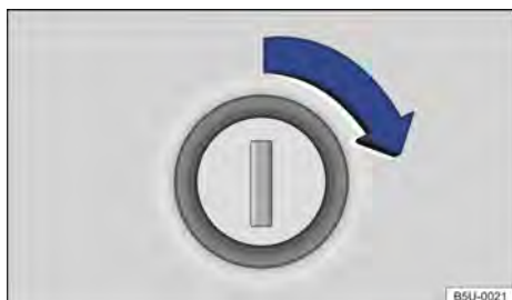
Fig. 50 Cilindro da fechadura para trancar e destrancar a tampa do compartimento de carga.
