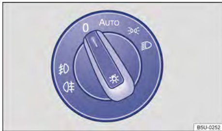
Fig. 67 No painel: interruptor das luzes.
