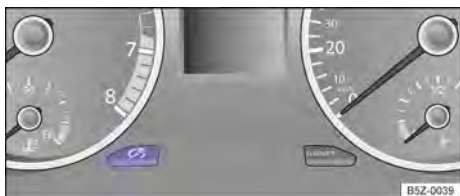
Fig. 69 No instrumento combinado: tecla de regulação da iluminação dos instrumentos e dos interruptores.
