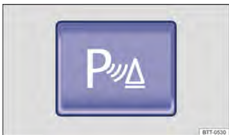
Fig. 94 Na parte superior do console central: botão para ligar e desligar o controle de distância de estacionamento (Park Pilot).
