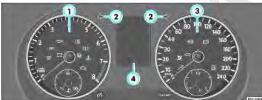
**Fig. 35** Instrumento combinado com luzez indicadoras. Algumas das luzez indicadoras aqui apresentadas estão disponíveis para determinados modelos ou são equipamentos opcionais
