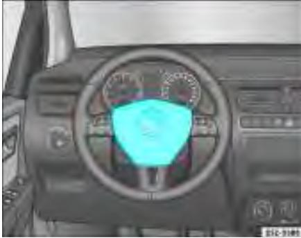
**Fig. 21** Localização do airbag do condutor: no volante
