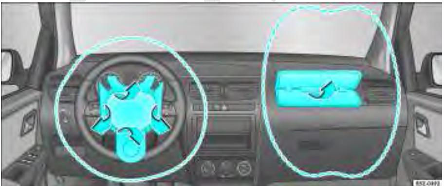
**Fig. 25** Raio de ação e coberturas dos airbags em caso de acionamento
