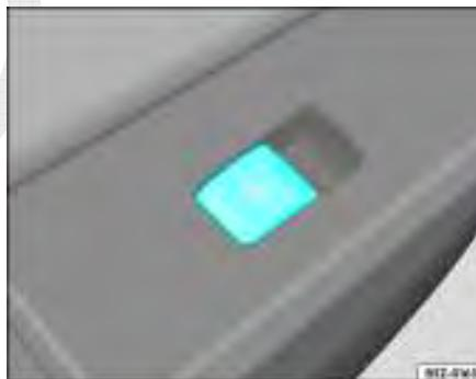
Fig. 66 Tecla de comando do vidro nas portas traseiras e na porta do condutor
