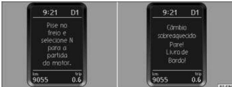
Fig. 128 Textos de alerta no display do instrumento combinado
