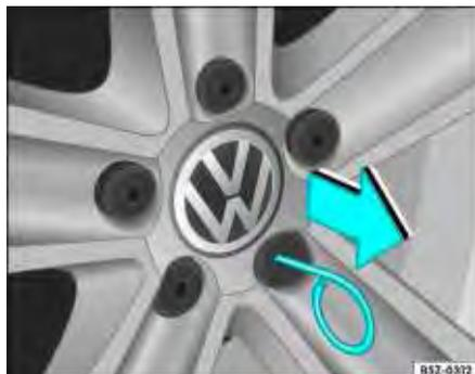
Fig. 162 Retirar os protetores dos parafusos
