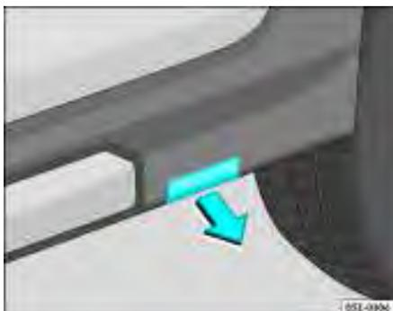
Fig. 165 Pontos de recepção do macaco
