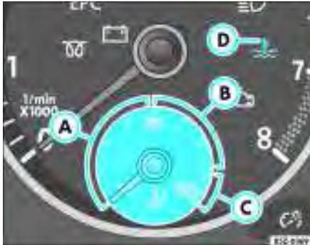
Fig. 37 Indicador da temperatura do líquido de arrefecimento
