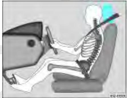
Fig. 82 Vista lateral: apoio para cabeça corretamente ajustado e o cadelço do cinto corretamente colocado
