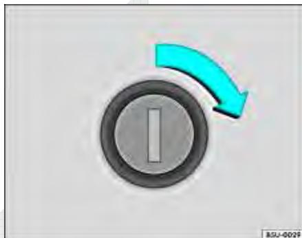
Fig. 62 Tampa do compartimento de bagagem: abertura
