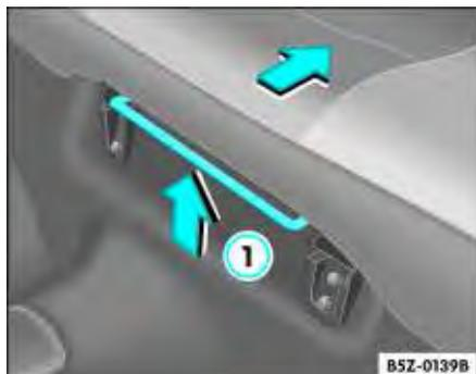
Fig. 93 Alavanca para regulagem longitudinal
