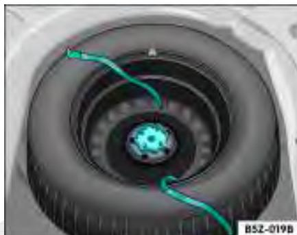
Fig. 158 Manípulo de fixação da roda de emergência
