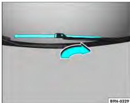
Fig. 143 Levantamento do braço do limpador do para-brisa
