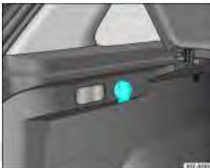
Fig. 104 Tomada 12 V no compartimento de bagagem
