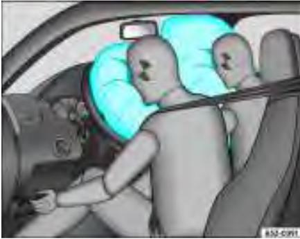
**Fig. 24** Ilustração do funcionamento: airbags insuflados
