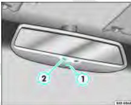
Fig. 79 Detalhe do interruptor do espelho com antiofuscante automático
