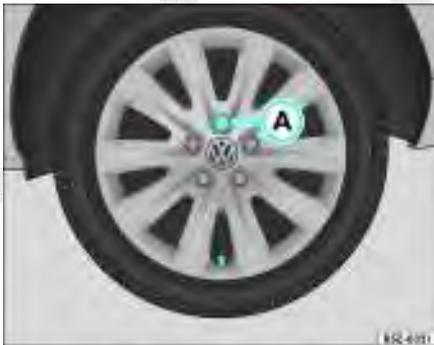
**Fig. 167** Sequência de remoção dos parafusos da roda
