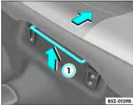
Fig. 86 Alavanca para regulagem longitudinal
