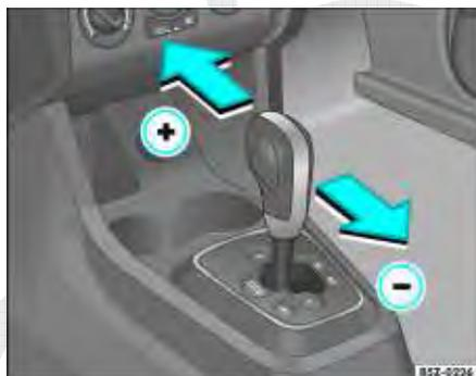
Fig. 126 Alavanca seletora de marchas da transmissão automatizada
