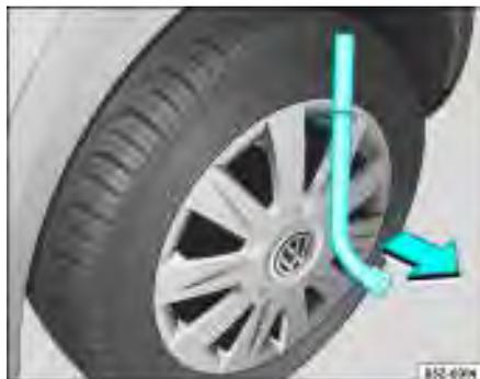
Fig. 159 Remover a supercalota
