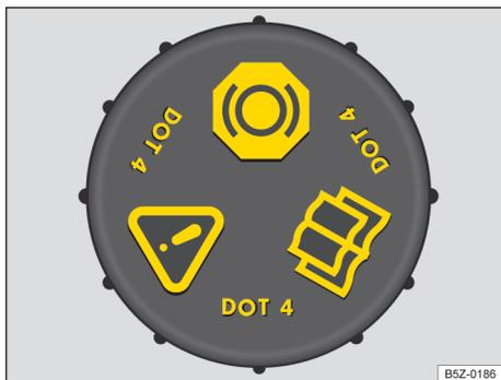
**Fig. 159** No compartimento do motor: tampa do reservatório de fluido de freio (variante 2).
