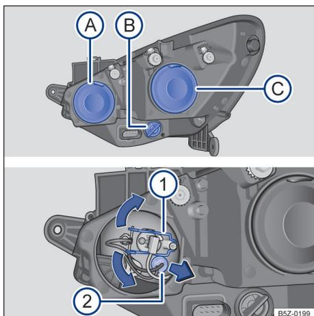
**Fig. 131** No compartimento do motor: vista traseira do farol dianteiro direito com cobertura de borracha (esquerda): **A** farol alto e luz de posição, **B** indicadores de direção e **C** farol baixo. Vista traseira do farol dianteiro direito sem cobertura de borracha (direita): **1** farol alto, **2** luz de posição.
