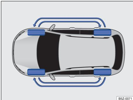
**Fig. 163** Esquema para a troca das rodas.
