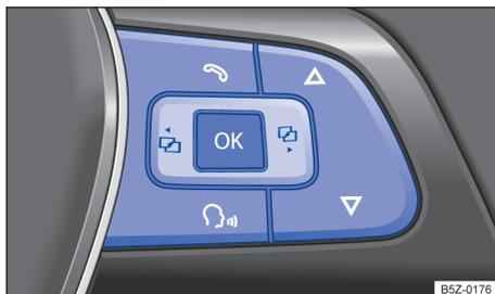
**Fig. 18** Lado direito do volante multifunções: botões de comando dos menus do instrumento combinado.
