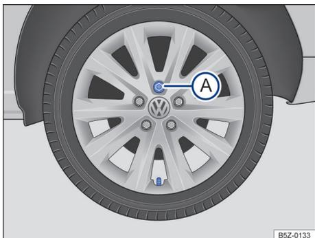
Fig. 169 Retirar a calota integral.
