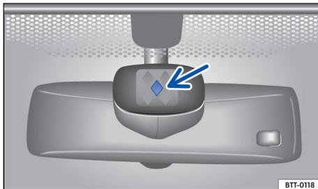
**Fig. 77** No para-brisa: superfície sensível do sensor de chuva.
