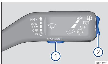
**Fig. 17** Veículos sem volante multifunções: botão **1** na alavanca dos limpadores dos vidros para confirmação dos itens de menu e chave **2** para alternar entre os menus.
