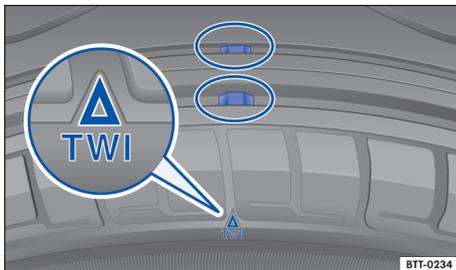
Fig. 165 Perfil do pneu: indicadores de desgaste.
