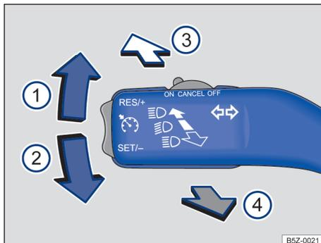
Fig. 73 Alavanca dos indicadores de direção e do farol alto na posição básica.
