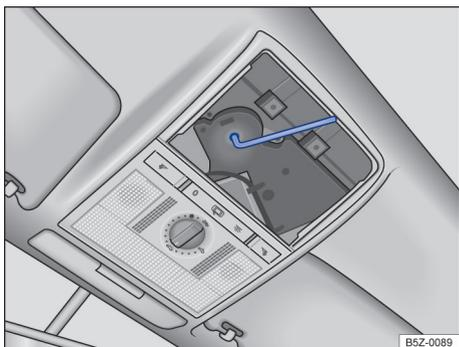
**Fig. 60** Parafuso sextavado para fechamento do teto solar.
