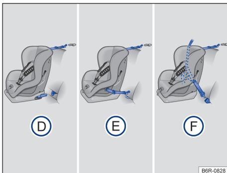
**Fig. 36** No banco traseiro: as figuras (D) e (E) mostram o princípio da fixação do sistema de retenção para crianças nos olhais de retenção inferiores e com o cinto de fixação superior. A figura (F) mostra a fixação do sistema de retenção para crianças com o cinto de segurança do veículo e com o cinto de fixação superior.
