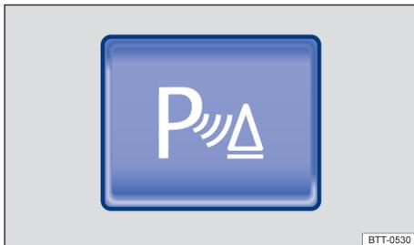
**Fig. 105** Na parte superior do console central: botão para ligar e desligar o controle de distância de estacionamento (Park Pilot).
