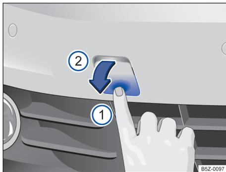
Fig. 148 No para-choque dianteiro à direita: soltar e remover a cobertura. ▶
