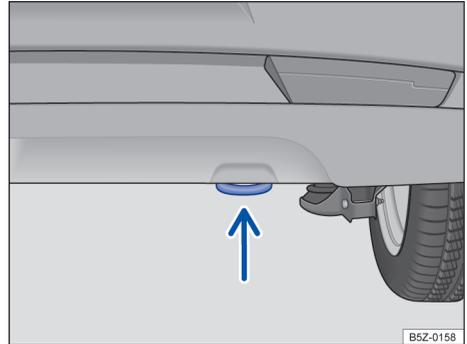
**Fig. 150** No para-choque traseiro à direita: argola de reboque.
