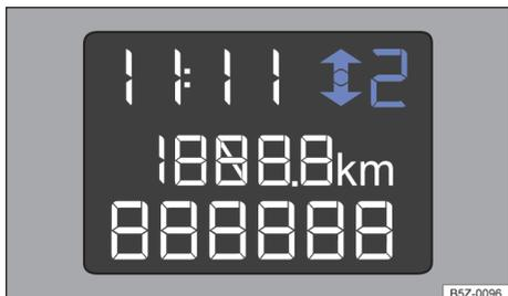
Fig. 91 No instrumento combinado: indicador de troca de marcha (variante 2).
