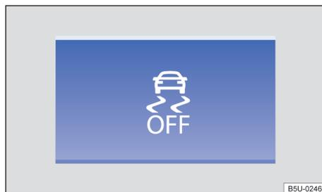
**Fig. 108** No console central: botão para desligar e ligar ASR manualmente.
