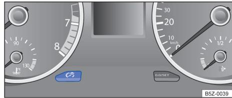
**Fig. 74** No instrumento combinado: botão de regulação da iluminação dos instrumentos e dos interruptores.
