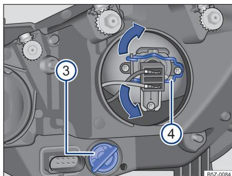
**Fig. 132** No compartimento do motor: vista traseira do farol dianteiro direito sem cobertura de borracha: **3** indicadores de direção e **4** farol baixo.
