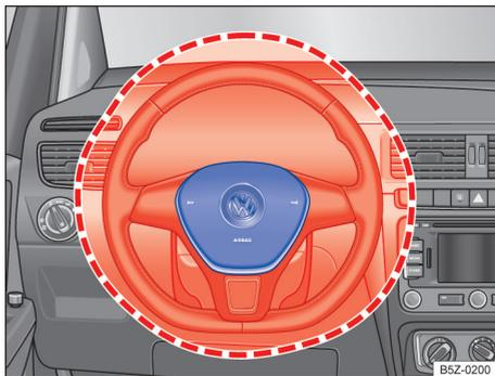
**Fig. 33** Local de instalação e área de expansão do airbag frontal do condutor.
