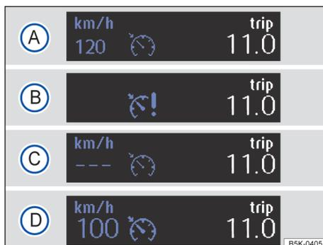
Fig. 102 No display do instrumento combinado: indicadores de status do GRA.
