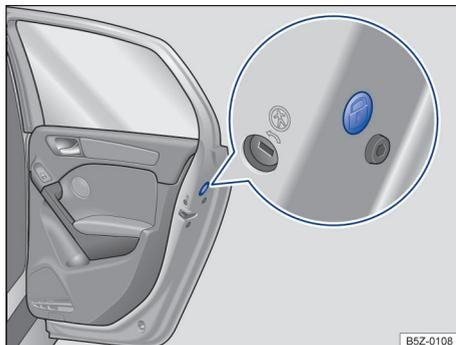
Fig. 53 Na porta traseira: travamento de emergência, coberto por uma vedação de borracha.
