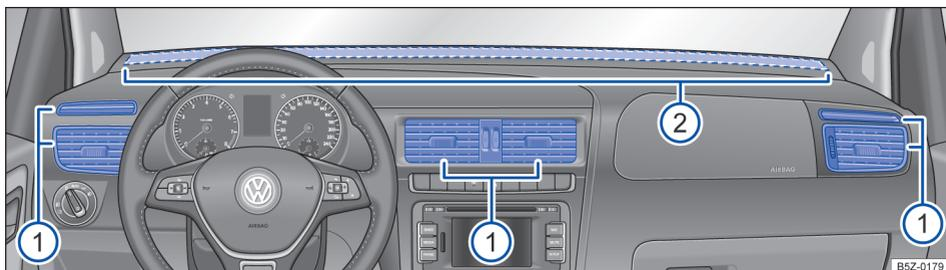
Fig. 86 No painel de instrumentos: difusores de ar.
