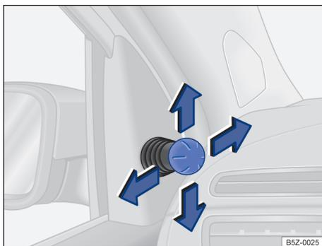
**Fig. 80** Nas portas dianteiras: botão de ajuste dos espelhos retrovisores externos mecânicos.
