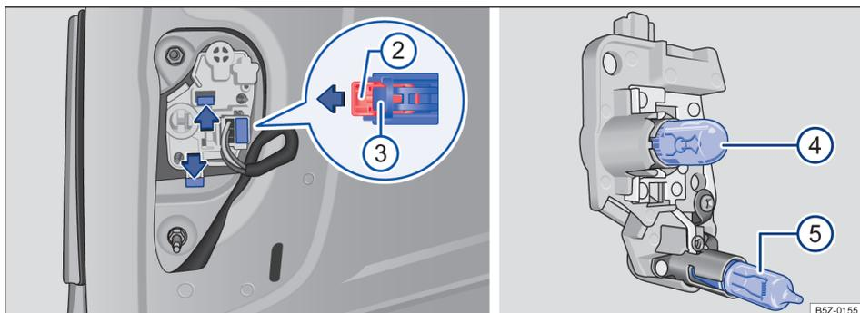
**Fig. 137** Na tampa traseira: suporte das lâmpadas e lâmpadas da lanterna esquerda - para veículos com lanterna de neblina.
