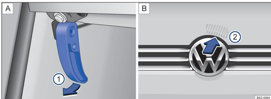
**Fig. 151** A: alavanca de destravamento na área para os pés do lado do condutor ①. B: alavanca de destravamento na parte interna da tampa do compartimento do motor ②.
