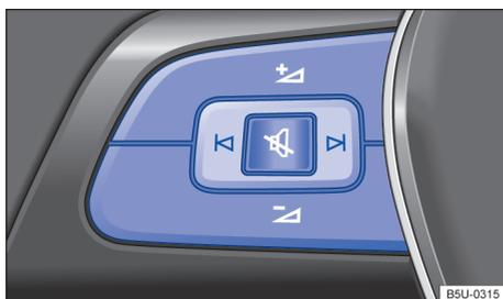
**Fig. 61** Lado esquerdo do volante multifunções: botões de comando.
