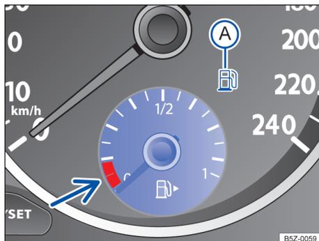
Fig. 13 No instrumento combinado: indicador do nível de combustível.
