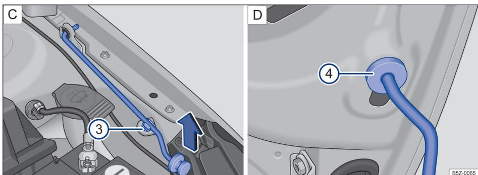
**Fig. 152** C: haste de sustentação da tampa do compartimento do motor ③. D: tampa do motor protegida com a haste de sustentação da tampa ④.
