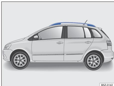
Fig. 122 Suportes longitudinais do bagageiro do teto (ambos os lados).
