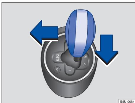
**Fig. 97** Alavanca seletora da transmissão automatizada ASG.
