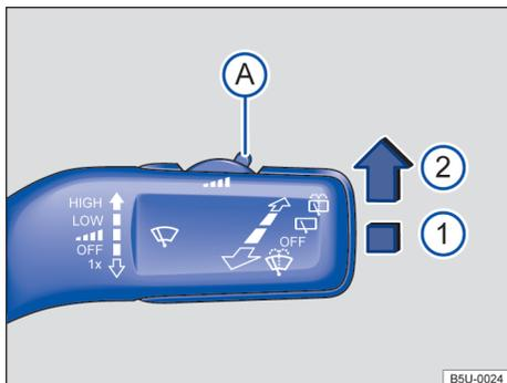
**Fig. 76** Ao lado do volante: alavanca dos limpadores dos vidros: regular a sensibilidade do sensor de chuva (A).
