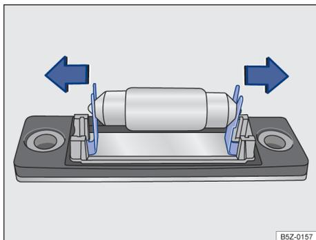
Fig. 139 Lanterna da placa de licença: remover a lâmpada.
