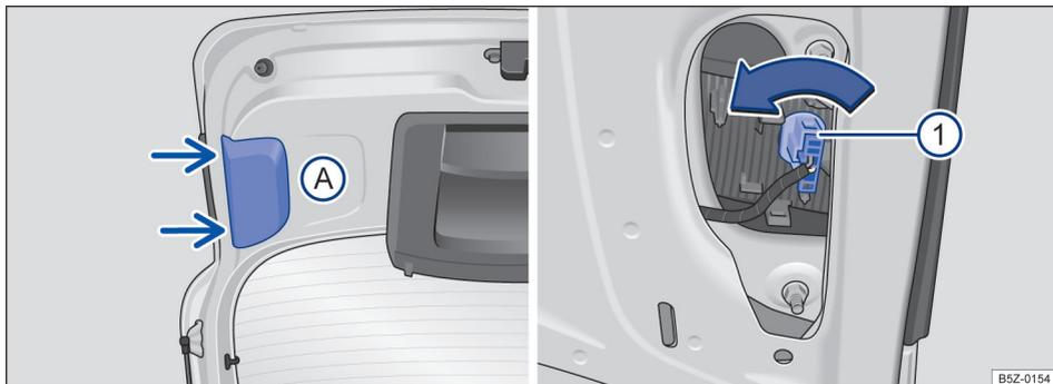
**Fig. 136** Na tampa traseira: remover a cobertura e lâmpada da lanterna direita e/ou da lanterna esquerda - para veículos sem lanterna de neblina.
