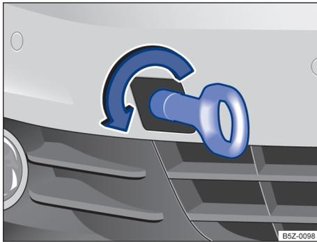
**Fig. 149** No para-choque dianteiro à direita: rosquear a argola de reboque.
