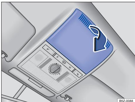
**Fig. 59** No revestimento do teto: remover a cobertura.
