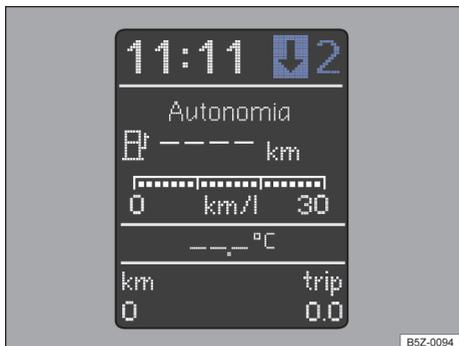
Fig. 90 No instrumento combinado: indicador de troca de marcha (variante 1).
