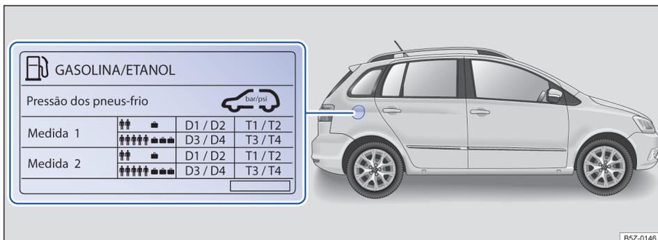
**Fig. 164** Na parte interna da portinhola do tanque de combustível: etiqueta com a pressão dos pneus.
