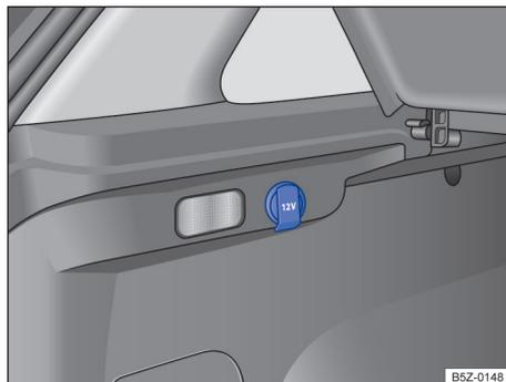
Fig. 120 No compartimento de bagagem: tomada 12 V.
