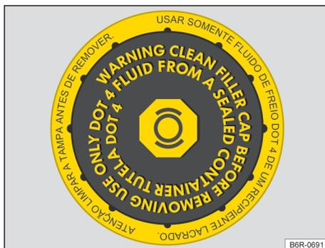
**Fig. 158** No compartimento do motor: tampa do reservatório de fluido de freio (variante 1).
