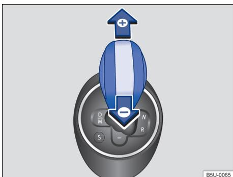
**Fig. 98** Alavanca seletora na posição para condução de marcha no modo manual.
