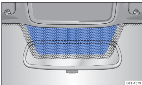
Fig. 83 Para-brisa reticulada com janela de comunicação (superfície azul).
