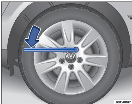
Fig. 170 Troca de roda: soltar os parafusos da roda.
