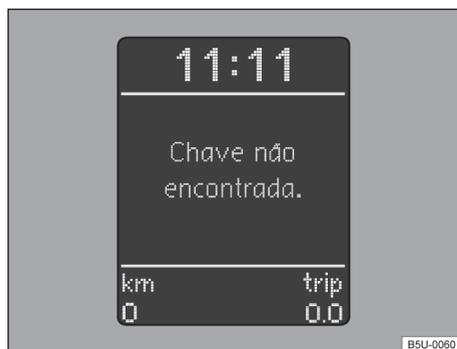
**Fig. 94** No instrumento combinado: display com indicação do imobilizador ativado - veículos com Sistema de Informações Volkswagen.
