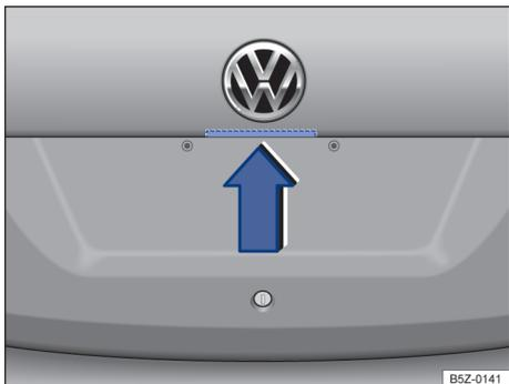
Fig. 56 No rebaixo acima da placa de licença: botão de abertura da tampa traseira.
