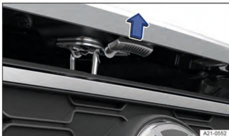
Fig. 150 Acima da grade do radiador: alavanca de comando da tampa dianteira (representação esquemática).
