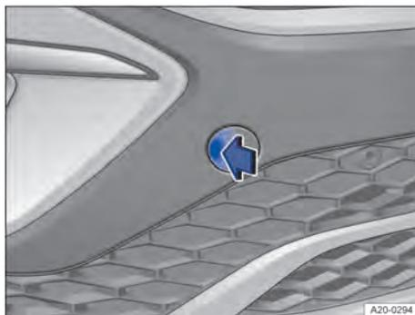
Fig. 145 No para-choque dianteiro à direita: retirar cobertura.
