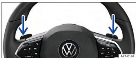
Fig. 92 Volante com seletores basculantes do Tiptronic.
