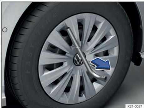
Fig. 169 Retirar a calota integral.
