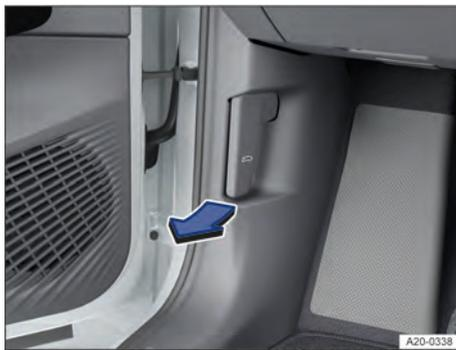
Fig. 149 Na área para os pés do lado do condutor: alavanca de destravamento da tampa dianteira (representação esquemática).
