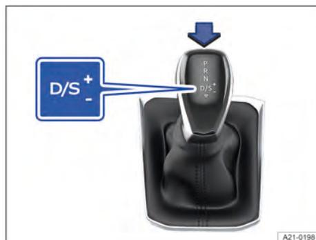
**Fig. 90** Alavanca seletora da transmissão automática com botão bloqueador (seta).
