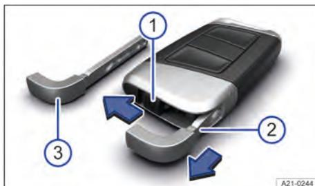
Fig. 40 Chave do veículo: destravamento da chave de emergência (representação esquemática).
