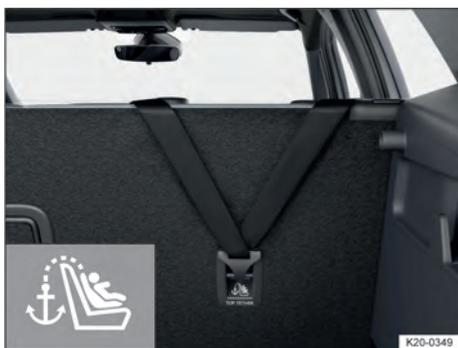
**Fig. 37** No compartimento de bagagem: cinto de fixação superior pendurado.
