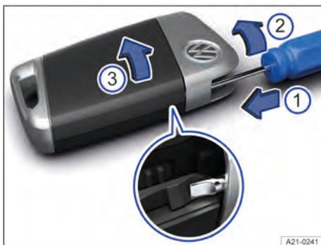
Fig. 42 Chave do veículo: abrir a tampa do compartimento da bateria.
