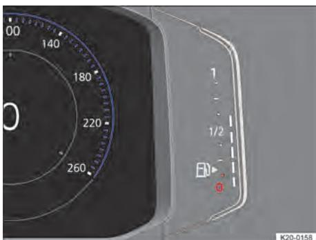
Fig. 13 Indicador do nível de combustível no instrumento combinado digital versão Pro (representação esquemática).
