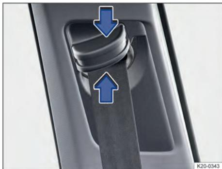
**Fig. 25** Ao lado dos bancos dianteiros: regulagem de altura do cinto de segurança.
