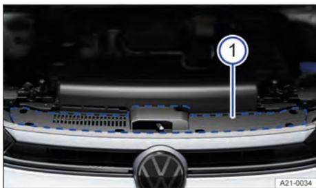
**Fig. 155** No compartimento do motor: etiqueta adesiva ao lado do destravamento da tampa traseira (representação esquemática).
