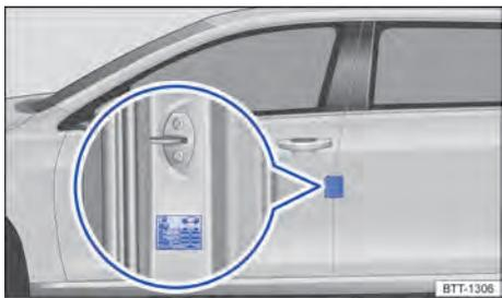
Fig. 165 Na coluna do condutor: etiqueta com as pressões dos pneus (alternativa ao lado interno da portinhola do tanque).
