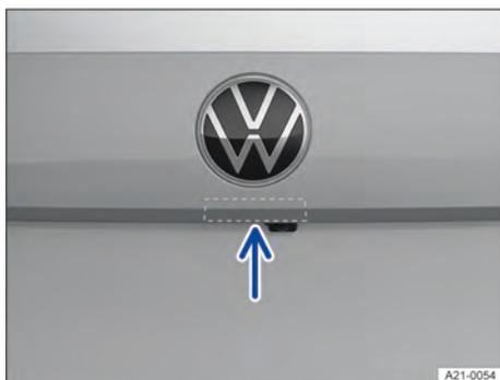
Fig. 51 Na tampa traseira: botão para abrir a tampa traseira (representação esquemática).
