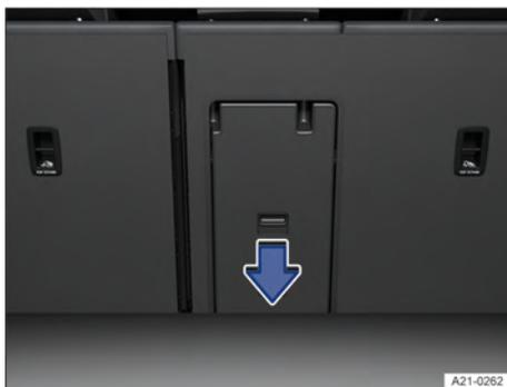
**Fig. 124** Dispositivo para transporte de objetos longos no compartimento de bagagem.
