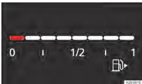
Fig. 14 Indicador do nível de combustível no instrumento combinado digital versão Basic (representação esquemática).
