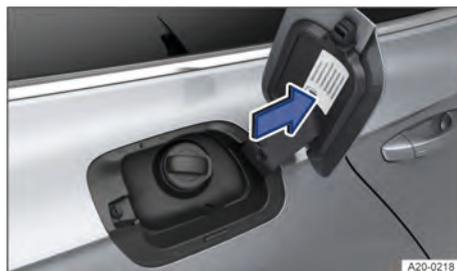
**Fig. 128** No lado interno da portinhola do tanque: placa de indicação de combustível (representação esquemática).
