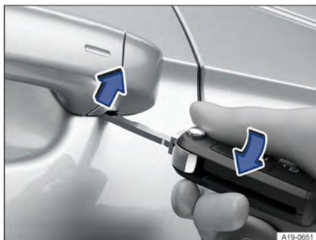
**Fig. 47** Maçaneta da porta do condutor: alavancar a capa de cobertura para fora.
