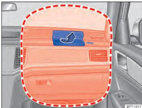
Fig. 29 Local de instalação e área de expansão do airbag frontal do passageiro dianteiro.
