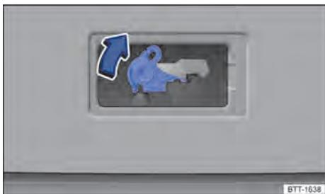
**Fig. 54** No compartimento de bagagem: destravamento de emergência para a tampa traseira.
