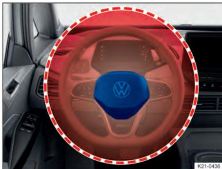
Fig. 28 Local de instalação e área de expansão do airbag frontal do condutor.
