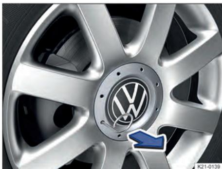
Fig. 168 Retirar a calota central.
