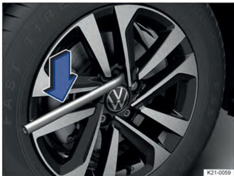
Fig. 171 Troca de roda: afrouxar os parafusos de roda.
