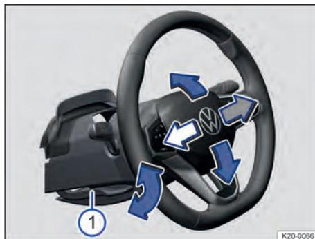
**Fig. 57** Embaixo do volante no revestimento da coluna de direção: alavanca de ajuste mecânico da posição do volante (representação esquemática).
