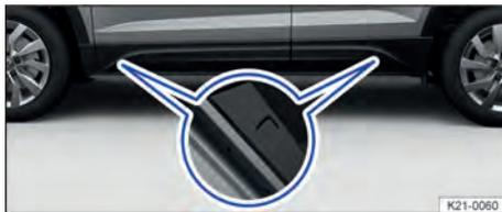
Fig. 176 Pontos de apoio do macaco.
