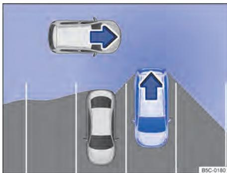
Fig. 113 Representação esquemática do assistente de saída de vaga: área monitorada ao redor do veículo.
