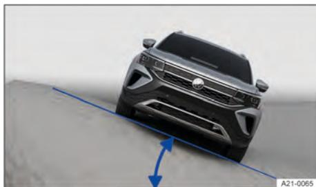
Fig. 97 Representação esquemática: ângulo de inclinação lateral.
