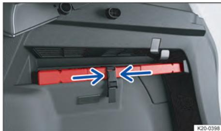
**Fig. 38** No compartimento de bagagem do lado direito: suporte do triângulo de segurança.
