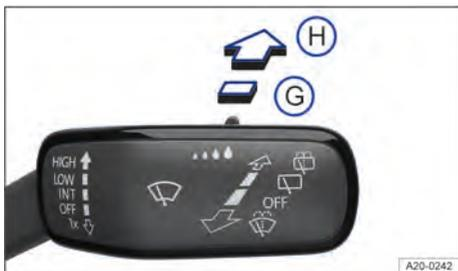
Fig. 75 À direita da coluna de direção: comandar o limpador do vidro traseiro.
