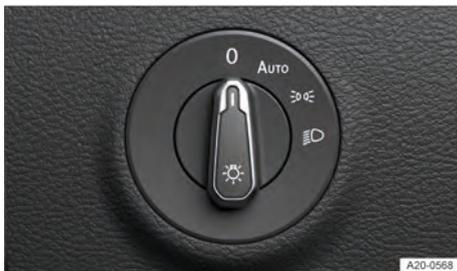
Fig. 71 Ao lado do volante: interruptor das luzes.
