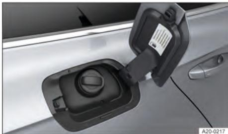
Fig. 145 Atrás da portinhola do tanque: tampa do tanque (representação esquemática).
