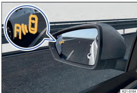
**Fig. 118** Nos espelhos retrovisores externos: indicação do sensor de ponto cego.
