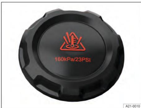
Fig. 173 No compartimento do motor: tampa do reservatório de expansão do líquido de arrefecimento (representação esquemática).
