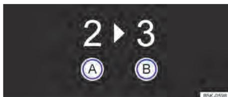
Fig. 90 No display do instrumento combinado: recomendação de marcha.
