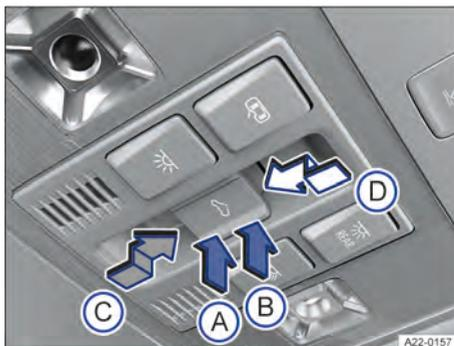
Fig. 60 No revestimento do teto: botão do teto de vidro.
