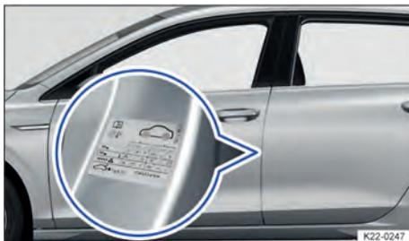
Fig. 178 Na coluna do condutor: etiqueta com as pressões dos pneus (alternativa ao lado interno da portinhola do tanque).
