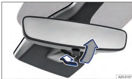
Fig. 82 No para-brisa: espelho retrovisor interno com antiofuscante manual.
