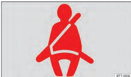
Fig. 22 No display do instrumento combinado: luz de advertência.
