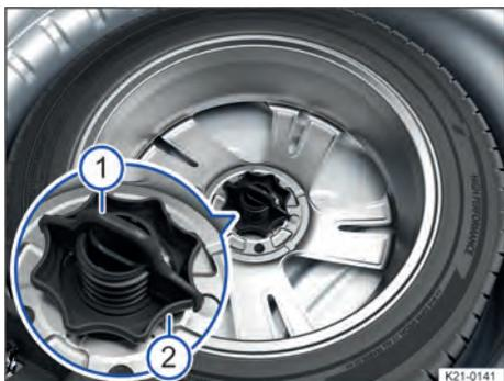
Fig. 188 No compartimento de bagagem: manipulô para fixaçã da roda sobressalente.
