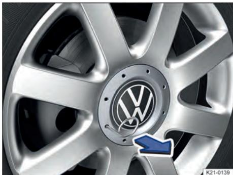
**Fig. 181** Retirar a calota central.
