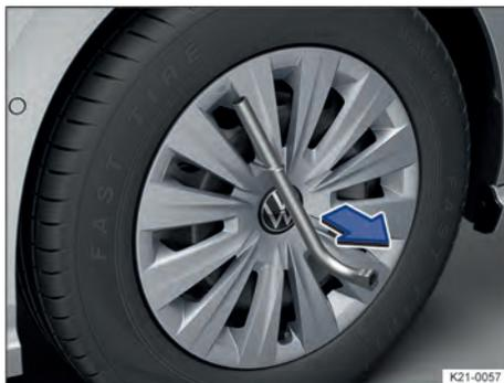
**Fig. 182** Retirar a calota integral.
