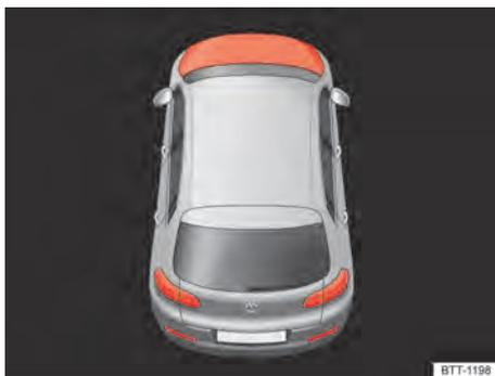
**Fig. 167** No display do instrumento combinado: tampa dianteira aberta ou não fechada corretamente (representação esquemática).
