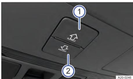
**Fig. 85** No revestimento do teto: botões de comando da cortina de proteção solar.
