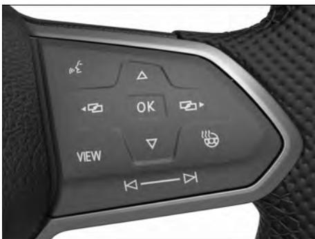
**Fig. 14** Lado direito do volante multifunções: operar o instrumento combinado digital Basic (variante 2).
