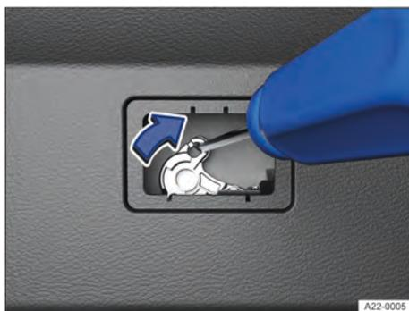
Fig. 58 No compartimento de bagagem: destravamento de emergência para a tampa traseira.
