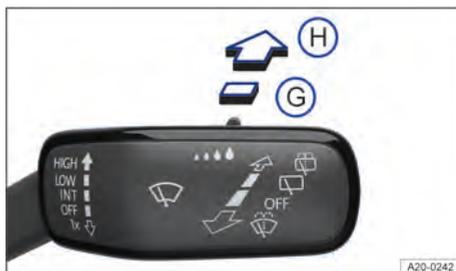
Fig. 79 À direita da coluna de direção: comandar o limpador do vidro traseiro.
