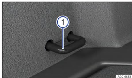
Fig. 135 No compartimento de bagagem: olhal de amarração (representação esquemática).
