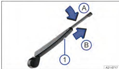
**Fig. 149** Trocar a palheta dos limpadores do vidro traseiro.
