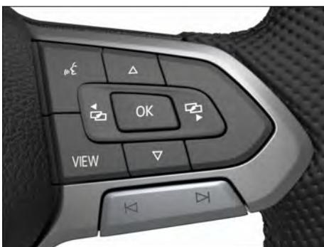
**Fig. 13** Lado direito do volante multifunções: operar o instrumento combinado digital Basic (variante 1).
