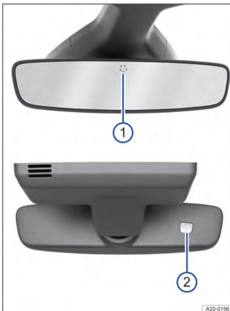
Fig. 81 No para-brisa: espelho retrovisor interno com antiofuscante automático.
