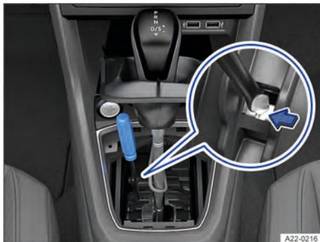
Fig. 98 Destravar emergencialmente o bloqueio da alavanca seletora (variante 1).
