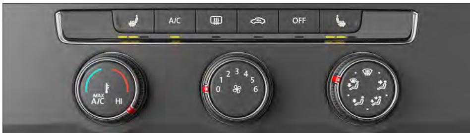
**Fig. 88** Na parte superior do console central: painel de comando do ar-condicionado manual.
