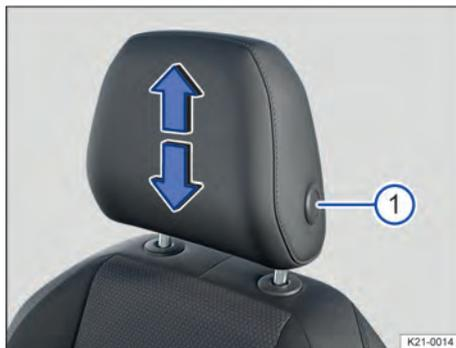
Fig. 67 Representação esquemática: ajustar o apoio para cabeça dianteiro.
