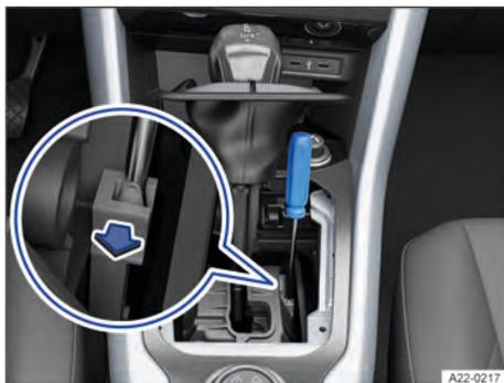
Fig. 99 Destravar emergencialmente o bloqueio da alavanca seletora (variante 2).
