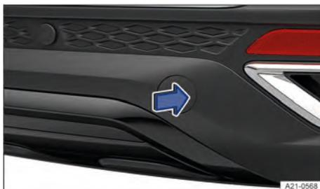
**Fig. 161** No para-choque traseiro à direita: remover cobertura.
