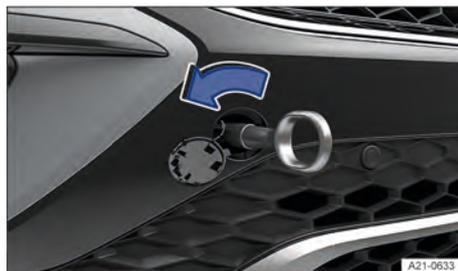
Fig. 160 No para-choque dianteiro à direita: rosquear a argola de reboque.
