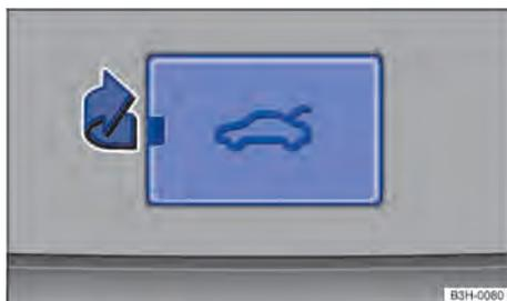
Fig. 57 Na tampa traseira: cobertura do destravamento de emergência da tampa traseira.
