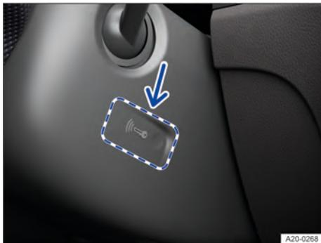
**Fig. 93** À direita da coluna de direção: função de partida de emergência.
