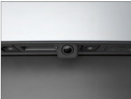
**Fig. 196** Na traseira do veículo: câmera de marcha a ré no botão da alça (representação esquemática).
