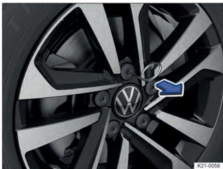
**Fig. 183** Remover as capas de cobertura dos parafusos de roda.
