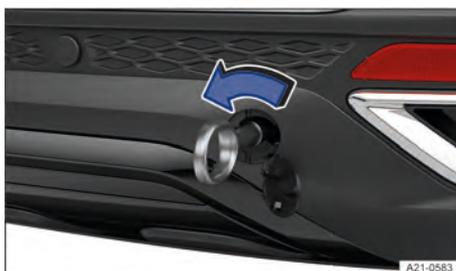
**Fig. 162** No para-choque traseiro à direita: rosquear a argola de reboque.
