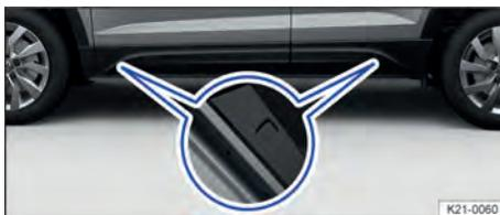
Fig. 189 Pontos de apoio do macaco.
