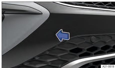
Fig. 159 No para-choque dianteiro à direita: retirar cobertura.
