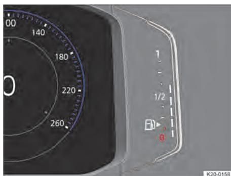
**Fig. 15** Indicador do nível de combustível no instrumento combinado digital Pro (representação esquemática).
