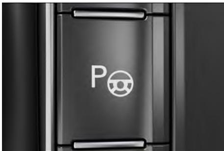
**Fig. 123** No console central: botão do assistente de direção para estacionamento (conforme a versão).
