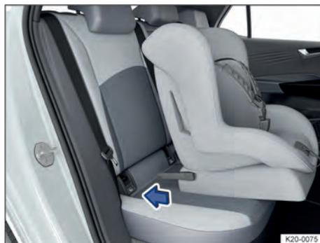
**Fig. 39** Representação esquemática: instalar a cadeira de criança com braços de apoio.
