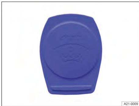
**Fig. 168** No compartimento do motor: tampa do reservatório de água dos lavadores dos vidros (representação esquemática).
