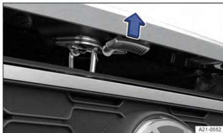
**Fig. 164** Acima da grade do radiador: alavanca de comando da tampa dianteira (representação esquemática).
