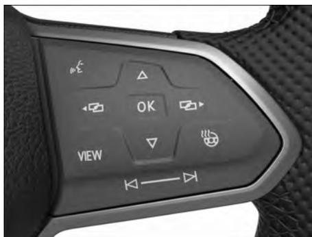
**Fig. 11** Lado direito do volante multifunções: operar o instrumento combinado digital Pro (variante 2).
