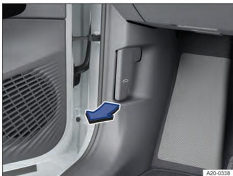
**Fig. 163** Na área para os pés no lado do condutor: alavanca de destravamento da tampa dianteira (representação esquemática).
