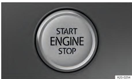
**Fig. 92** Na parte inferior do console central: botão de partida para dar partida no motor.
