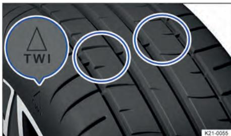
Fig. 180 Perfil do pneu: indicador de desgaste.
