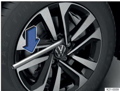
Fig. 184 Troca de roda: afrouxar os parafusos de roda.
