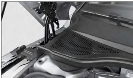
**Fig. 195** Entre o compartimento do motor e o para-brisa: caixa de água (representação esquemática).
