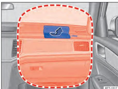
**Fig. 29** No lado do passageiro dianteiro: local de instalação e área de expansão do airbag frontal do passageiro dianteiro.
