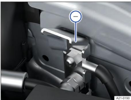
Fig. 157 No compartimento do motor: ponto de auxílio à partida de massa.
