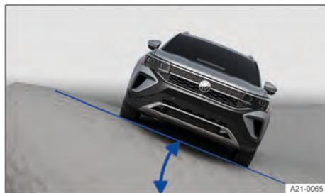
Fig. 102 Representação esquemática: ângulo de inclinação lateral.
