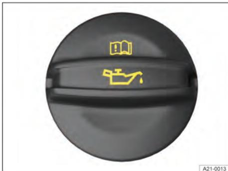
Fig. 171 No compartimento do motor: tampa da abertura para enchimento de óleo do motor (representação esquemática).
