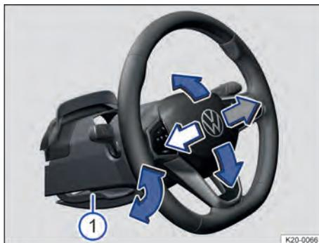
**Fig. 61** Embaixo do volante no revestimento da coluna de direção: alavanca de ajuste mecânico da posição do volante (representação esquemática).
