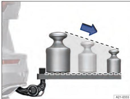
Fig. 140 Distribuição de peso recomendada no sistema de bagageiro traseiro
