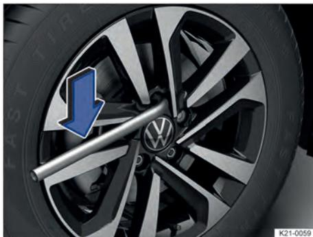
**Fig. 192** Troca de roda: desaparafusar os parafusos de roda com a chave de roda.
