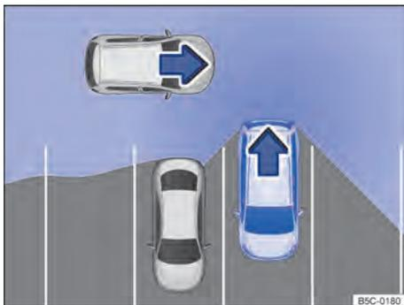
Fig. 127 Representação esquemática do assistente de saída de vaga: área monitorada ao redor do veículo.
