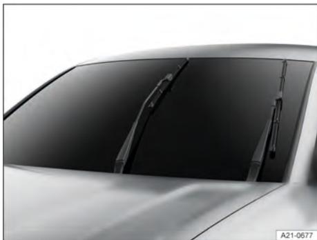
Fig. 147 Limpadores dos vidros na posição de serviço (representação esquemática).
