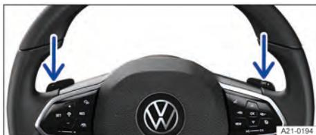
Fig. 97 Volante com seletores basculantes do Tiptronic.
