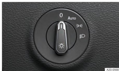
**Fig. 75** Ao lado do volante: interruptor das luzes.
