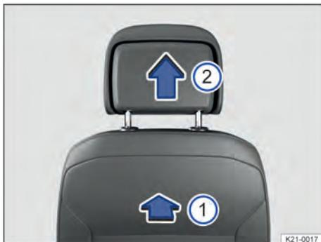
Fig. 69 Representação esquemática: remover o apoio para cabeça dianteiro.
