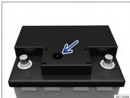
**Fig. 176** No lado superior da bateria do veículo 12 V: visor de inspeção da bateria (representação esquemática).
