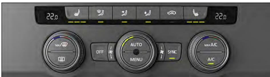
Fig. 87 Na parte superior do console central: painel de comando do ar-condicionado do Climatronic (variante 2).
