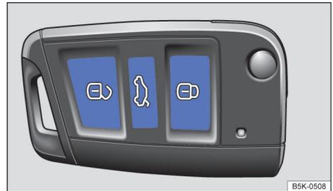
Fig. 53 Chave do veículo: travamento central.
