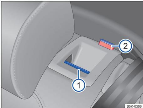
**Fig. 68** No encosto do banco traseiro: botão de destravamento ①, marcação vermelha ②.
