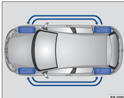
Fig. 158 Esquema para a troca das rodas.
