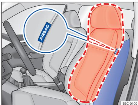
**Fig. 41** Lateralmente no banco dianteiro: localização de instalação e área de expansão dos airbags laterais.
