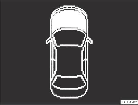
**Fig. 149** No display do instrumento combinado: tampa do compartimento do motor aberta ou fechada incorretamente (representação esquemática).
