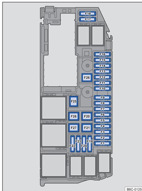
**Fig. 142** No compartimento do motor: disposição dos fusíveis.
