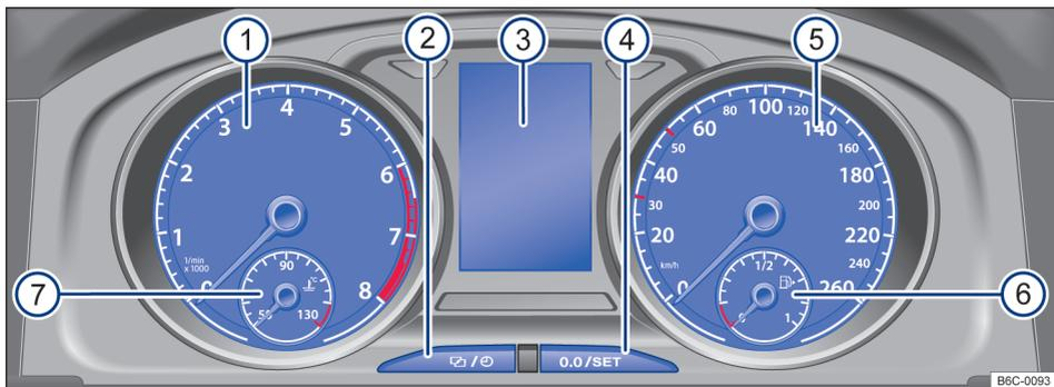
Fig. 10 Instrumento combinado no painel de instrumentos (variante 2).
