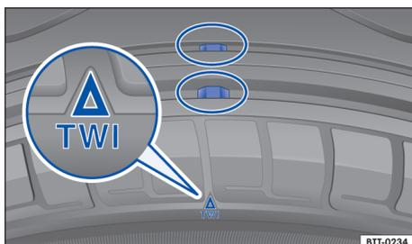
Fig. 161 Perfil do pneu: indicadores de desgaste.
