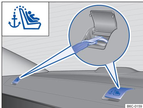
**Fig. 45** Olhais de retenção para o cinto de fixação superior na cobertura do compartimento de bagagem.
