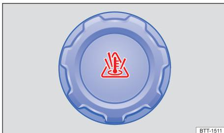
Fig. 154 No compartimento do motor: tampa do reservatório de expansão do líquido de arrefecimento do motor.
