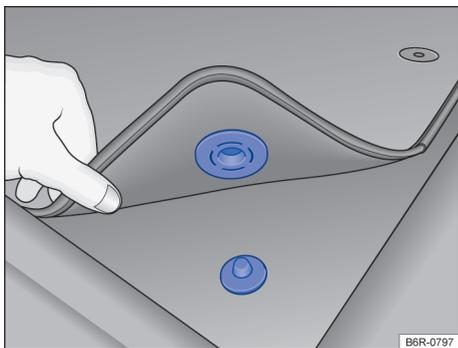
**Fig. 23** Tapete dianteiro do lado do condutor com fixação no pino do carpete.
