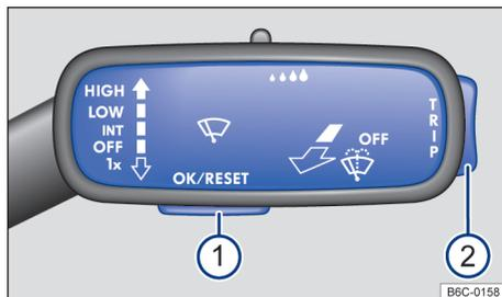
**Fig. 21** Veículos sem volante multifunções: botão **1** na alavanca dos limpadores do para-brisa para confirmação dos itens de menu e chave **2** para alternar entre os menus.
