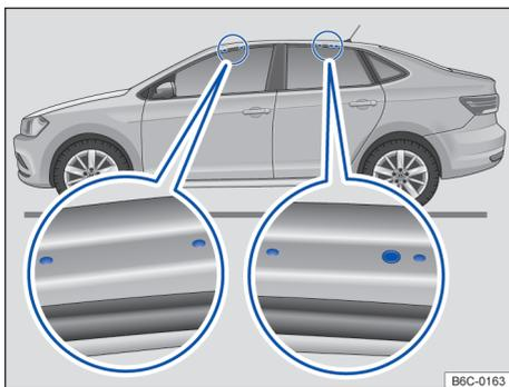
**Fig. 120** Pontos de fixação dos suportes de base do bagageiro do teto (ambos os lados).
