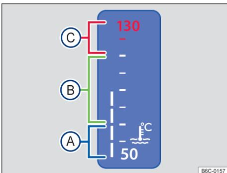
Fig. 18 Indicador de temperatura do líquido de arrefecimento do motor no instrumento combinado digital: (A) área fria; (B) área normal; (C) área de alerta.
