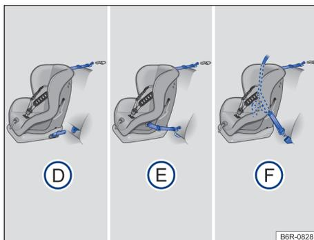
**Fig. 43** No banco traseiro: as figuras (D) e (E) mostram o princípio da fixação do sistema de retenção para crianças nos olhais de retenção inferiores e com o cinto de fixação superior. A figura (F) mostra a fixação do sistema de retenção para crianças com o cinto de segurança do veículo e com o cinto de fixação superior.
