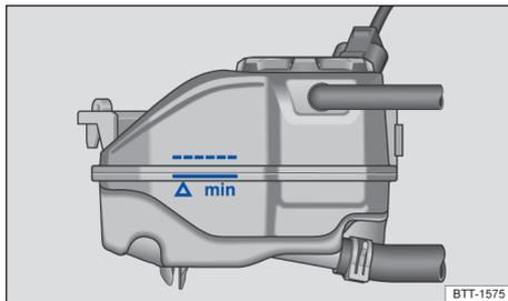
Fig. 153 No compartimento do motor: marcação no reservatório de expansão do líquido de arrefecimento do motor.
